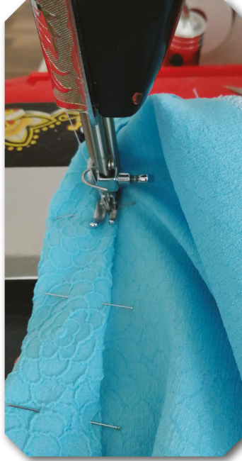
Görsel 3.94: Üst kenar payı makine dikişi
