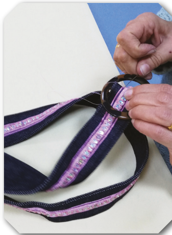
Görsel 2.45: Taşlı şeridin kemer tokasına elde dikişilmesi
