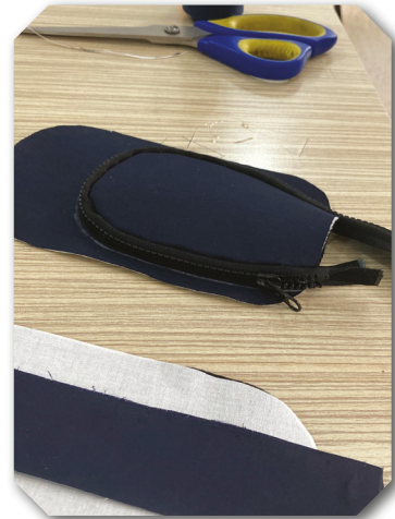
Görsel 3.53: Ön gövdeyle cebin birleştirilmesi
