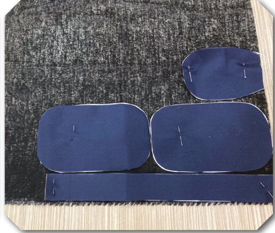
Görsel 3.49: Parçaları ipek telaya iğneleme
