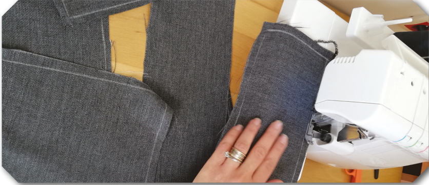
Görsel 2.26: Kesilen parçalara overlok çekme
