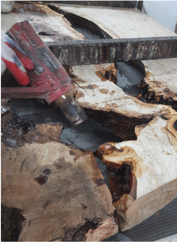
Görsel 5.22: Yüzeyde oluşan kabarcıkların giderilmesi
