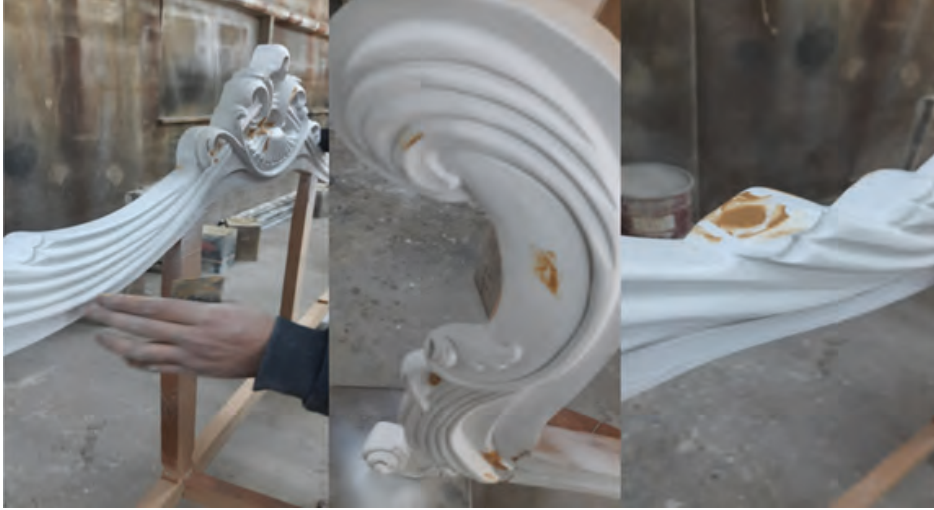
Görsel 4.58: Macun kontrolünün yapılması
