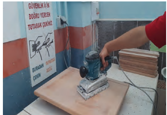
Görsel 2.21: Nemlendirme ile kabaran liflerin titreşim zımpara makinesi ile zımparalanması
