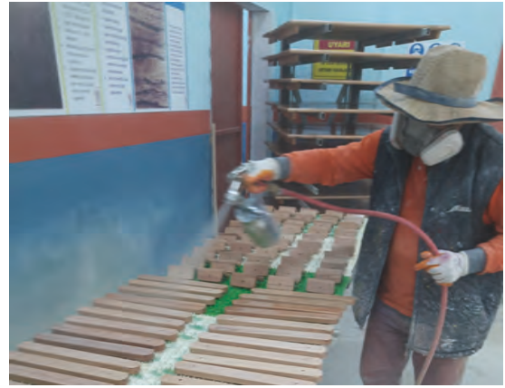
Görsel 5.3: Püskürtme tabancası ile vernik uygulama
