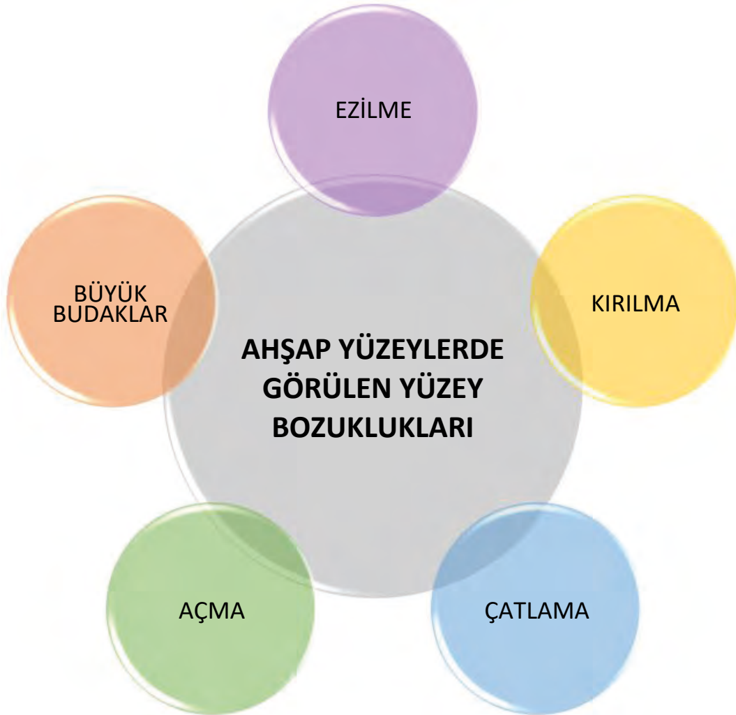
Şema 1.22: Ahşap yüzeylerde görülen yüzey bozuklukları
