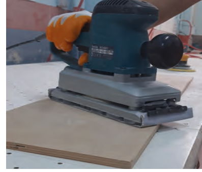
Görsel 2.4: Elektrikli titreşim zımpara makinesi
