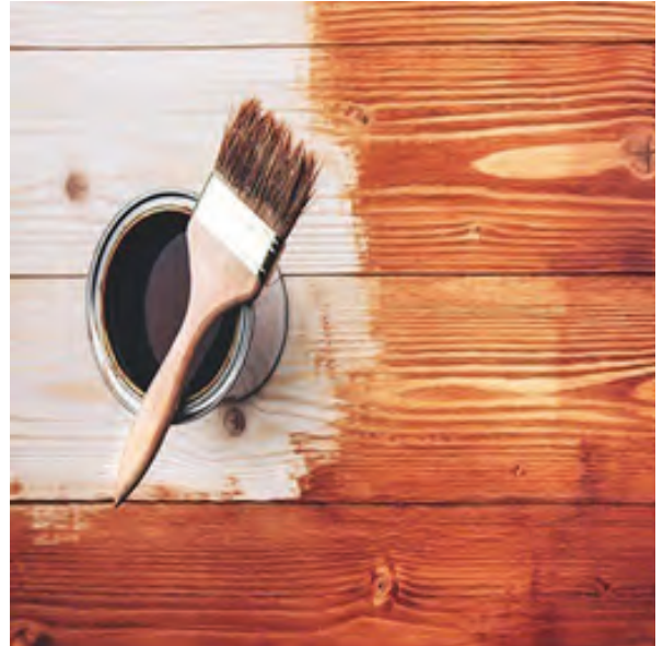
Görsel 5.30: Tik yağı uygulanmış ahşap
