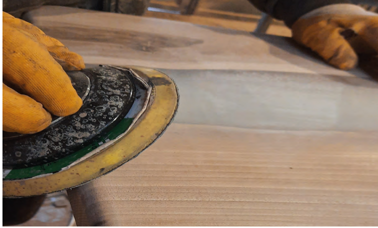
Görsel 5.24: Ürünün cumba ve maktalarının zımparalanması
