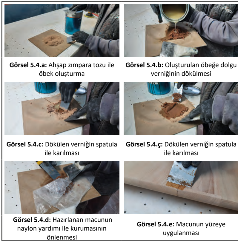
Görsel 5.4: Yüzey onarma macunu hazırlama aşamaları
