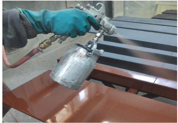
Görsel 4.36: Örtücü boya uygulaması
