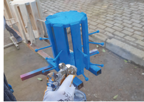
Görsel 2.34: Su bazlı boya uygulaması
