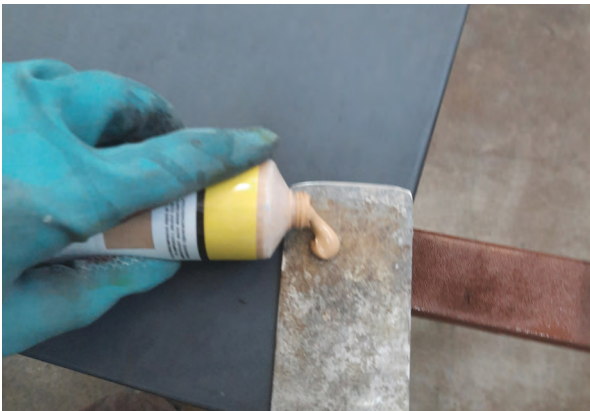
Görsel 4.31: Macun uygulaması
