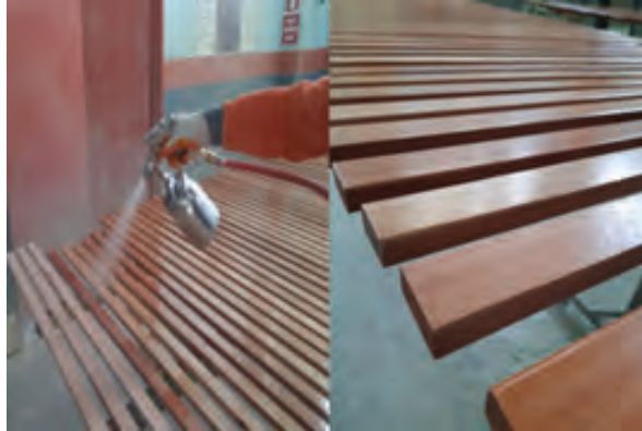
Görsel 5.6: Püskürtme tabancasıyla son kat vernik uygulama
