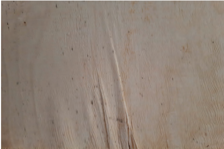
Görsel 1.2: Kabarma oluşan bir yüzey görüntüsü
