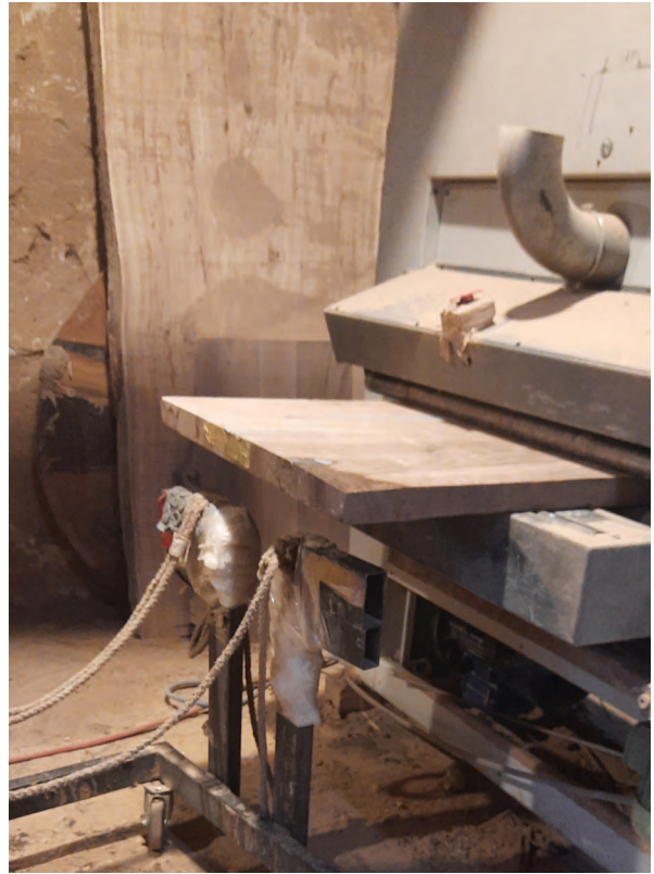
Görsel 5.23: Kontak zımpara ile zımparalama yapma
