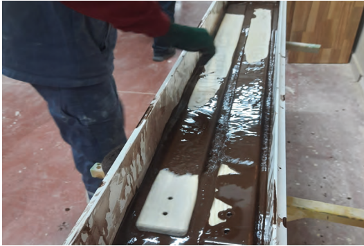
Görsel 2.26: Daldırma yöntemi ile boya uygulaması
