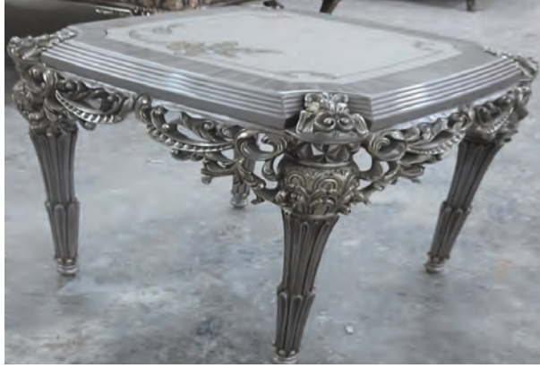
Görsel 4.56: Oymalı kısımlarda İmitasyon gümüş varak, yüzeyde pentür, oymalı kısımlarda patine uygulanmış ürün
