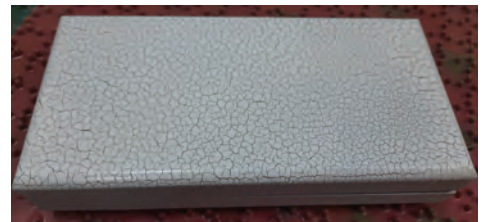
Görsel 4.48: Çatlak boya uygulaması yapılmış ürün
