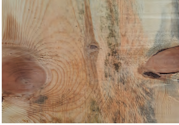
Görsel 1.8: Yüzeyinde büyük bir budak bulunan masif parçası
