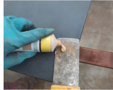
Görsel 2.30: Macun kontrolünün yapılması
