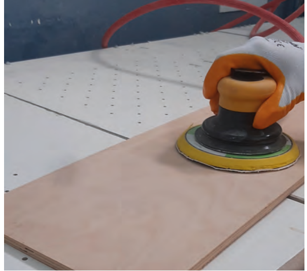
Görsel 2.17: İlk ıslatma sonrası ilk zımparalama
