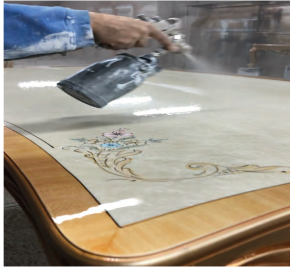
Görsel 4.47: Pentür uygulanmış mobilya yüzeyine son kat uygulaması
