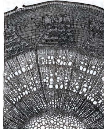
Görsel 2.2: Ahşabın büyütülmüş baş kesiti
