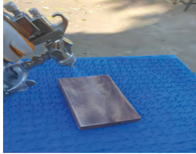
Görsel 4.5: Poliüretan dolgu verniği uygulaması
