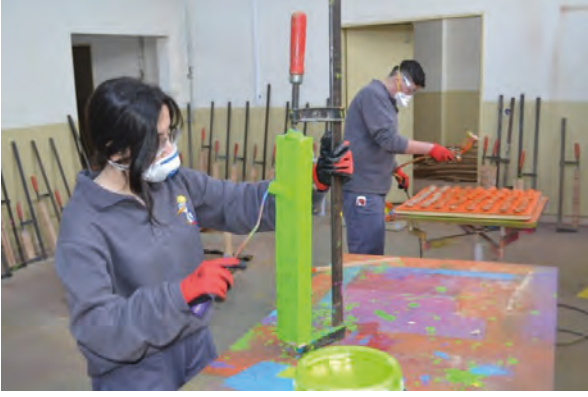
Görsel 2.36: Su bazlı boya uygulaması
