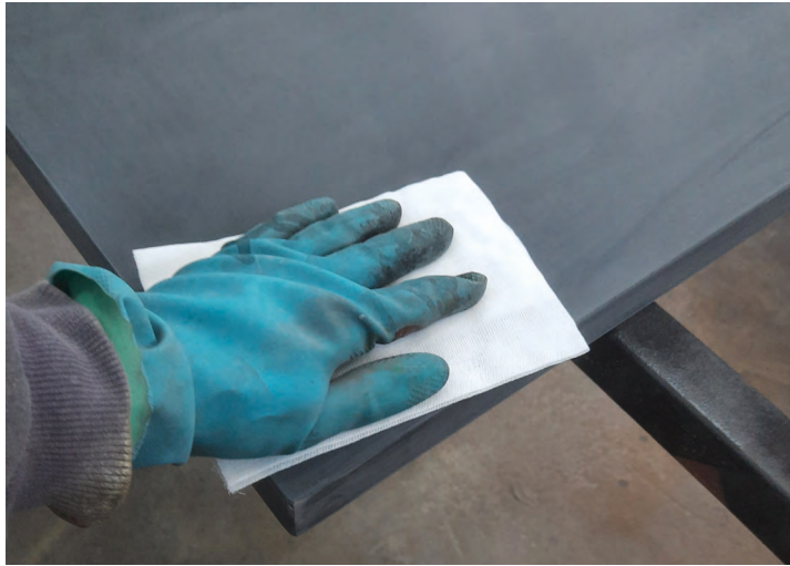
Görsel 4.30: Mumlu bezle tozların temizlenmesi
