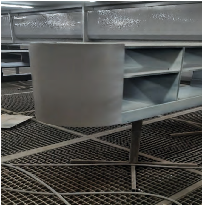
Görsel 6.1: Üsten hava basınçlı duvar ve tabandan sulu sistem boyama kabini
