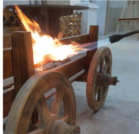
Görsel 4.2: Pürmüz lambası ile eskitme uygulaması
