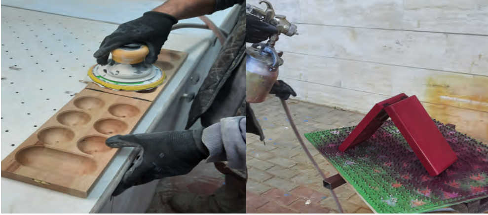
Görsel 4.49: Dolgu verniği zımparası yapılmış ürüne selülozik boya uygulaması
