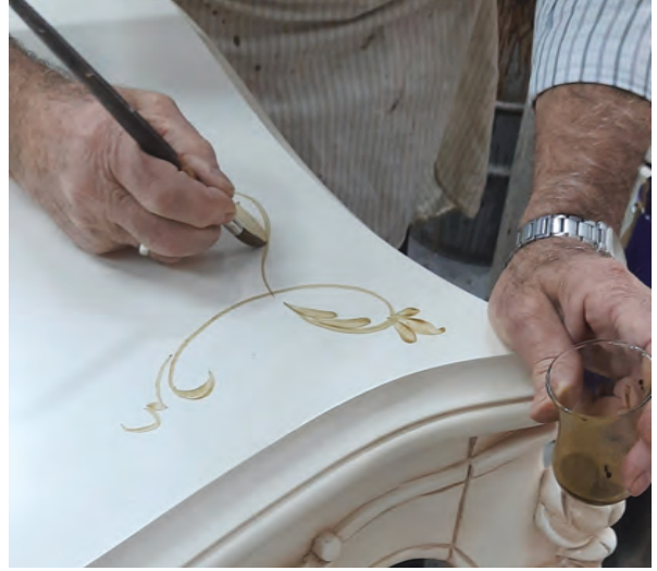
Görsel 4.46: Pentürün elle çizilmesi
