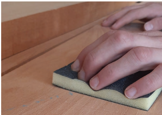
Görsel 2.20: Nemlendirme ile kabaran liflerin sünger zımpara ile zımparalanması
