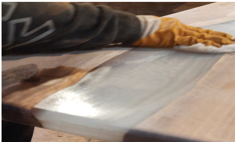
Görsel 5.26: Yüzeydeki zımpara tozlarının temizlenmesi
