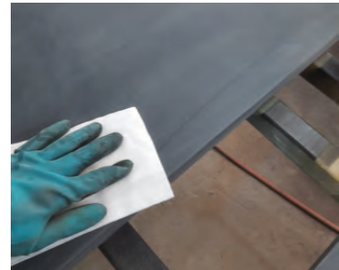
Görsel 2.32: Mumlu bez ile zımpara tozlarının alınması
