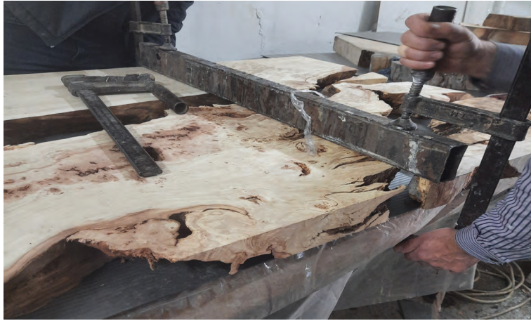
Görsel 5.18: Epoksi masa için kompozisyonun sabitlemesi
