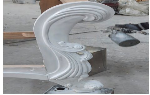
Görsel 4.8: Yüzeye MDF dolgu verniği uygulaması
