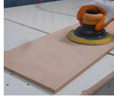
Görsel 2.6: Ahşap yüzeyin zımparalanması
