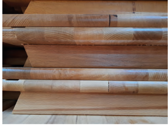
Görsel 1.7: Yüzeyinde açma meydana gelen bir parçanın görüntüsü
