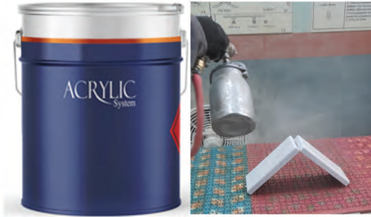
Görsel 4.52: Akrilik son kat vernik uygulaması
