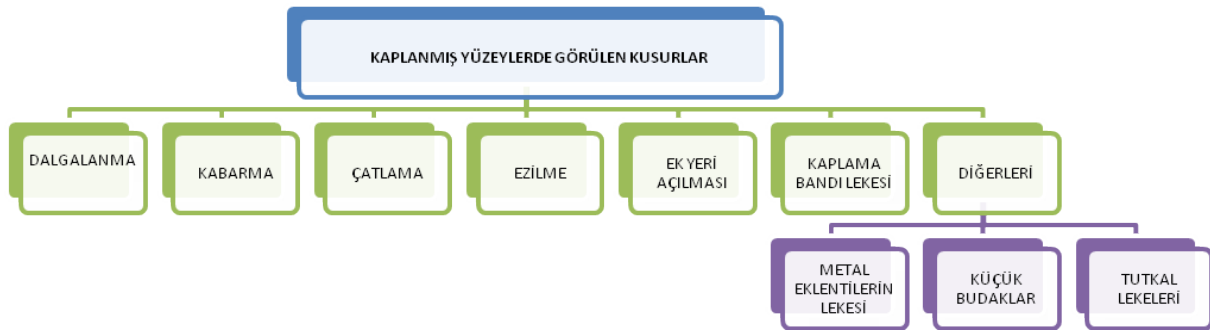
Şema 1.12: Kaplanmış yüzeylerde görülen kusurlar
