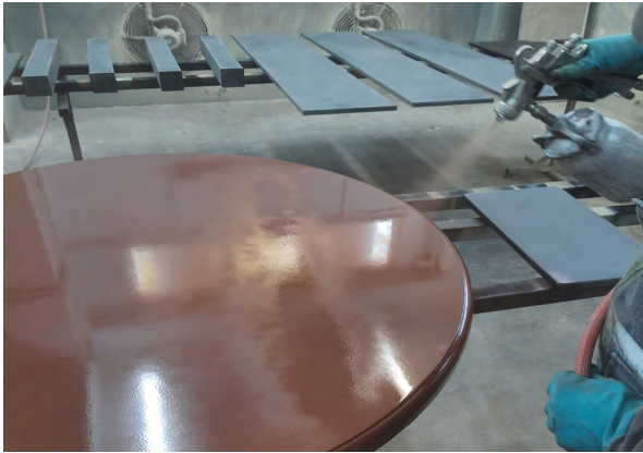
Görsel 4.35: Örtücü boya uygulaması
