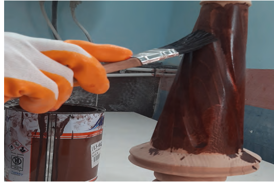
Görsel 2.27: Fırça ile boya uygulaması
