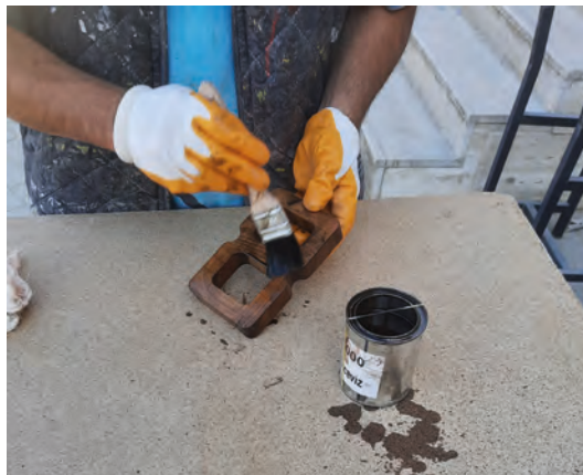
Görsel 2.38: Fırça ile boya uygulaması
