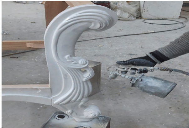
Görsel 4.57: Örtücü poliüretan dolgu verniğinin uygulaması
