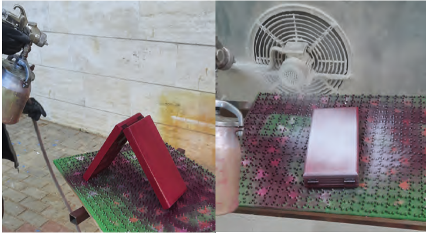
Görsel 4.50: Dolgu verniği zımparası yapılmış ürüne selülozik boya uygulaması
