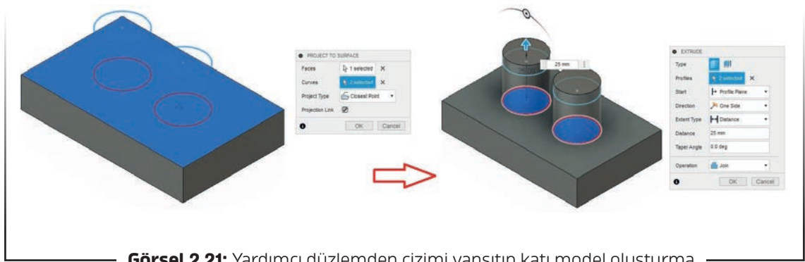
Görsel 2.21: Yardımcı düzlemde çizimi yansıtıp katı model oluşturma
