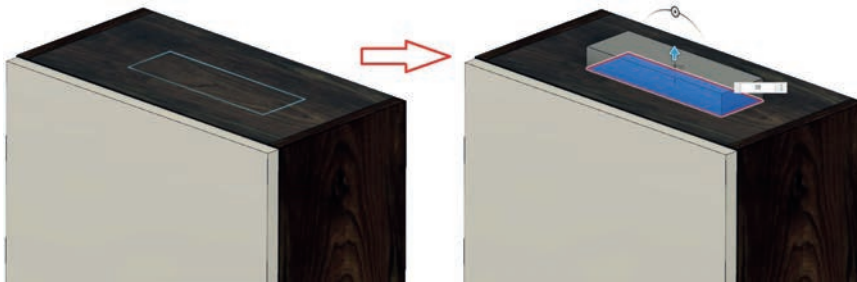
Görsel 3.7: Montaj parçası üzerine katı model unsuru ekleme
