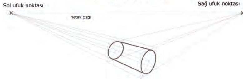
Görsel 2.43: Yatık silindirin iki kaçış noktalı konik perspektifi
