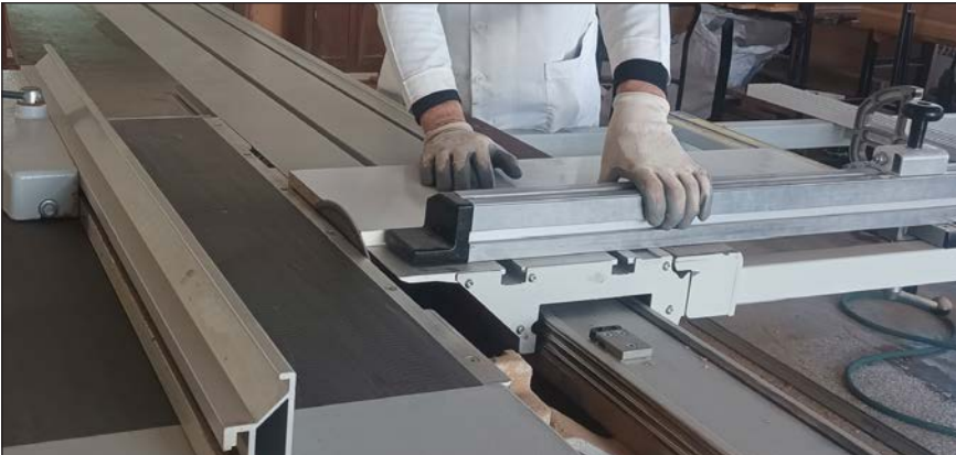
Görsel 2.3: Hareketli tabla ile boy kesimi
