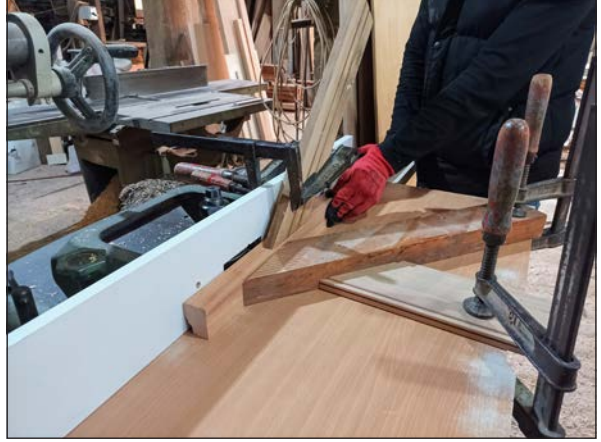
Görsel 4.37: Baskı tarağı kullanarak çalışma
