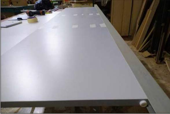
Görsel 3.4: U profili takılmış dolap parçaları
