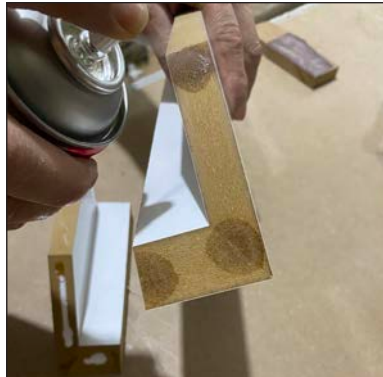
Görsel 3.29 a, b, c: Gönyeburun taç köşesini yapıştırma aşamaları
