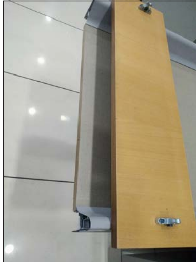
Görsel 3.48 a, b, c: Tandembox çekmece kutusu ve klapa montaj aşamaları
