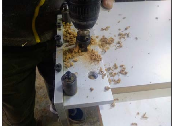
Görsel 2.37: İş parçasına minifix gövde deliği delme
