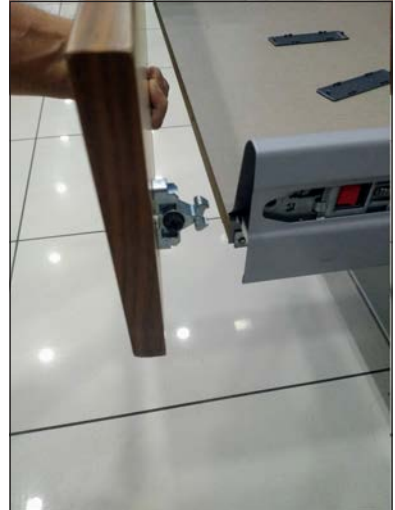
Görsel 3.48 a, b, c: Tandembox çekmece kutusu ve klapa montaj aşamaları
