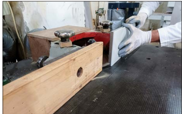
Görsel 2.74: Alt freze makinesi ile kiriş açma
