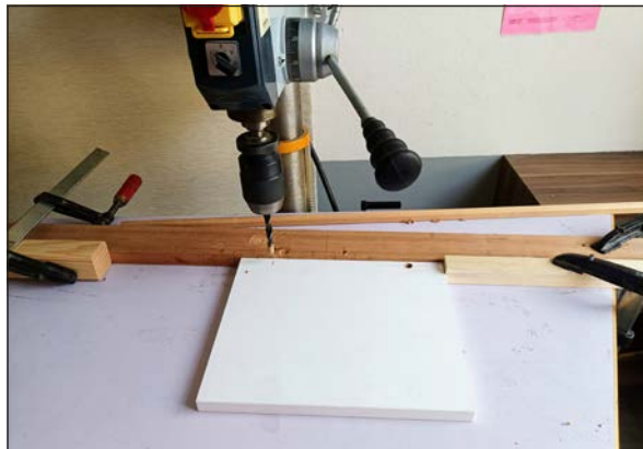
Görsel 2.59: Dayama parçaları kullanılarak seri delik delme
