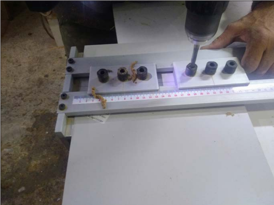
Görsel 2.35: İş parçası yüzeyine kavela deliği delme
