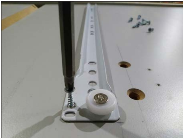
Görsel 3.15: Klasik metal rayı içerlek bağlama
