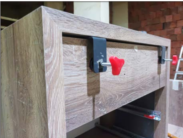
Görsel 3.44: Klapayı mengene ile bağlama
