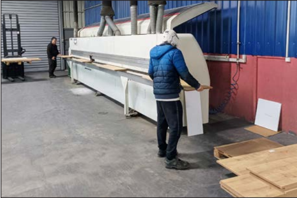
Görsel 2.12: Makine ile bantlama yapma
