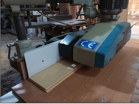
Görsel 4.36: Otomatik itici kullanarak çalışma
