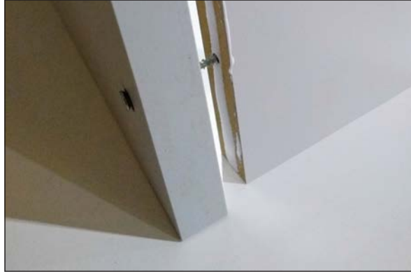
Görsel 3.12: Tutkallı, vidalı köşe birleştirme
