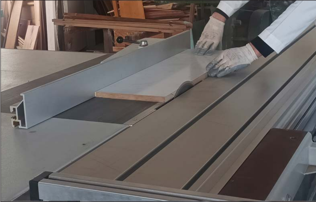
Görsel 2.5: Tabla siperi ile genişlik kesimi yapma
