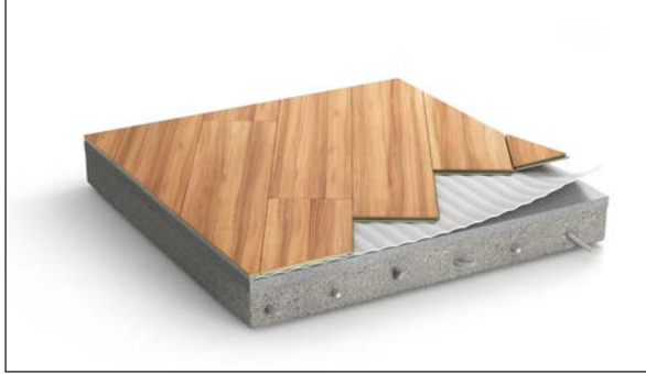
Görsel 5.41: Tutkalsız parke döşeme kesiti
