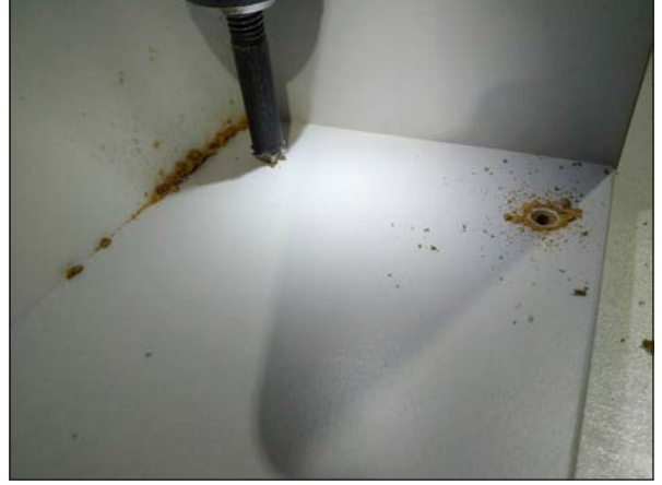
Görsel 3.43: Klapa bağlantı deliklerine havşa açma
