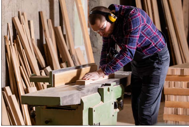
Görsel 4.32: Lambri tahta yüzeyini rendeleme
