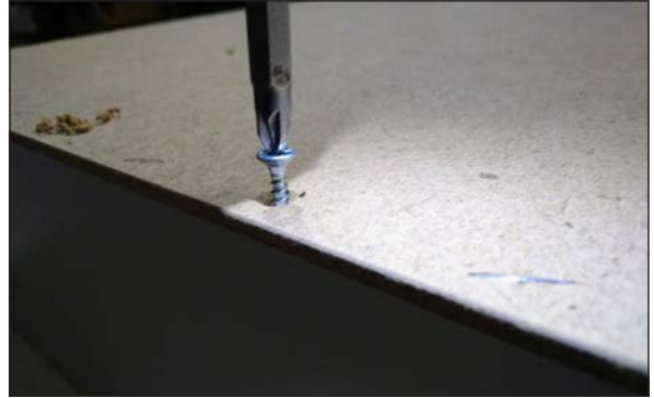
Görsel 3.36: Çekmece kutu tabanını bağlama
