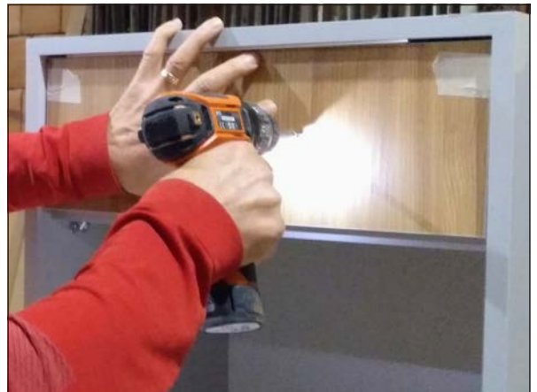
Görsel 3.45: Klapayı çekmece kutusuna bağlama
