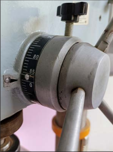
Görsel 2.55 a, b, c: Dikey delik makinesinde delik derinlik ayarı yapma aşamaları
