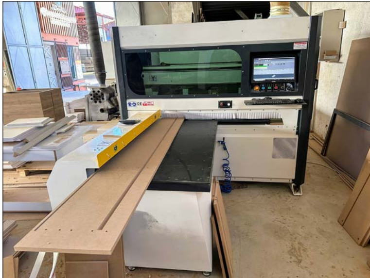
Görsel 2.71: Tabla işlemede kullanılan CNC makinesi
