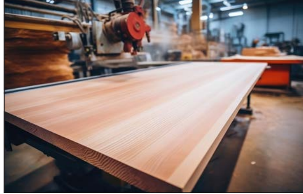
Görsel 1.88: Masif panelde elyaf yönü
