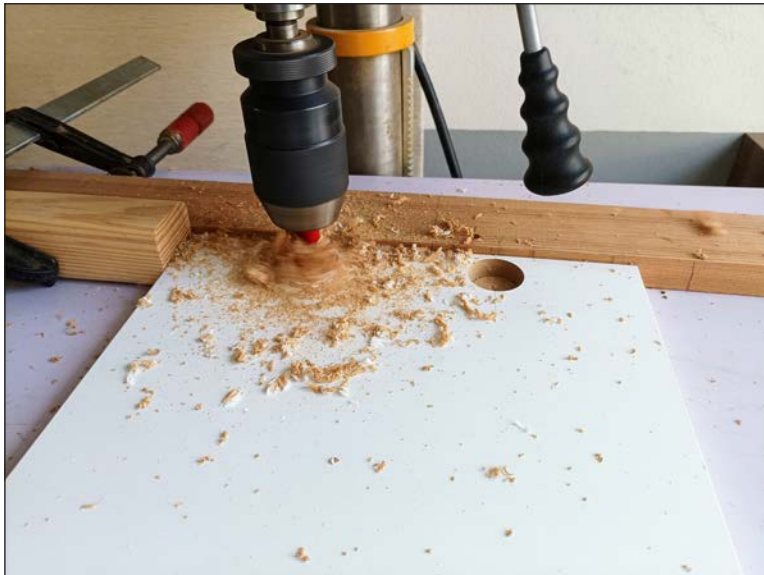
Görsel 2.103: Dikey delik makinesi ile menteşe yuvası açma
