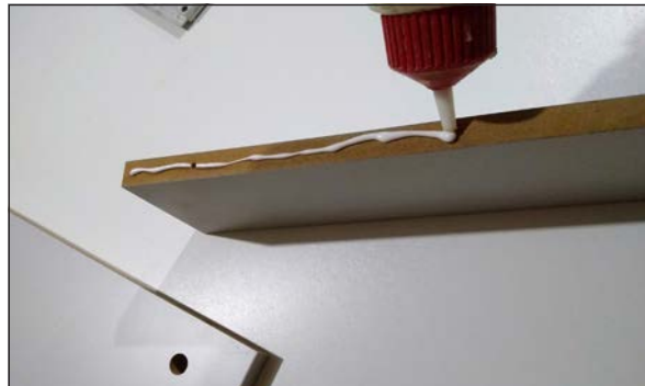
Görsel 3.11: Vidalı birleştirme alanı tutkallama
