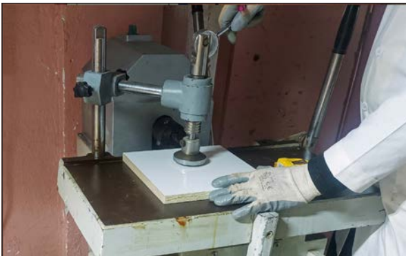
Görsel 2.50: Baskı pabucu ile iş parçasını bağlama
