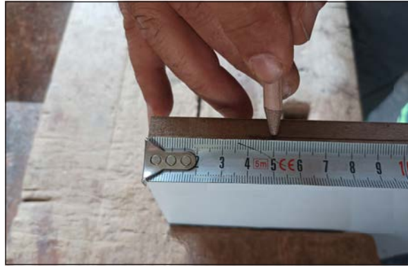
Görsel 2.49: Delik merkezi kenar uzaklığını markalama
