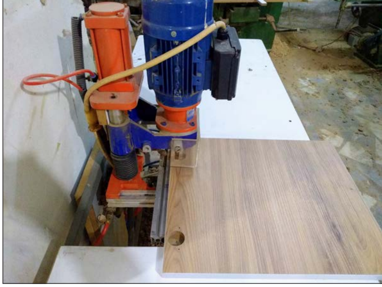
Görsel 2.104: Menteşe delik makinesi ile menteşe yuvası açma
