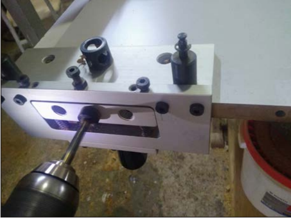
Görsel 2.36: İş parçasına minifix mil deliği delme
