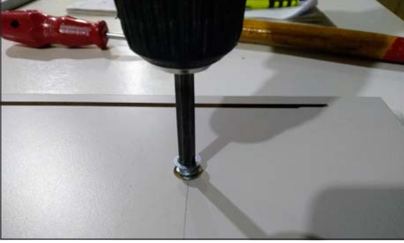
Görsel 3.8: Minifix dübelinin takılması
