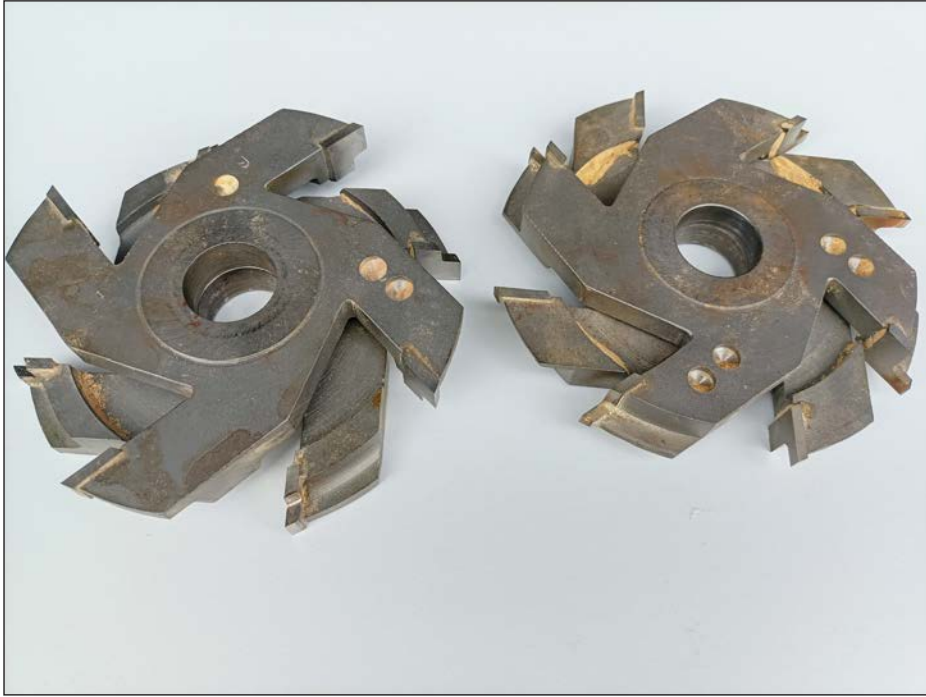
Görsel 5.32: Rabita açmada kullanılan freze bıçakları
