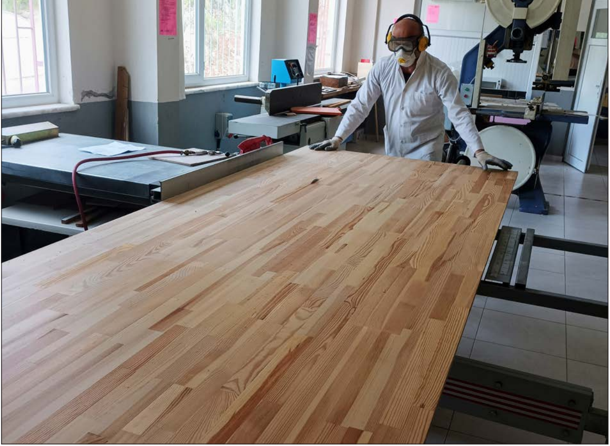
Görsel 4.35: Yapay ahşap panelden lambri tahtası kesme
