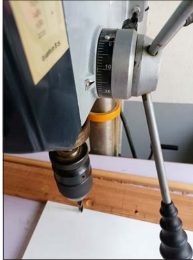
Görsel 2.55 a, b, c: Dikey delik makinesinde delik derinlik ayarı yapma aşamaları
