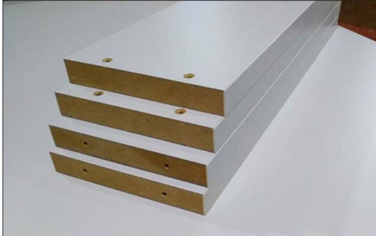
Görsel 2.105: Vida kılavuz delikleri açılmış çekmece kutusu parçaları
