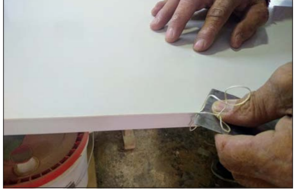
Görsel 2.11: Bant fazlalıklarının kesilmesi
