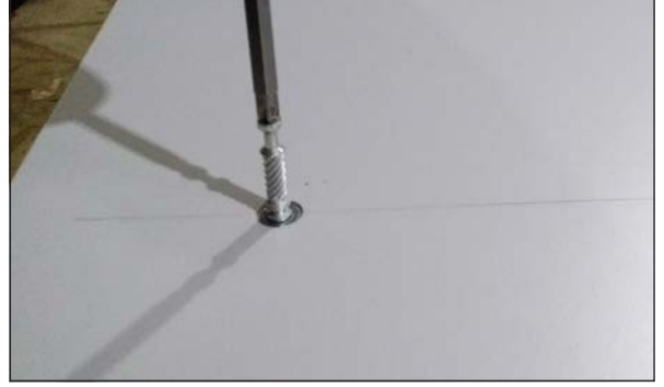
Görsel 3.9: Minifix milinin takılması
