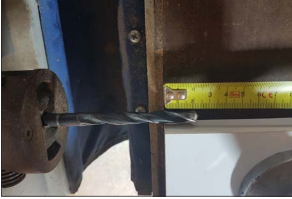
Görsel 2.47: Matkap üzerinde derinlik ölçme
