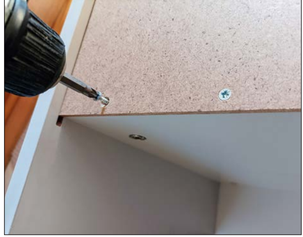
Görsel 3.25: Vida ile arkalık montajı yapma
