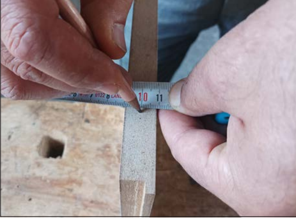
Görsel 2.40: Metre ile delik merkezinin markalanması
