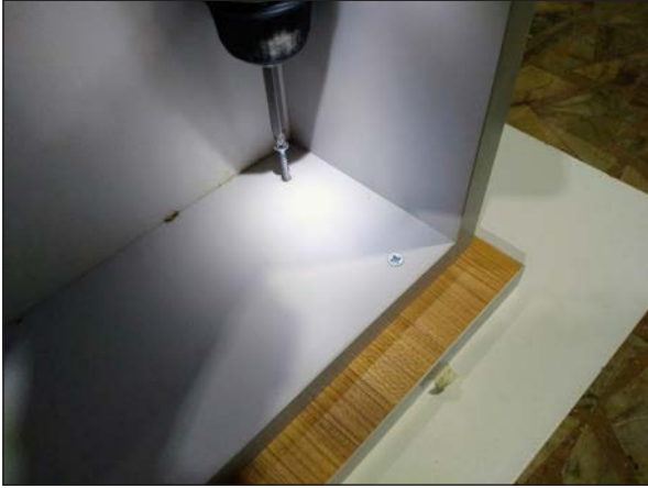
Görsel 3.46: Klapanın çekmece kutusuna bağlanması
