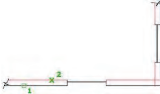
Görsel 1.2.40: Path Array komutu kullanımı
