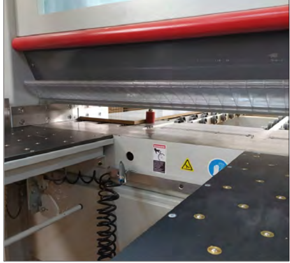
Görsel 2.43: Ebatlama kesim işlemi (Boyuna kesim)
