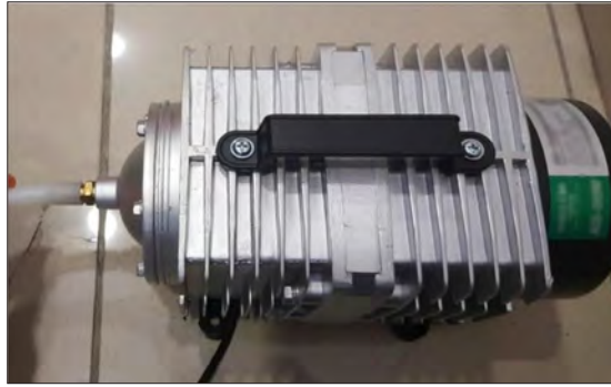
Görsel 6.9: Hava üfleme motoru
