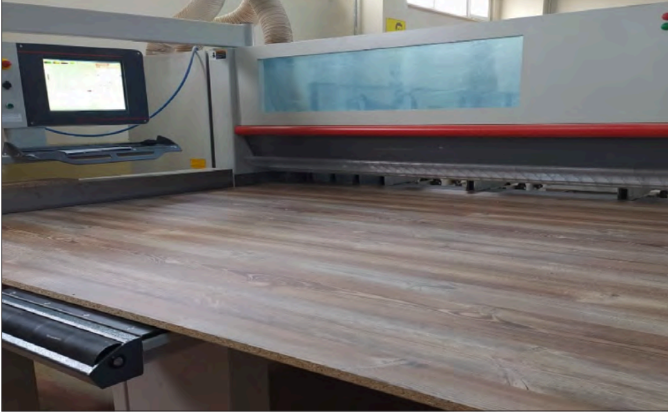
Görsel 2.12: CNC ebatlama gövde kısmı
