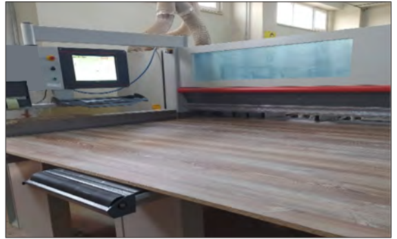
Görsel 2.4: CNC ebatlama makinesi
