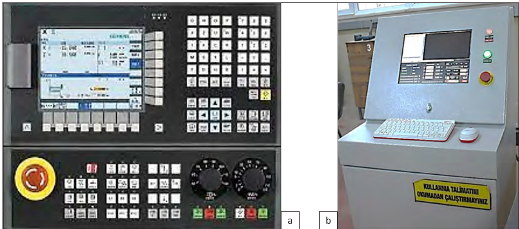
Görsel 3.1: CNC kontrol ünitesi örnekleri
