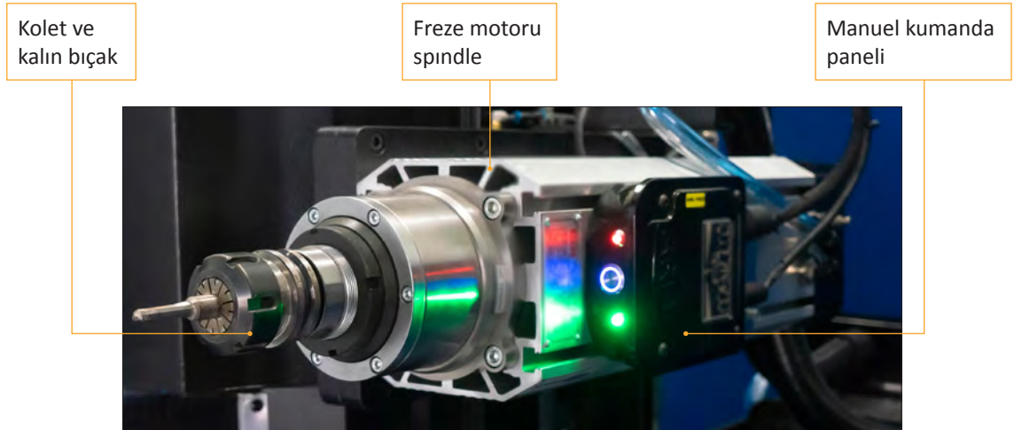
Görsel 5.5: Spindle motor
