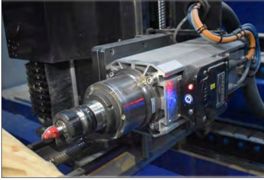
Görsel 3.2: İşlem motoru (Otomatik takım değiştirmeli)
