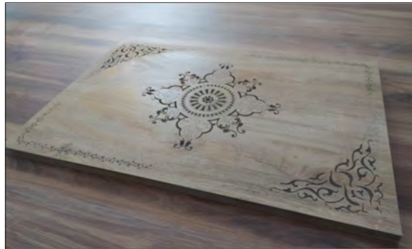
Görsel 6.56: Yakma işlemi uygulanan dolap kapağı
