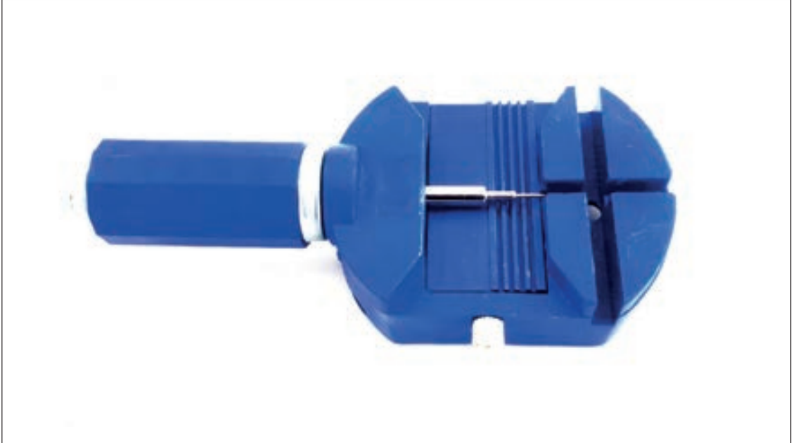
Görsel 2.22: Pim çıkartma ve kordon kısaltma aparatı
