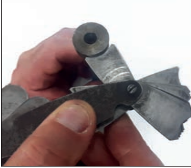
Görsel 1.70: Profil mastarı uygulaması
