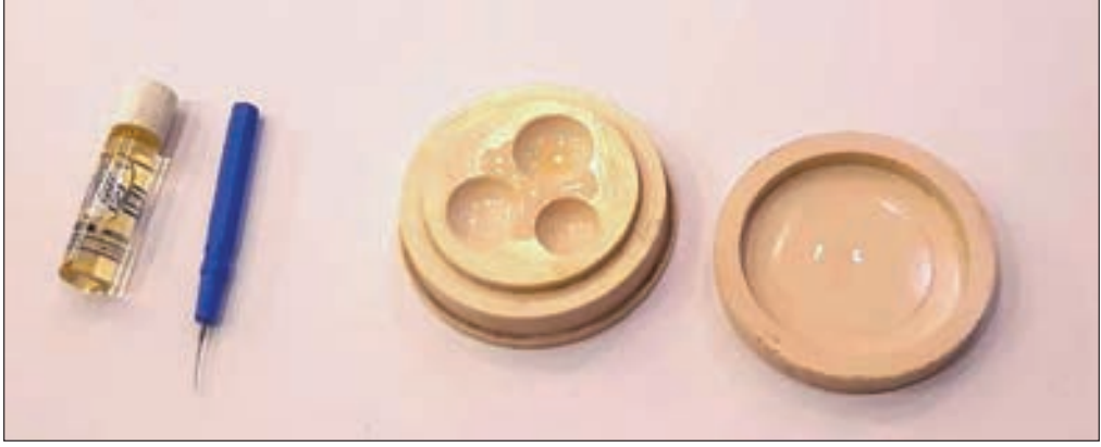
Görsel 2.26: Saat tamir yağı ve çubuğu
