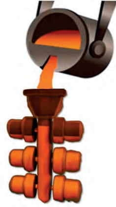
— Görsel 2.12: Sıvı metalin seramik kalıba dökülmesi
