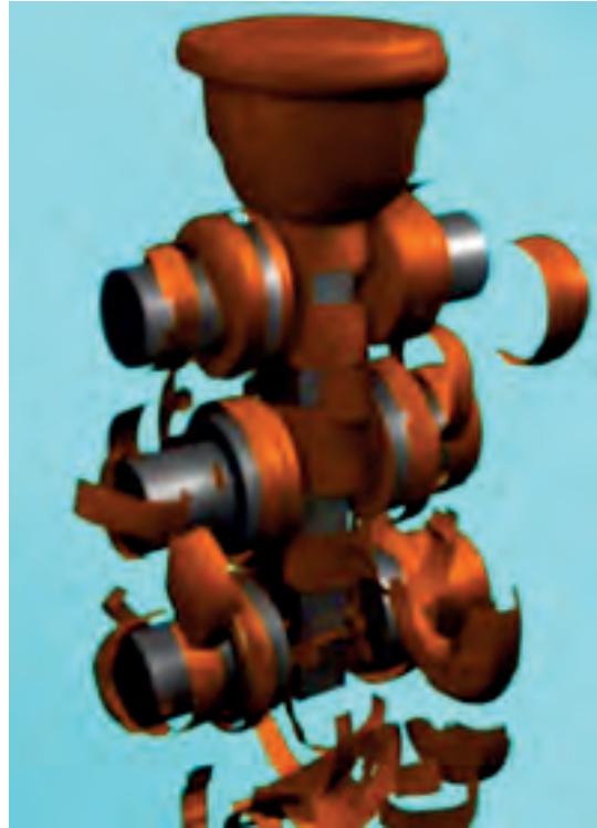
Görsel 2.13: Seramik kalıbın kırılması
