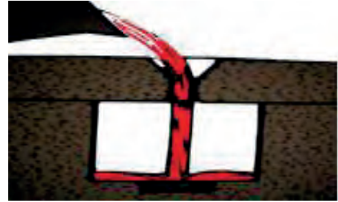
Resim 2.41: Kalıp tabanına soğutucu konmuş düz çağlayan yolluk
