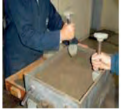
Resim 2.6: Sivri tokmak ile dolgu kumunun sıkıştırılması
