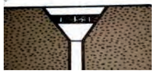
Resim 2.43 Havşaya yerleştirilmiş Süzgeç
