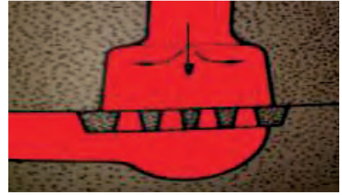
Resim 2.44 Cürufluğa yerleştirilmiş süzgeç
