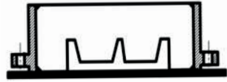
Resim 2.50: Model ve derecenin kalıplama altlığına yerleştirilmesi
