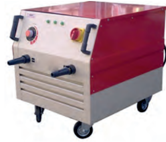
Görsel 1.3: Redresörlü ark kaynak makinesi
