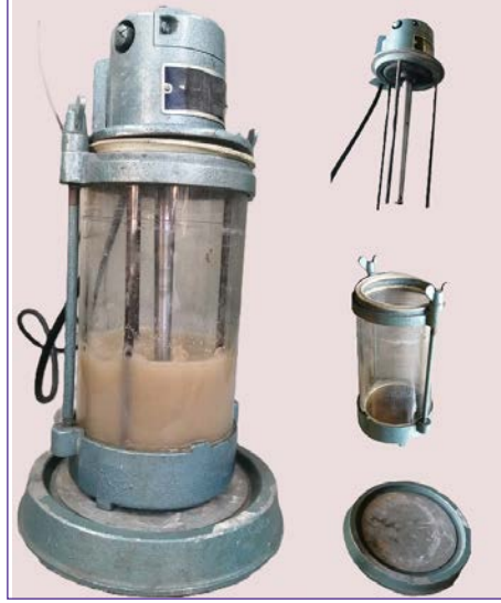
Görsel 4.3: Hızlı kum karıştırıcı ve parçaları
