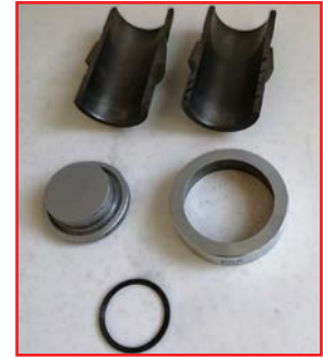
Görsel 2.2: Altlık, halka, iki parçalı tüp ve bilezik
