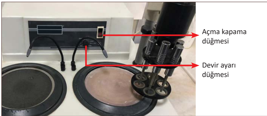
Görsel 5.8: Polisaj ve zımparalama makinesi açma-kapama ve devir ayar düğmeleri
