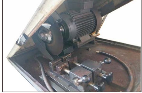
Görsel 5.4: Kesme makinesinin iç kısmı, kesme diski ve mingeneler
