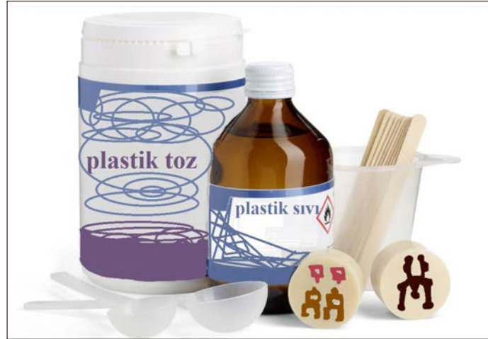
Görsel 5.5: Plastik kaplamada kullanılan toz, sıvı ve kalıplar
