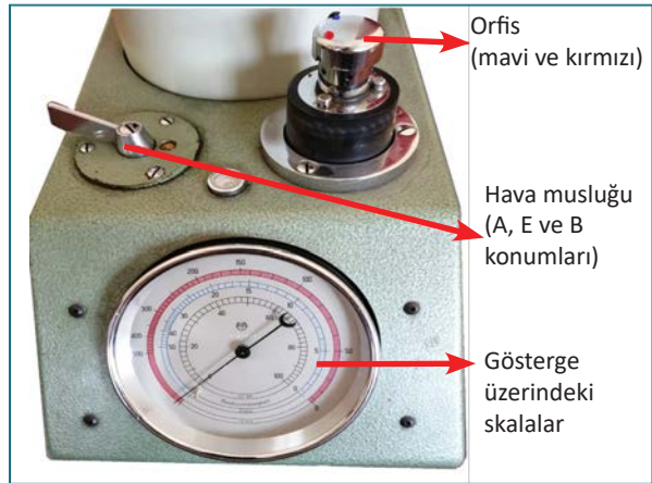
Görsel 1.44: Sulu gaz geçirgenlik cihazı göstergesi üzerindeki skalalar
