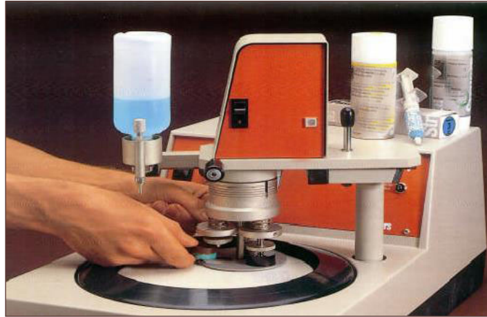
Görsel 5.10: Polisaj makinesinde elmas pasta ve sıvısı
