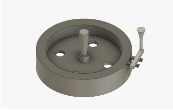
Görsel 4.3: "Volan" dökümden çıkmış parça
