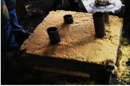
Görsel 8.2: Reçineli kalıp kumundan kalıp yapımı
