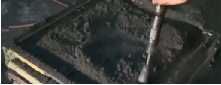
Görsel 6.3: Çıkma derecede kalıp kumunun havalı tokmak ile sıkıştırılması
