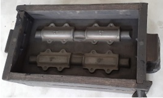
Görsel 6.8: Plak model çıkma dereceleri arasında ve alt derece ilk kum sıkıştırılmaya hazır hâlde
