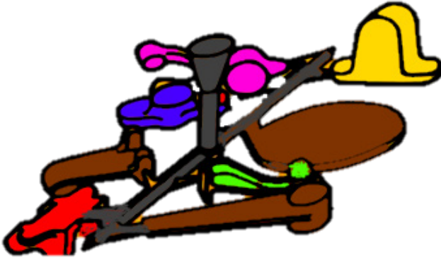
Görsel 3.4: Çok modelle yapılmış parçaların dökümden çıkmış hâli
