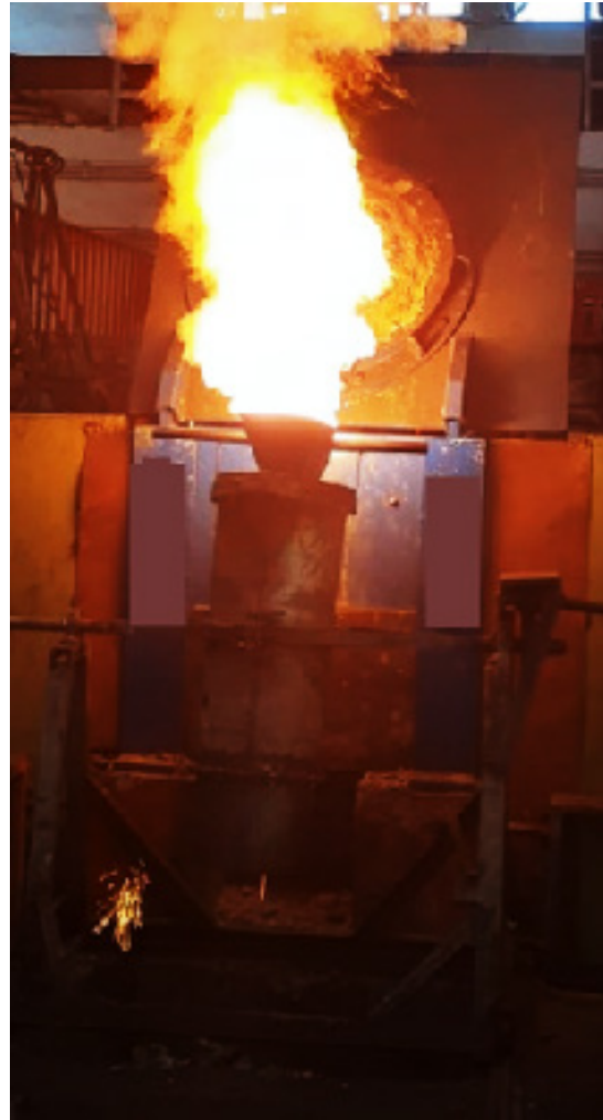
Görsel 11.2: Endüksiyon ocağındaki ergitilmiş metalin özel tretman potaya alma anı
