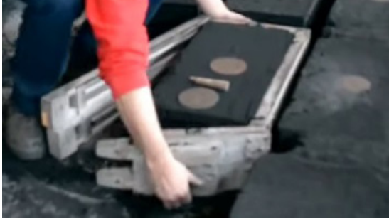
Görsel 6.6: Alt ve üst çıkma derecelerde hazırlanmış olan kalıbın zemine sıralı bırakılması
