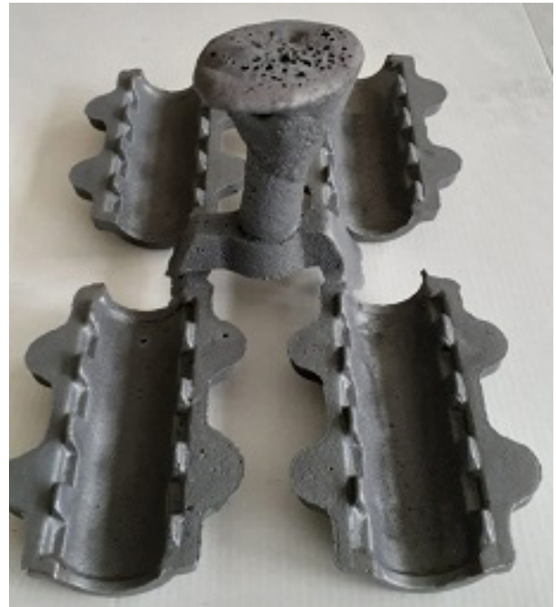
Görsel 6.9: Bir plak modelle dört adet bağlanarak çıkma derecede kalıplanmış sfero dökümden çıkmış parçalar
