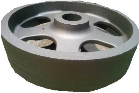
Görsel 10.2: Sıvı çelik dökülerek elde edilen parça
