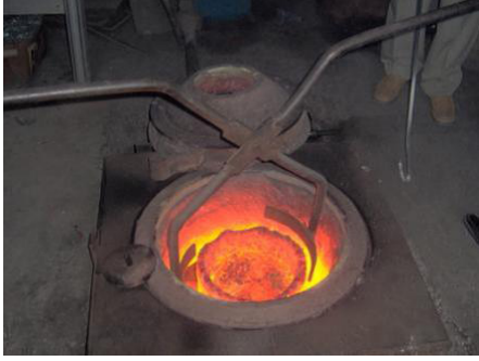
Görsel 13.3: Pota ocağında sıvı magnezyum alaşımı
