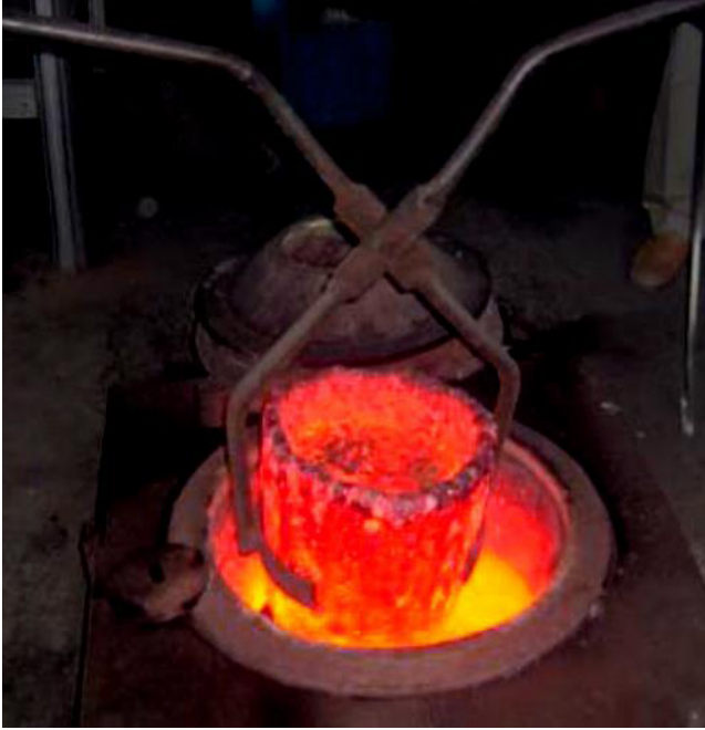
Görsel 12.2: Pota ocağındaki grafit potada ergitilmiş sıvı metalin alınması
