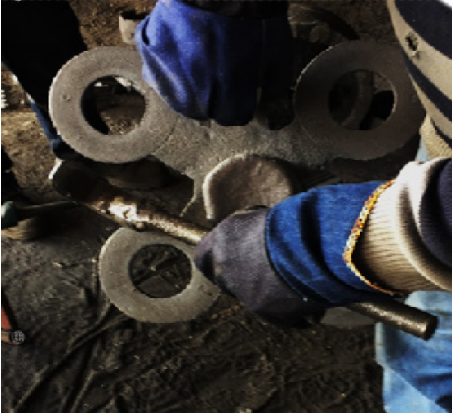
Görsel 14.1: Döküm parçayı çekiç ile kontrol etme
