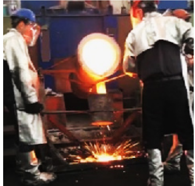
Görsel 11.4: Sıvı metalin tretman potasından taşıma potasına alınması
