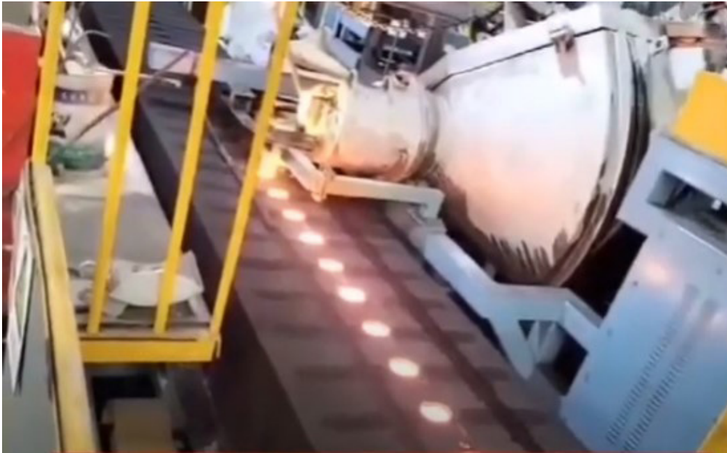
Görsel 7.8: Dizomatik yöntem ile kalıp yapma makinesiyle yapılan kalıpların dökümü
