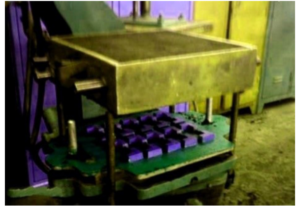
Görsel 7.3: Çıkma derecenin yukarı kaldırılması
