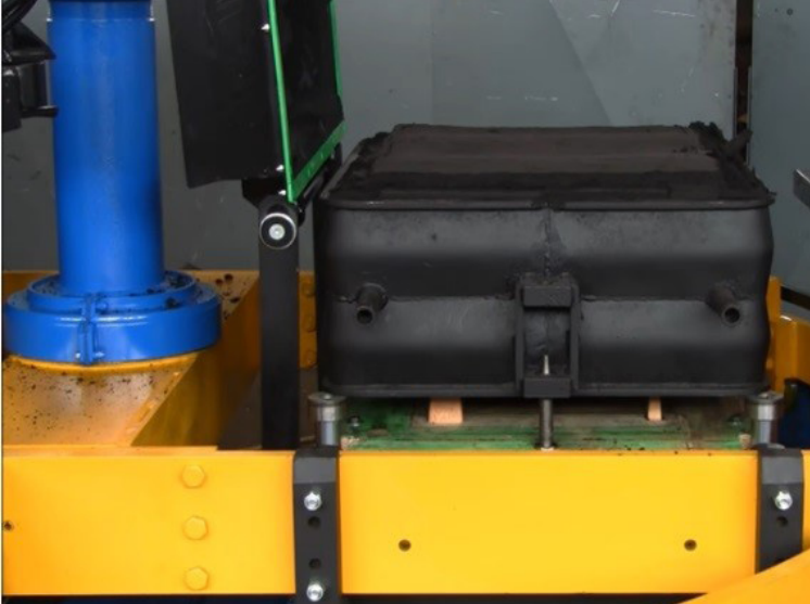
Görsel 7.1: Pres yöntemi ile çalışan kalıplama makinesinde plak modelden dereceyi ayırma
