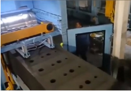
Görsel 7.7: Dizamatik yöntem ile makinede kalıplama
