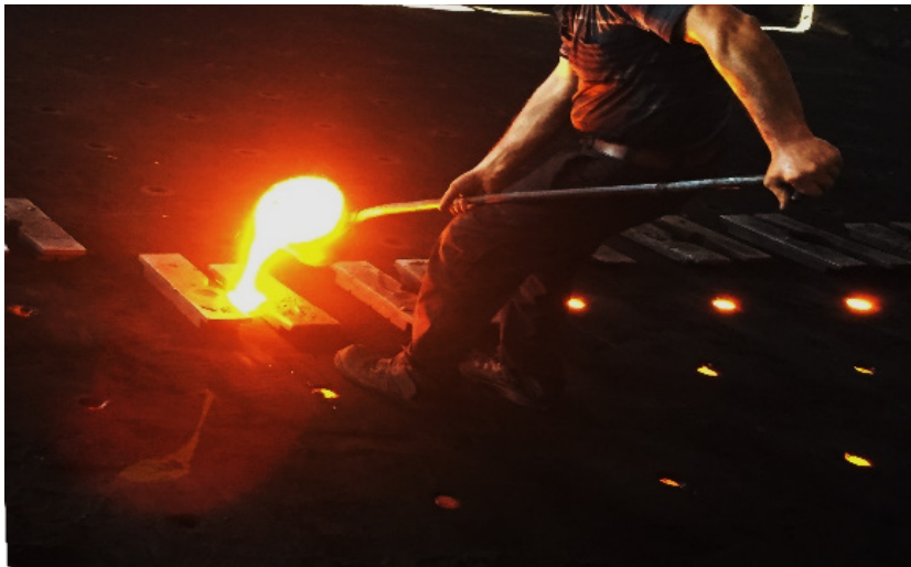
Görsel 9.3: Sıvı metalin kalıplara dökülmesi
