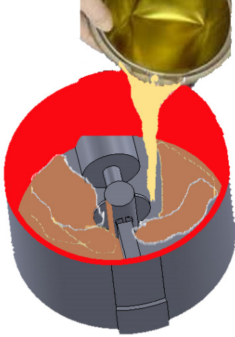
Görsel 2.1: Karıştırıcıya sıvı reçine ilave edilmesi
