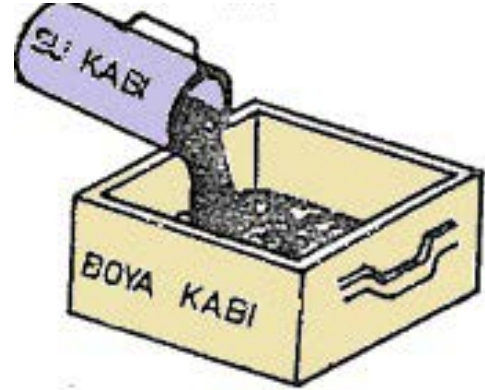
Görsel 1.8: Maça boyası hazırlamada su katma işlemi
