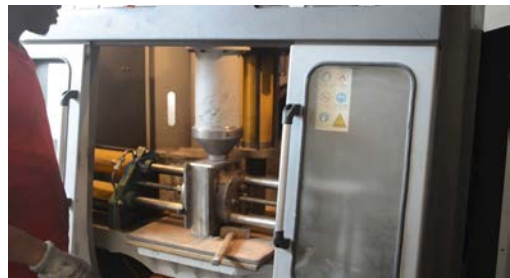
Görsel 5.8: Maça sandığına karbondioksit gazı basılması
