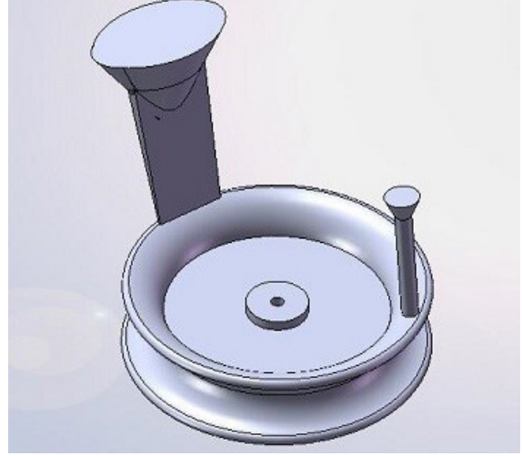
Görsel 6.5: Çevirme maçalı makaranın dökümden çıkmış hâli
