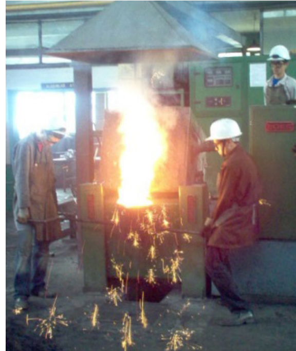
Görsel 8.7: Ocakta ergitilmiş metalin taşıma potasına alınması
