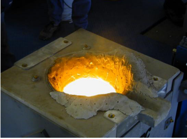
Görsel 8.4: Endüksiyon ocağında ergitme
