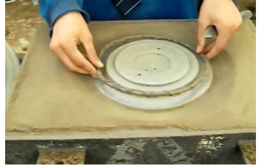
Görsel 6.3: Çevirme maçaya uygun iskelet hazırlama
