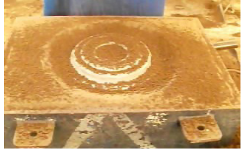
Görsel 6.4: Iskelet altına yüzey kumu elenmesi
