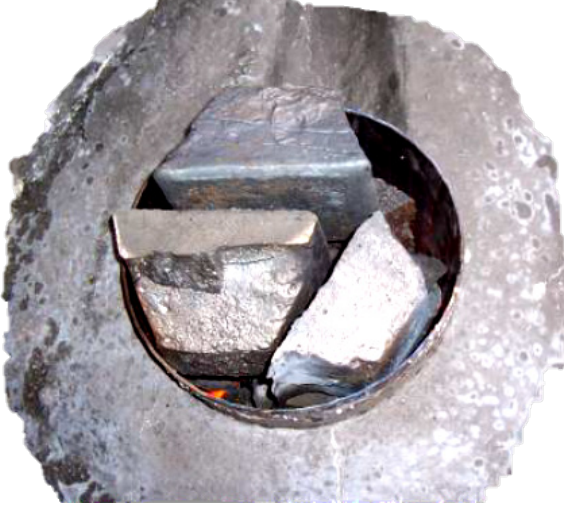
Görsel 8.6: Ocak potasına katı metali yüklenmesi
