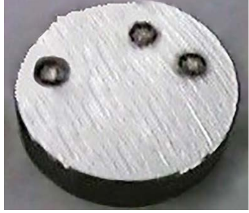
Görsel 10.6: Yanmış numune
