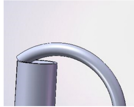
Görsel 6.12: Piston modeli ve boynuz yolluk uygulaması
