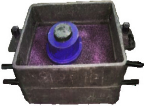
Görsel 6.17: Asma maçalı modelin ana derece üzerine konması
