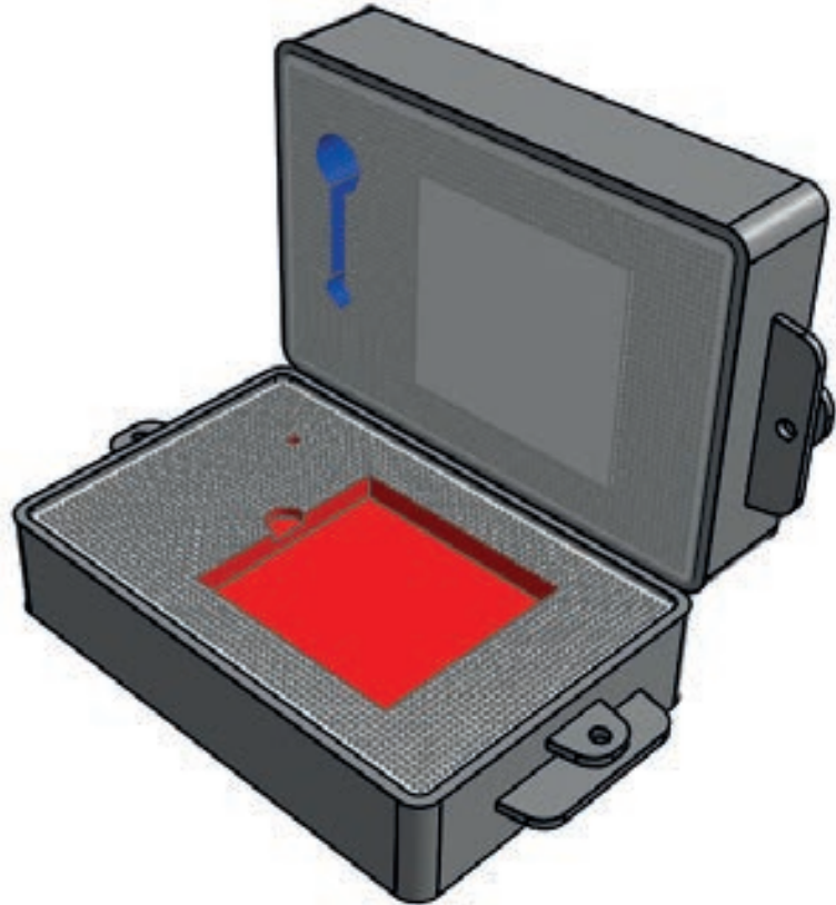
Şekil 2.43: Besleyici cürüflük ve meme bağlantısı uygulanmış kalıp
