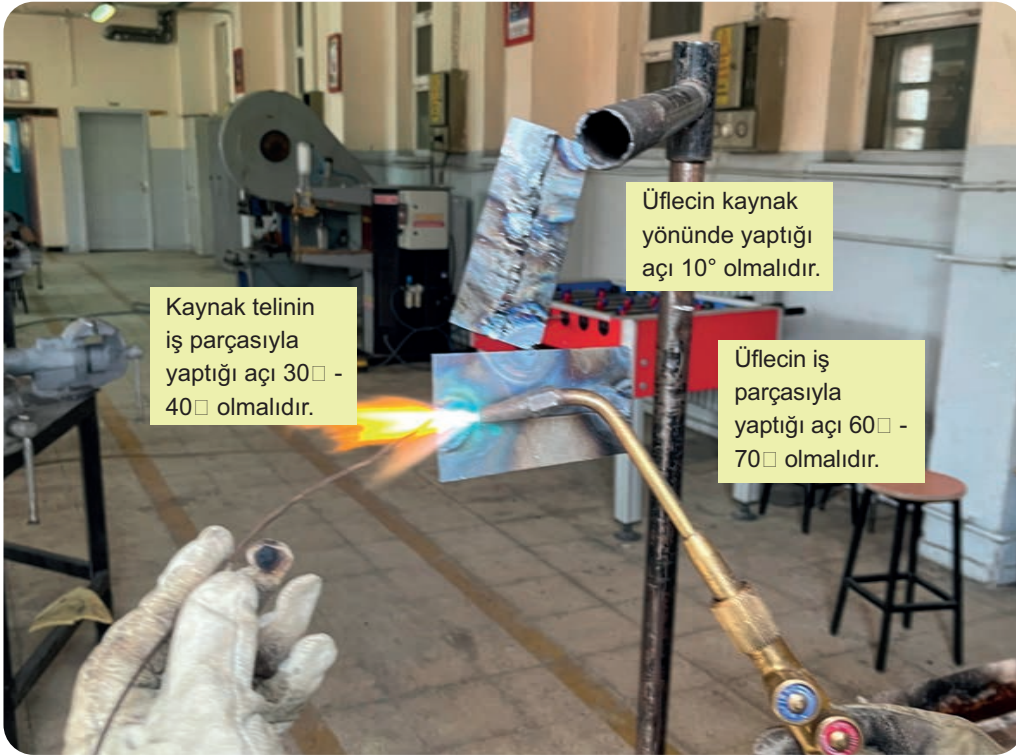
Görsel 4.2: Yan küt ek kaynağında üflece ve kaynak teline verilecek çalışma açıları
