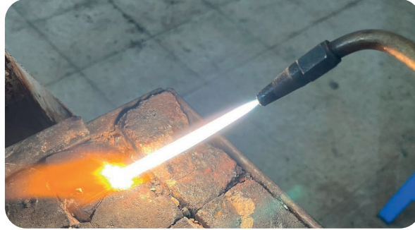
Görsel 5.4: Asetileni fazla (karbonlayıcı) alev
