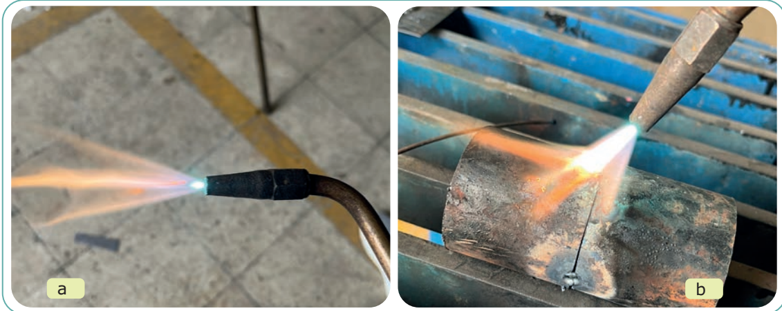
Görsel 2.5: Kaynak alevi ve borunun puntalanması
