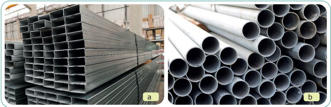
Görsel 2.2: Dikdörtgen profil ve yuvarlak su borusu
