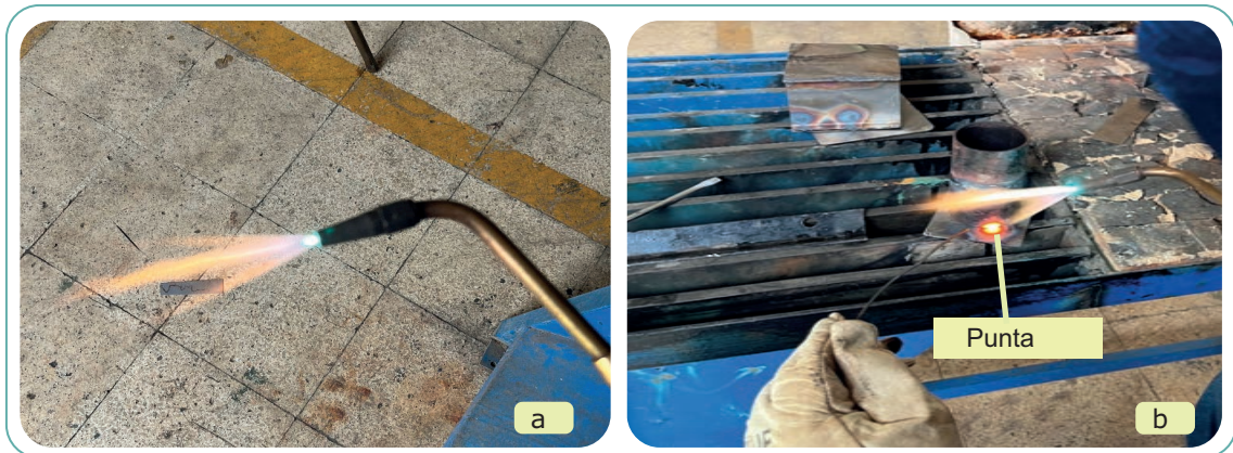
Görsel 1.5: Normal alev ve flanşa punta yapılması işlemi
