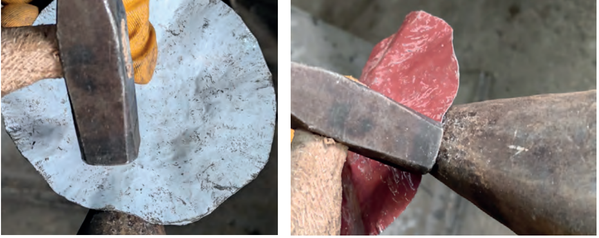
Görsel 4.24: Malzemenin tabanından çevresine doğru ondüleleri sıvama
