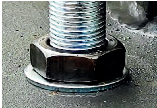
Görsel 3.41: Rondela takılarak yapılan birleőtirme
