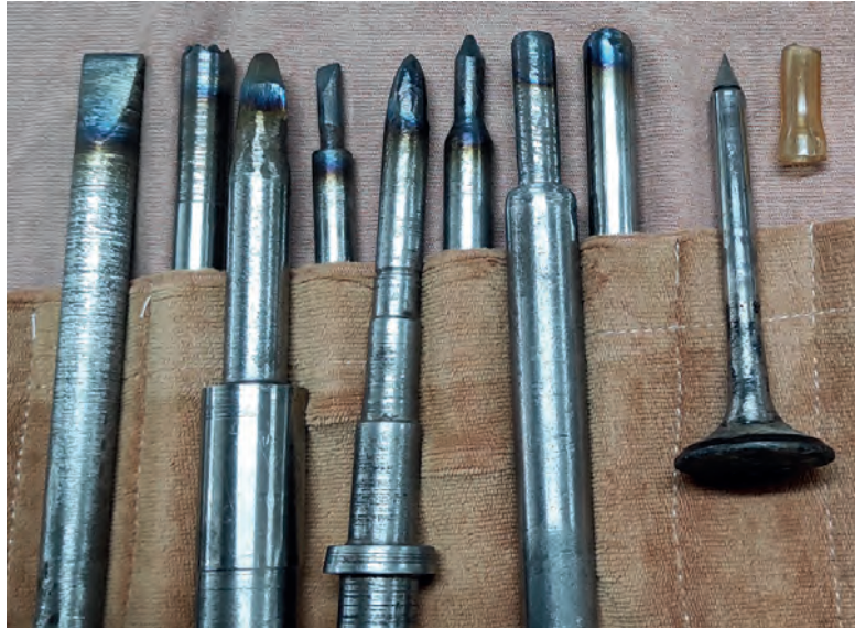
Görsel 4.10: Çeşitli ölçülerde hazırlanmış kabartma zımbaları
