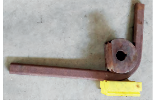
Görsel 8.22: Makinede bükme kalıbı kullanılarak iş parçasının bükülmesi
