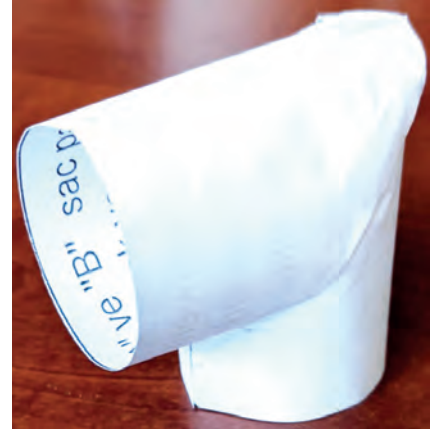
Görsel 7.28: Silindir dirsek borunun açınımının bilgisayarda iki boyutlu çizimi ve kâğıttan modeli
