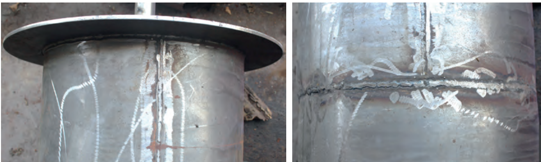
Görsel 7.2: Çelik sacdan yuvarlak kesitli flanşlı borunun imalatı
