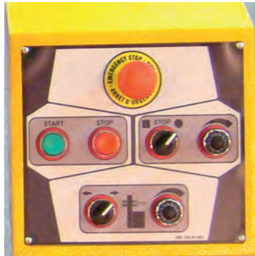
Görsel 1.20: Makinelerin üzerindeki acil durum buton yeri
