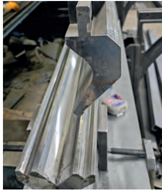
Görsel 3.59: Kenet yapımında kullanılan caka ve pres üst ve alt kalıbı
