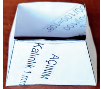
Görsel 7.19: Köşeli konik borunun açınımının bilgisayarda iki boyutlu çizimi ve kâğıttan modeli
