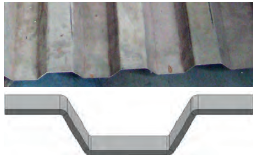
Görsel 9.10: Oluklama bükme işlemi yapılmış sac malzeme
