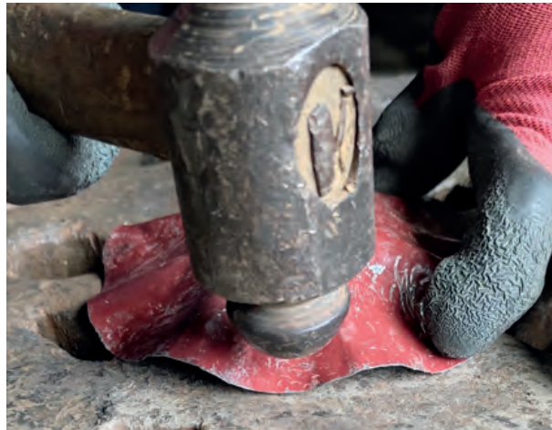
Görsel 4.23: Sac kenarlarına ondüle açma
