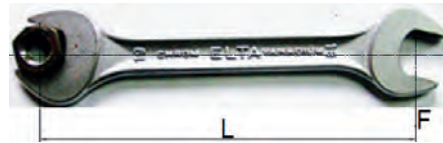
Görsel 3.38: Cıvatanın anahtar ile sıkılması
