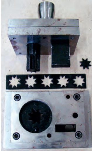
Görsel 9.4: Soğuk şekillendirme yan çakılı kesme-delme kalıbı
