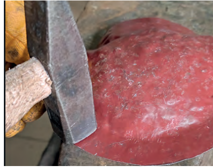
Görsel 4.20: İlk ve tersi sıvama ile biçimini açısını ayarlama
