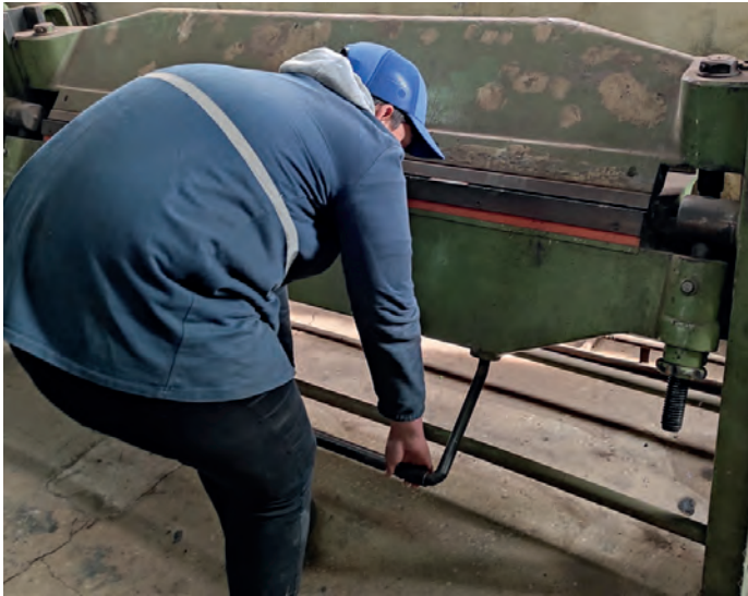
Görsel 6.13: Bükme işleminin kenette (cakada) yapılması
