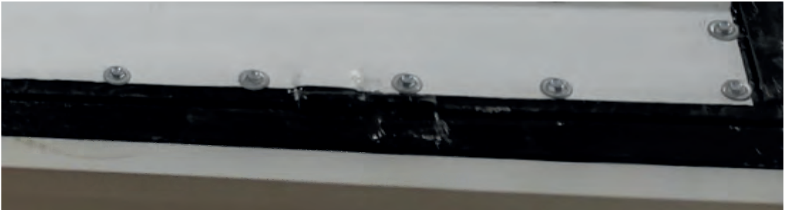
Görsel 3.50: Sac vidasıyla iş parçasını birleştirme
