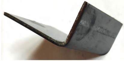
Görsel 9.7: Kenar bükme işlemi yapılmış sac malzeme
