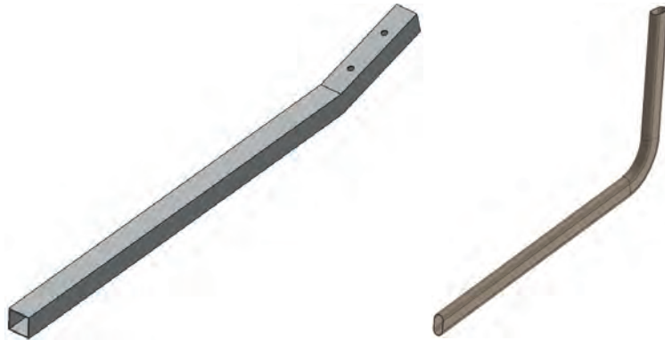
Görsel 8.21: Bükme işlemi yapılacak öğrenci sıra ve masa profili
