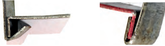
Görsel 3.57: Kenet oluşturarak parçaları bağlanma
