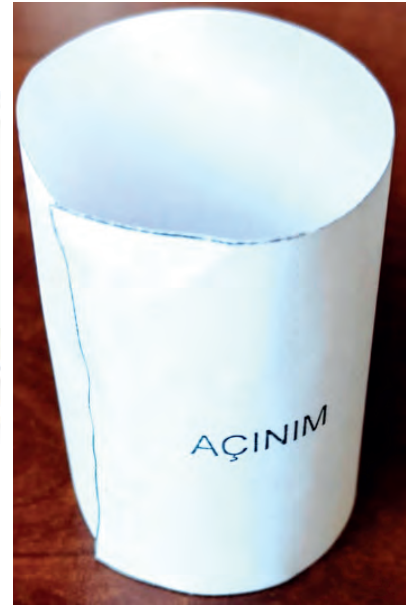
Görsel 7.5: Yuvarlak kesitli borunun açınımı ve kâğıttan modeli
