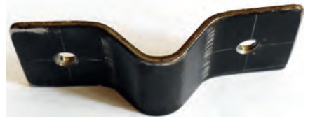
Görsel 9.11: Kabartma bükme işlemi yapılmış sac malzeme
