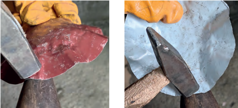
Görsel 4.25: Malzemeyi eksenini etrafında çevirerek örs üzerinde sıvama
