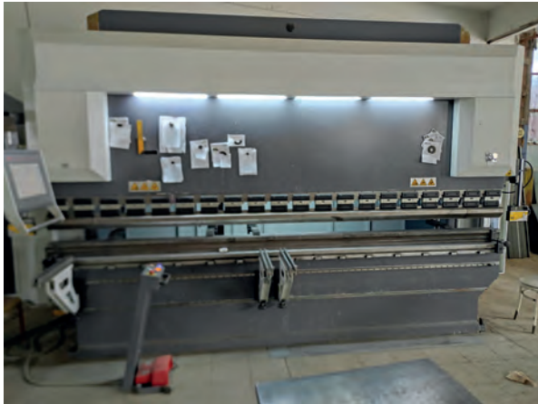
Görsel 5.2: Hidrolik sistemli abkant pres
