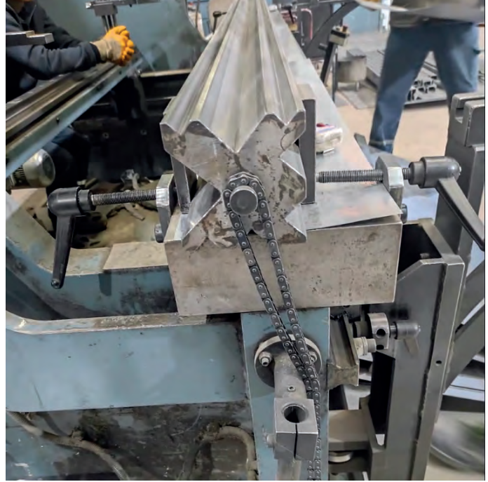
Görsel 5.5: Çeşitli V kanalları olan büküm kalıbı
