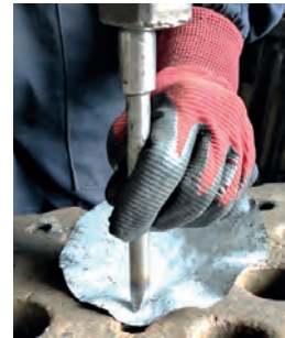
Görsel 4.15: Sac kabartmada el takımlarını (kalemlerini) kullanma
