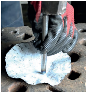
Görsel 4.15: Sac kabartmada el takımlarını (kalemlerini) kullanma
