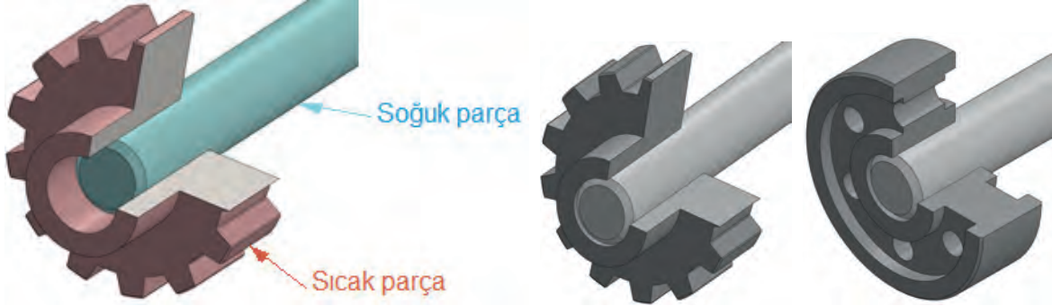
Görsel 3.13: Sıcak geçmeli birleştirme
