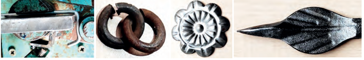
Görsel 8.3: Plastik (kalıcı) şekillendirme yapılmış parçalar
