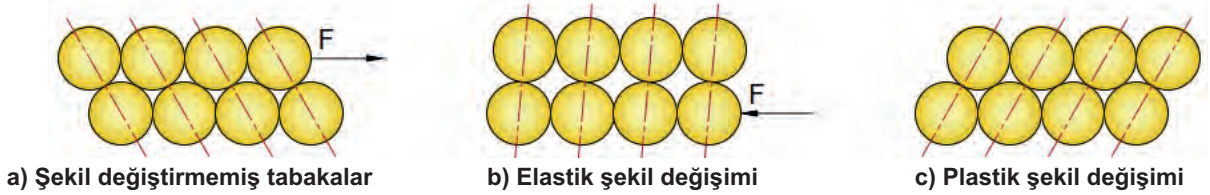
Görsel 8.4: Moleküler düzeyde şekil değiştirme (elastik ve plastik)
