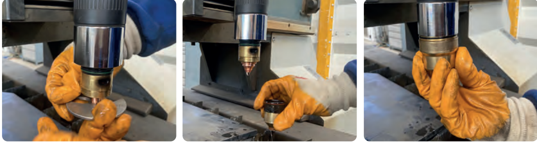
a) Elektrod değişimi
