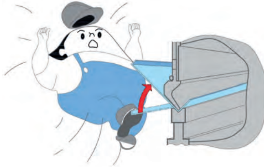
Görsel 3.4: Parçanın büküm anında savrulması
