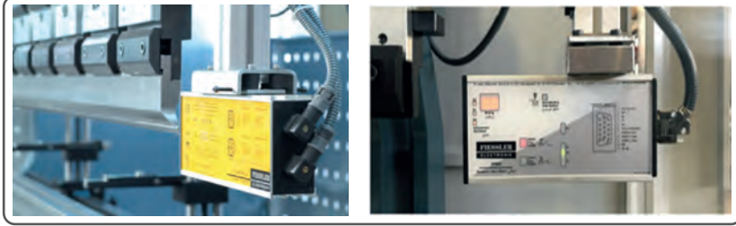
Görsel 1.124: Abkant pres kalıp ışık bariyeri (el ve parmak koruma)
