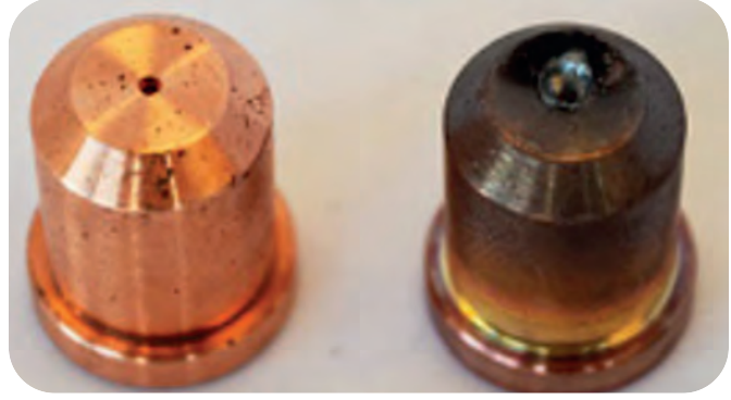
b) Nozul deformasyonu
