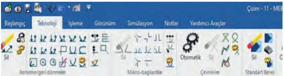
Görsel 1.134: Kesim ayrıntıları komut satırı
