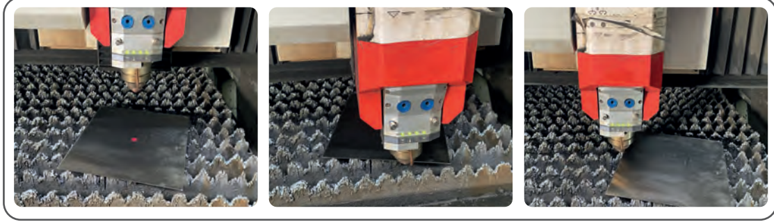
Görsel 2.72: Sac arama işlemi (Ölçüm noktaları)
