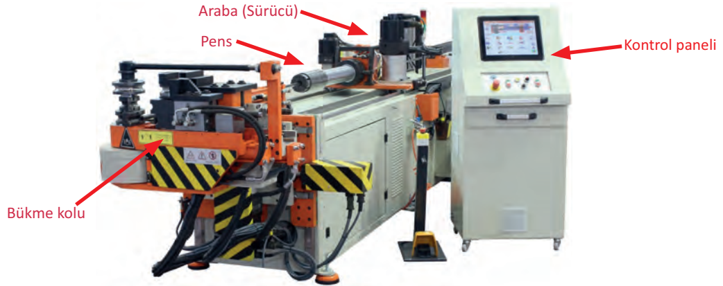
Görsel 1.117: CNC boru bükme makinesi
