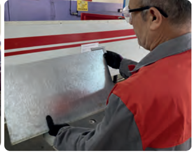
c) Köşe aç (gönye) kontrolü
