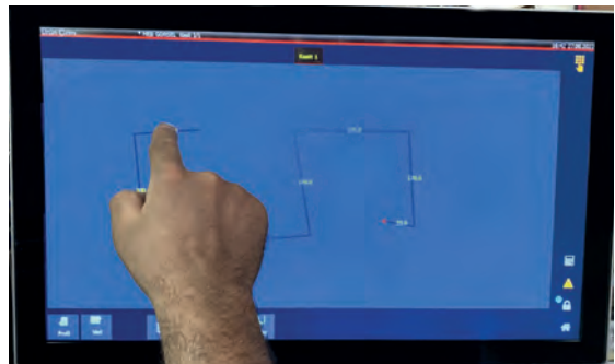
Görsel 1.140: Ekran üzerinde iki boyutlu çizim işlemi
