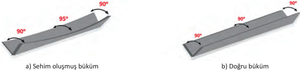
Görsel 1.96: Bükümde şekil değişimi (sehimi)
