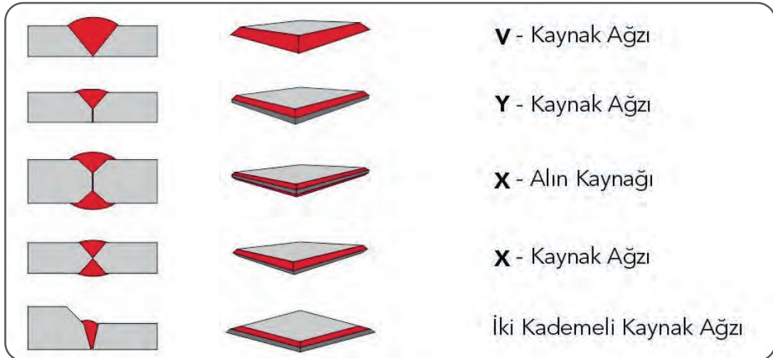
Görsel 1.58: Plazma kesimde kaynak ağzı formları
