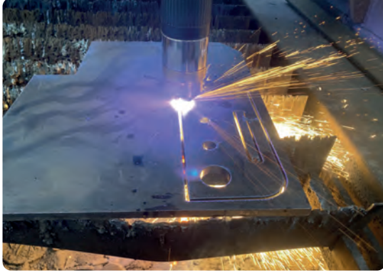
a) Plazma kesim işlemi
