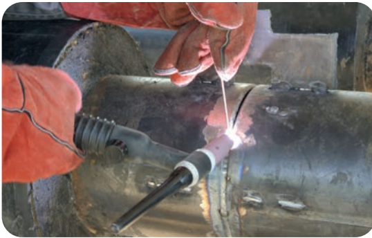
Görsel 7.3: TIG ile boru kaynağı
