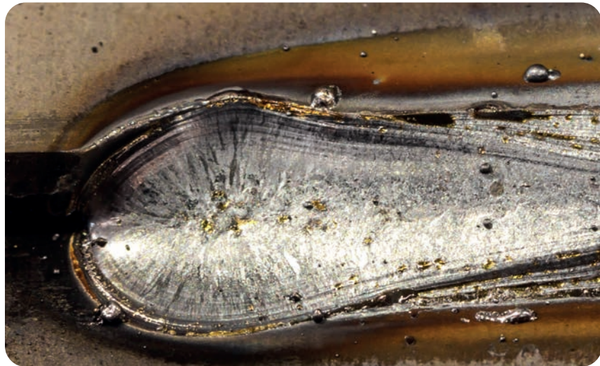
Görsel 4.13 Kaynak dikişinde göz ya da çatlak başlangıcı
