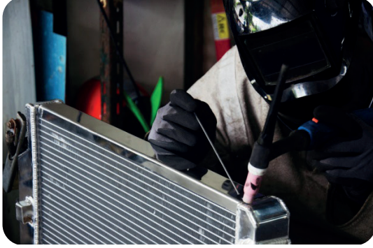
Görsel 5.24: Alüminyum oto radyatörün TIG kaynağı
