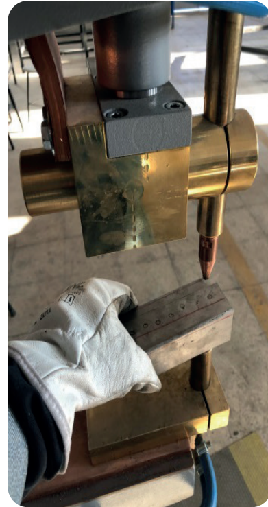
Görsel 1.6: Direnç kaynağı uygulaması
