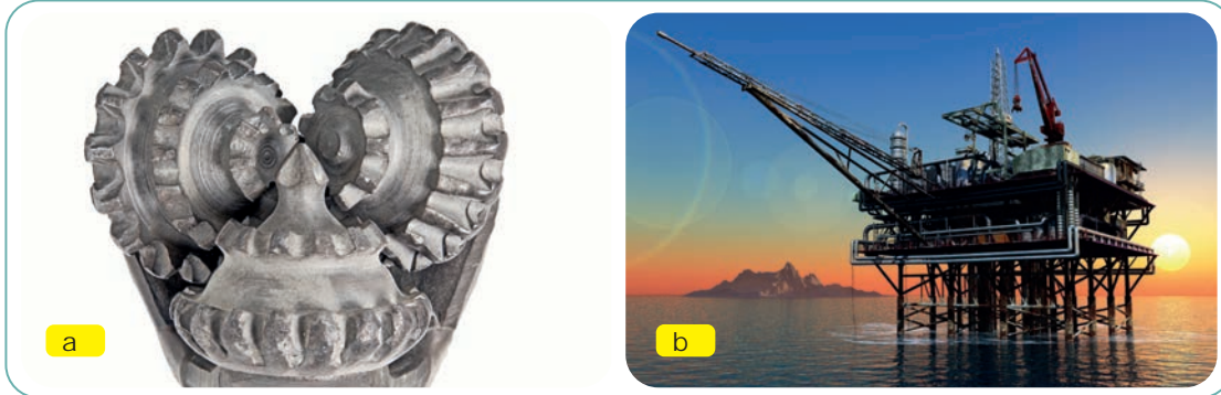
Görsel 6.18: Petrol ve doğal gaz çıkarmak için kullanılan delici kafa ve bunun çalıştığı kule
