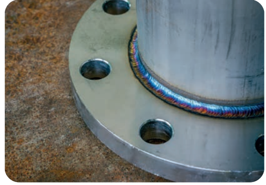
Görsel 2.17: Kaynakla birleştirilmiş flanş
