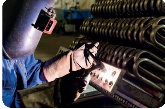
Görsel 5.25: Isı değiştiricinin TIG kaynağı
