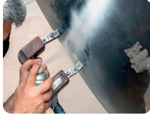
Görsel 3.8: Kaynak dikişinin manyetik kontrolü
