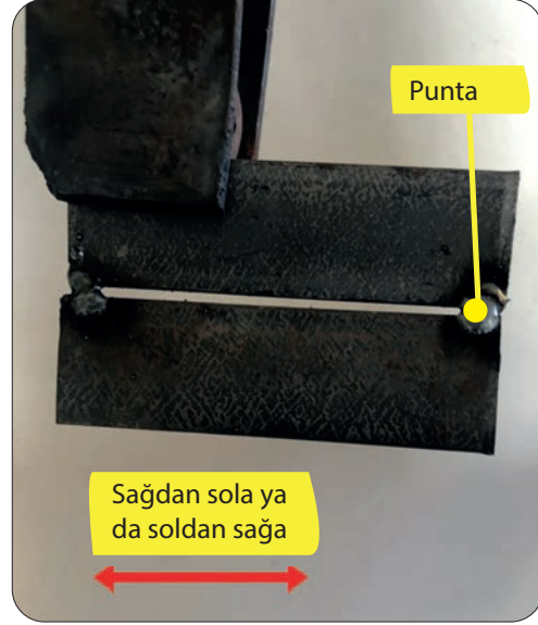
Görsel 2.6: Duvar kaynağı
