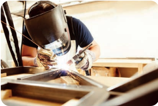
Görsel 5.4: TIG kaynağıyla profil kaynağı
