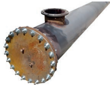
Görsel 2.13: Kör flanşla kapatılmış boru tesisatı
