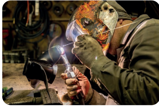
Görsel 5.29: Bakır döküm pervane onarımı
