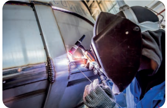
Görsel 5.13: TIG ile alaşımli çelik kaynağı
