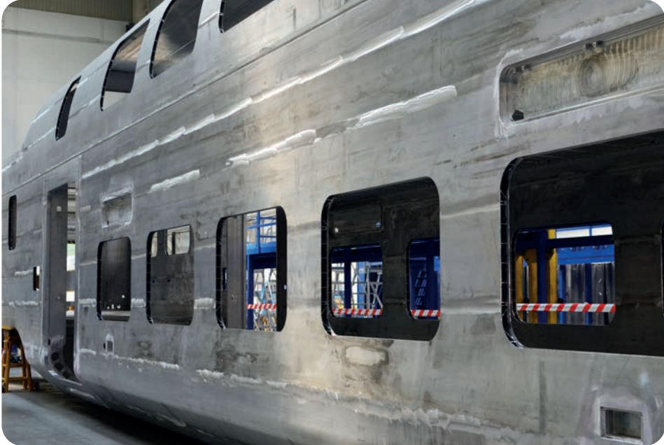
Görsel 6.8: Alüminyum kaynağıyla birleştirilmiş yüksek hızlı tren gövdesi
