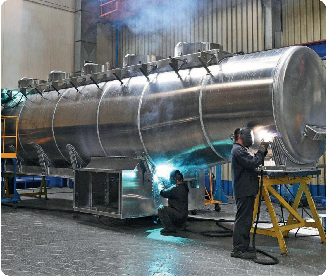
Görsel 4.1: Kaynak operatörlerinin değişik konumlarda kaynak gerçekleştirmesi
