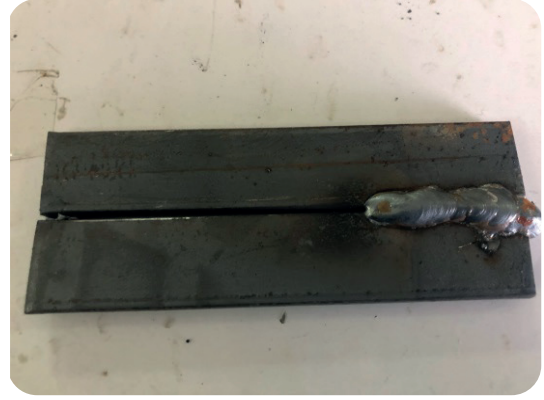
Görsel 1.18: Puntalanmış yüzeyin arkasına gazaltı kaynağı çekilmiş iş parçası
