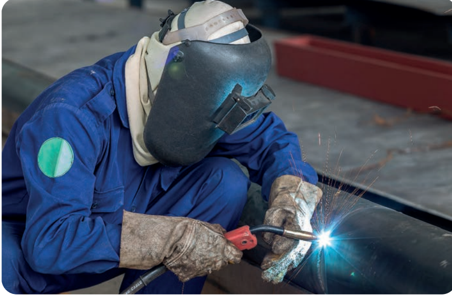
Görsel 6.3: MIG kaynak torcu ve kaynağı tarafından tutulması
