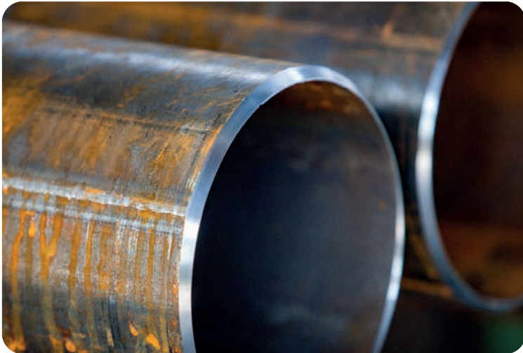
Görsel 7.4: Kaynak ağızı açılmış büyük çaplı borular
