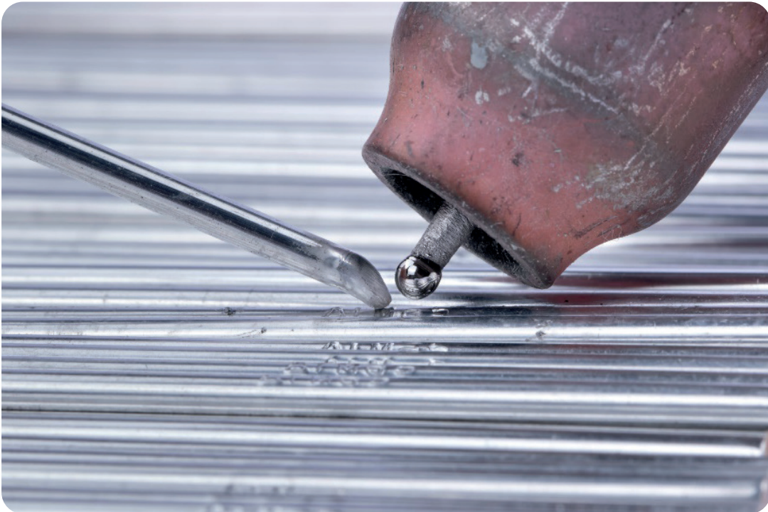
Görsel 5.3: Top hâline getirilmiş elektrot ile alüminyum kaynağı
