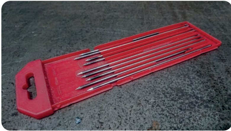
Görsel 5.2: TIG kaynağında kullanılan ve ergimediği varsayılan koruyucu kutusunda tungsten elektrotlar
