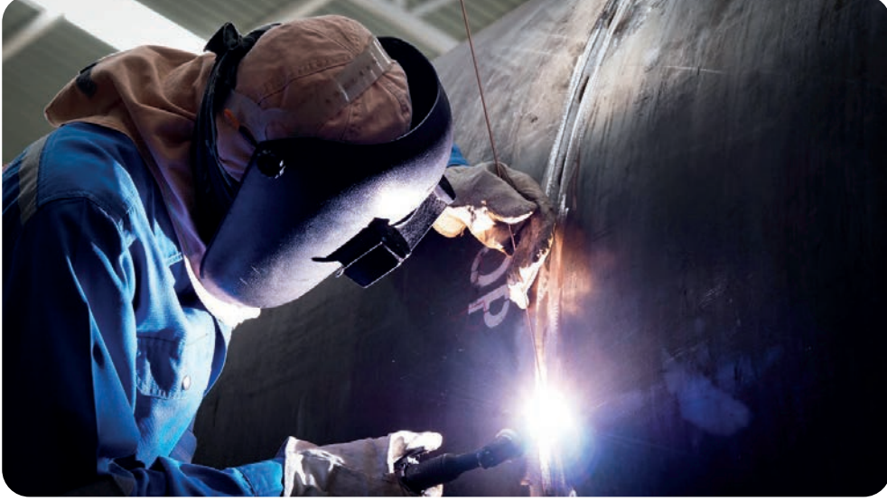
Görsel 7.10: TIG gaz korumalı sola kaynak çekme
