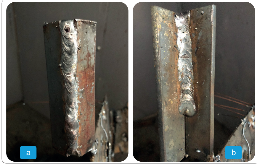
Görsel 4.5 a, b: Dik kaynak: aşağıdan yukarı dış köşe ve yukarıdan aşağıya iç köşe
