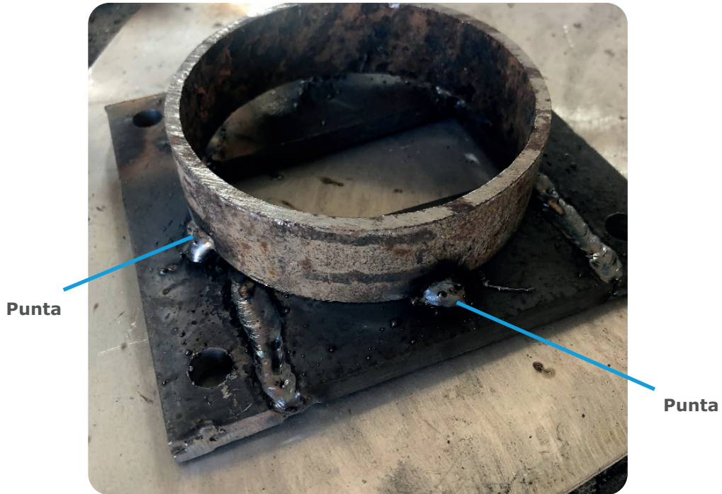
Görsel 2.9: Flanşın iş parçasına puntalanması
