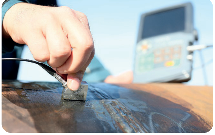
Görsel 7.15: Ultrasonik kontrolün yapılması
