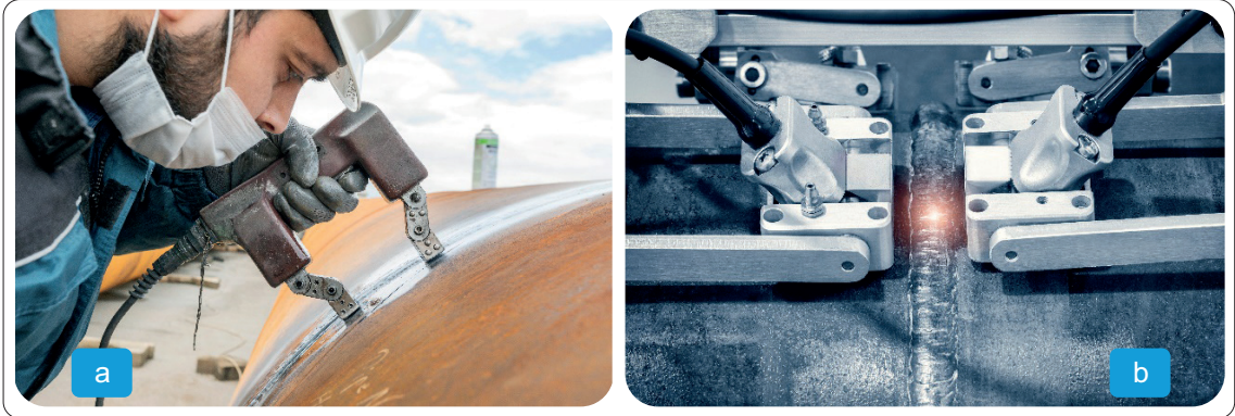
Görsel 7.13 a, b: Kaynak dikişinin manyetik ve ultrason ile kontrolü
