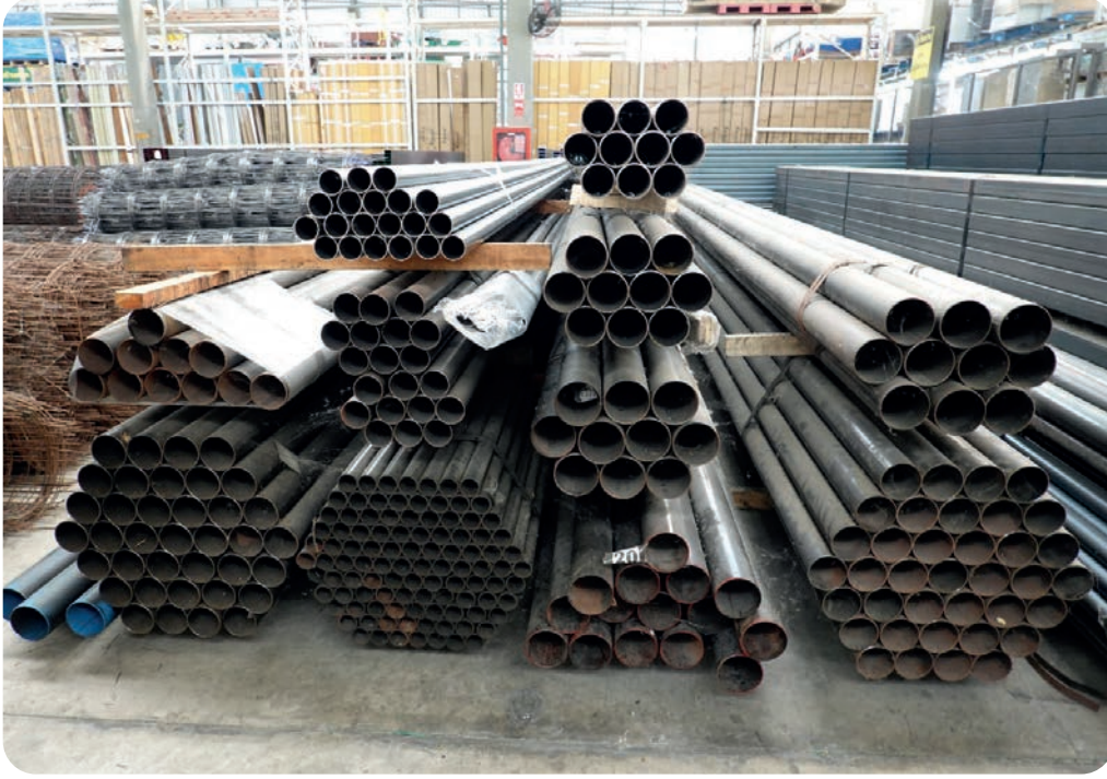
Görsel 3.1: Su ve sanayi boruları
