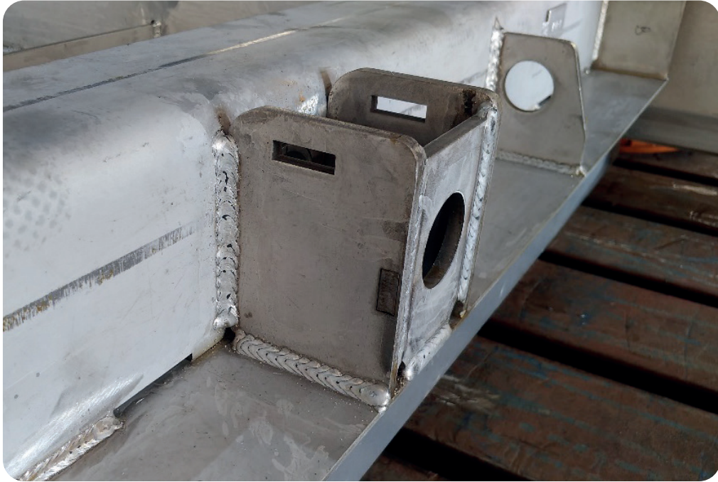
Görsel 1.17: Değişik konumlarda kaynak yapılmış iş parçası
