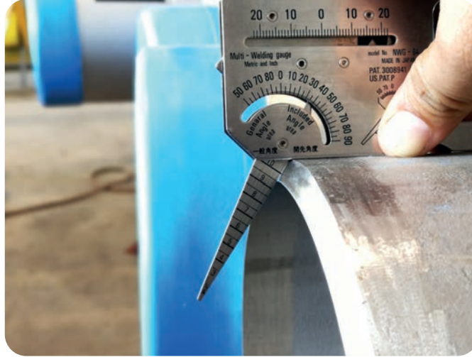
Görsel 3.7: Açılöçer ile kaynak ağızının kontrolü
