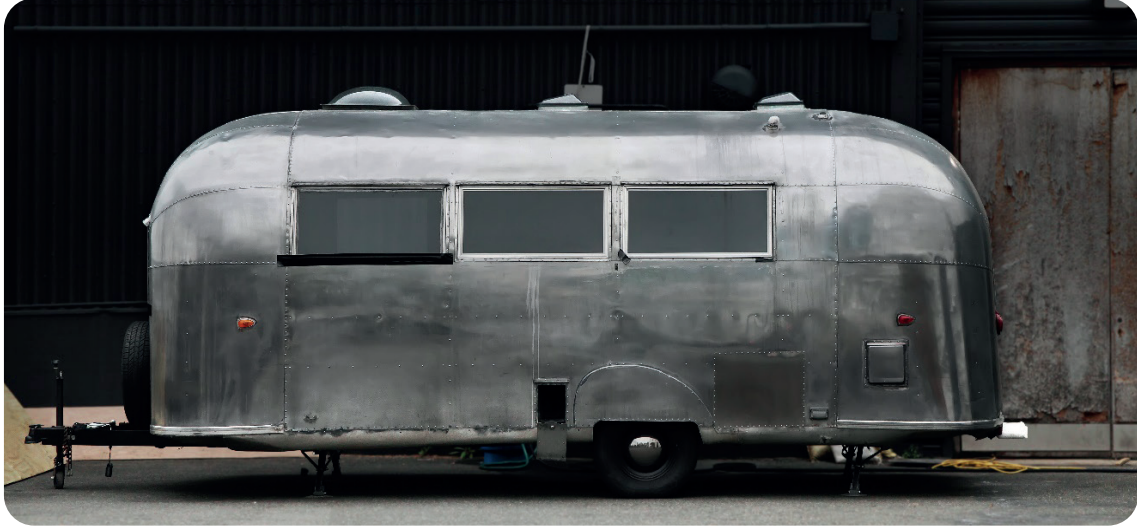
Görsel 6.6: Şasesinin yapımında MIG kaynağı kullanılmış alüminyumdun yapılmış karavan
