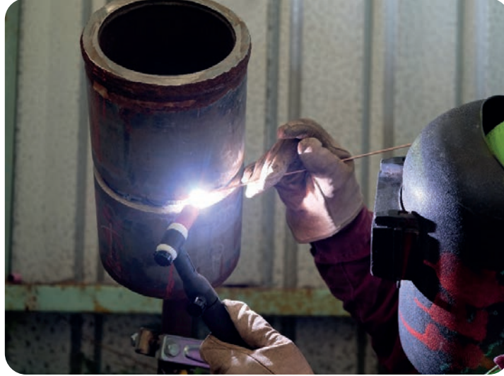
Görsel 7.8: Değişik konumlarda büyük çaplı TIG boru kaynağı
