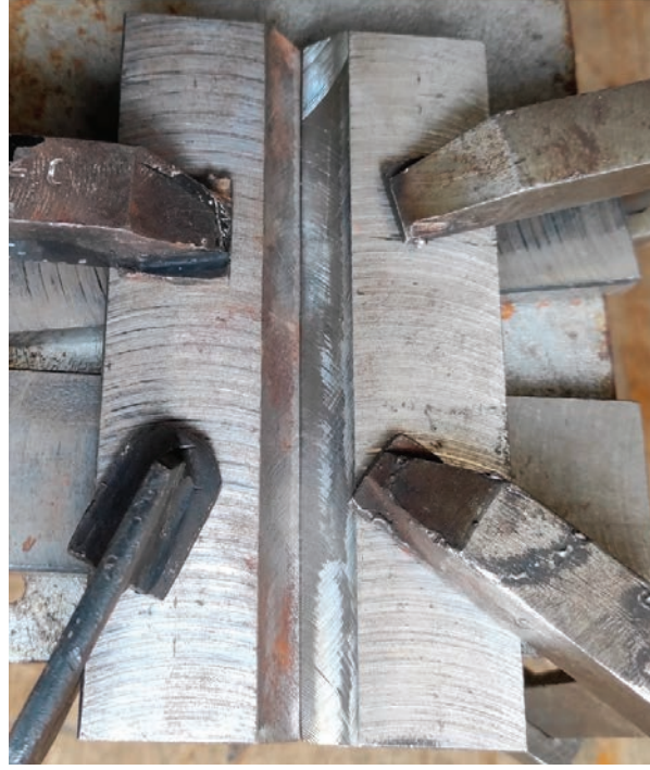
Görsel 1.7: Bir aparat kullanılarak kaynak çekmesinin önlenmesi
