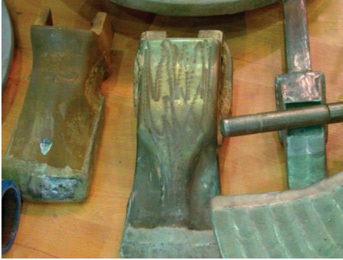
Görsel 8.4: Aşınmış parçaların kaynağı
