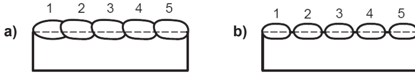
Şekil 2.1: Tek sıra yüzey dolgu kaynağı a) Yanlış b) Doğru
