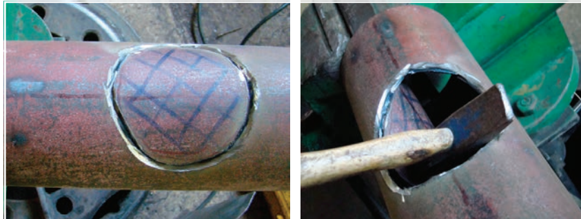
Görsel 9.21: Arakesitin talaş alma makinesi ile kesilmesi
