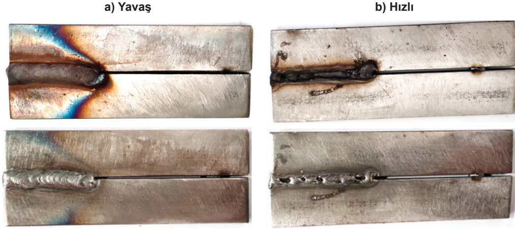
Görsel 5.7: Kaynak hızına göre cürufun banyoyu örtmesi
