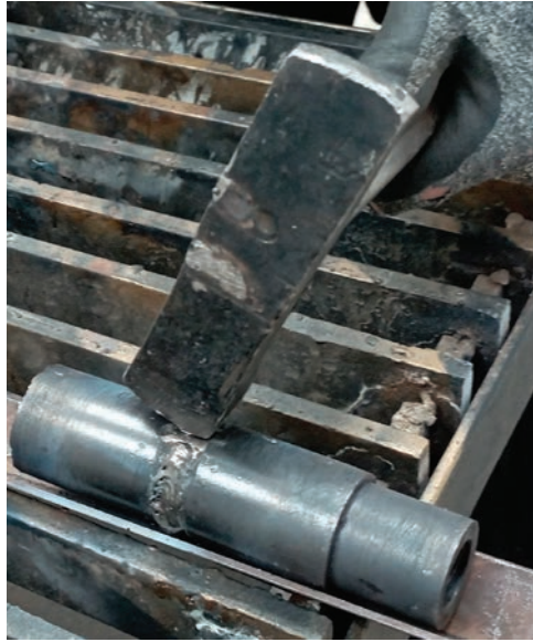
Görsel 6.5: Kaynağın çekiçlenmesi
