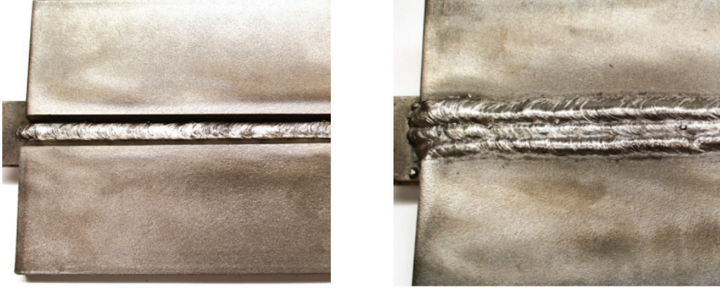
Görsel 4.2: Yan küt ek kaynağı uygulaması
