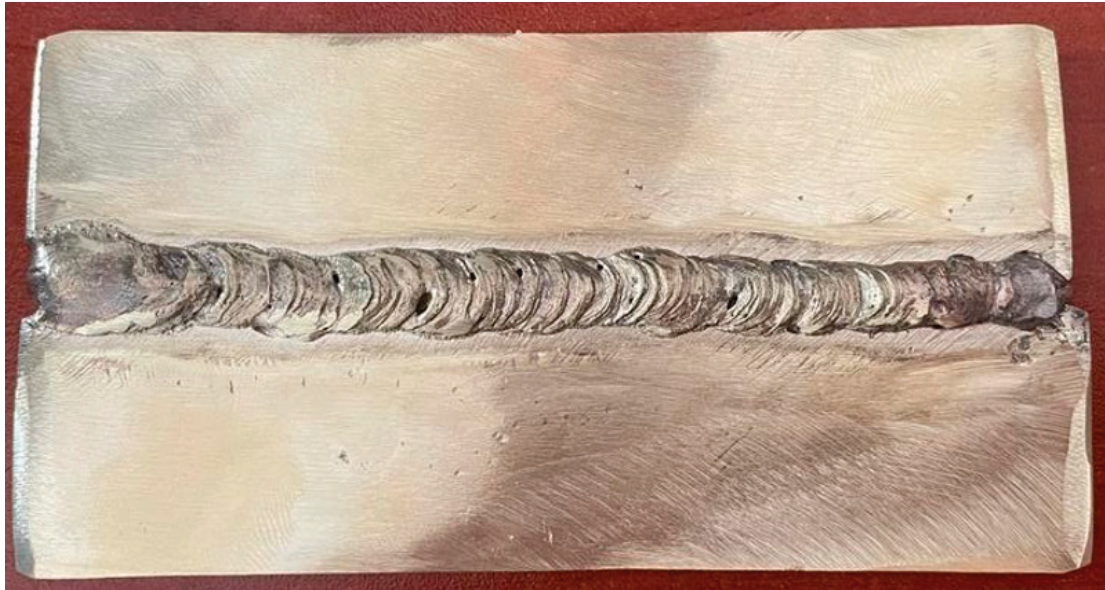
Görsel 7.9: Pirinç birleştirme kaynağı
