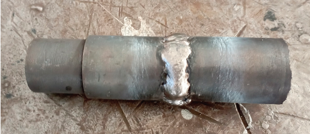
Görsel 6.7: Kırılmış dökme demir kaynağı
