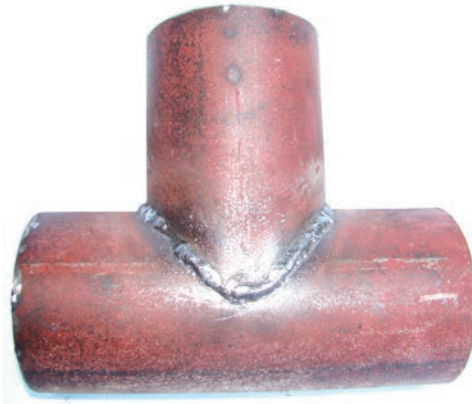
Görsel 9.23: Kurtağızı (T) alıştırılmış boruların kaynatılması
