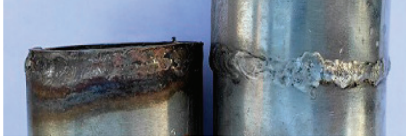
Görsel 8.1: Paslanmaz çelik kaynak metalinin oksitlenmesi
