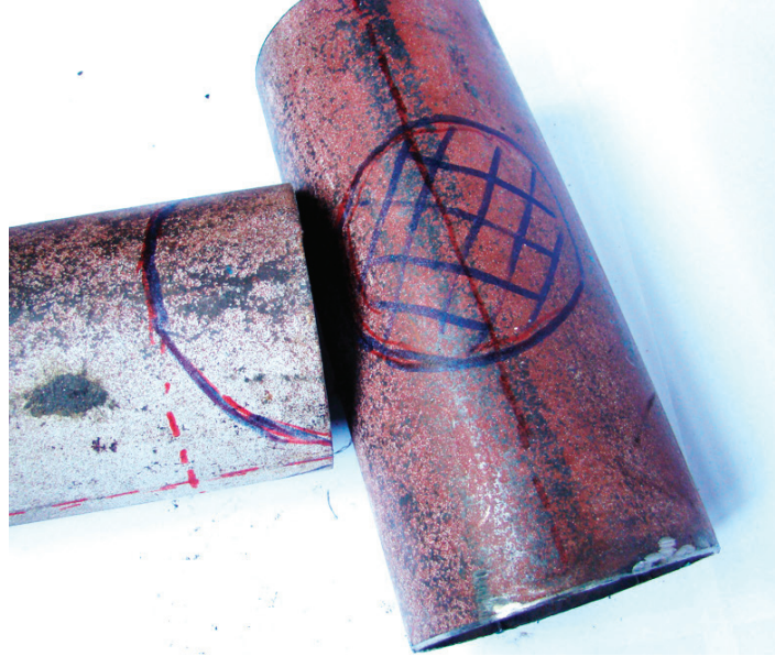
Görsel 9.19: Arakesit açılarak kurtatılmış ve parçalı dirsek yapılmış borular
