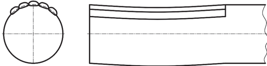
Şekil 2.7: Dolgu kaynağı tek taraftan yapılmış milde eğilme
