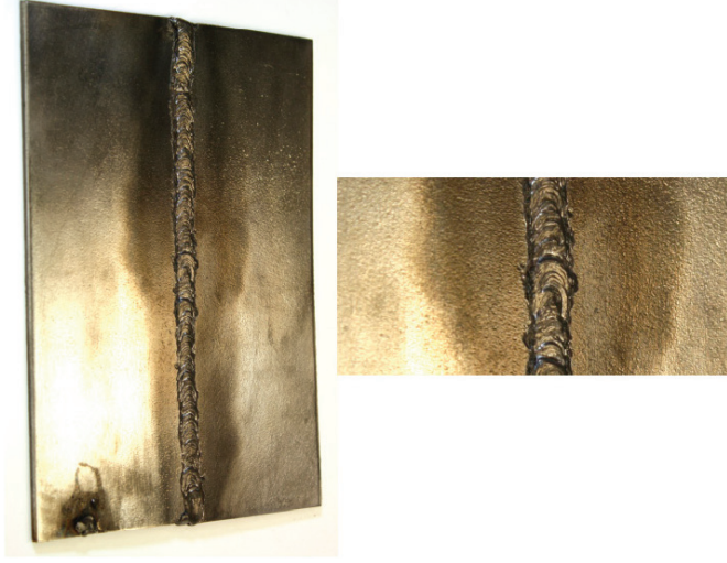
Görsel 3.2: Yukarıdan aşağıya kaynak çekilmiş sac parça
