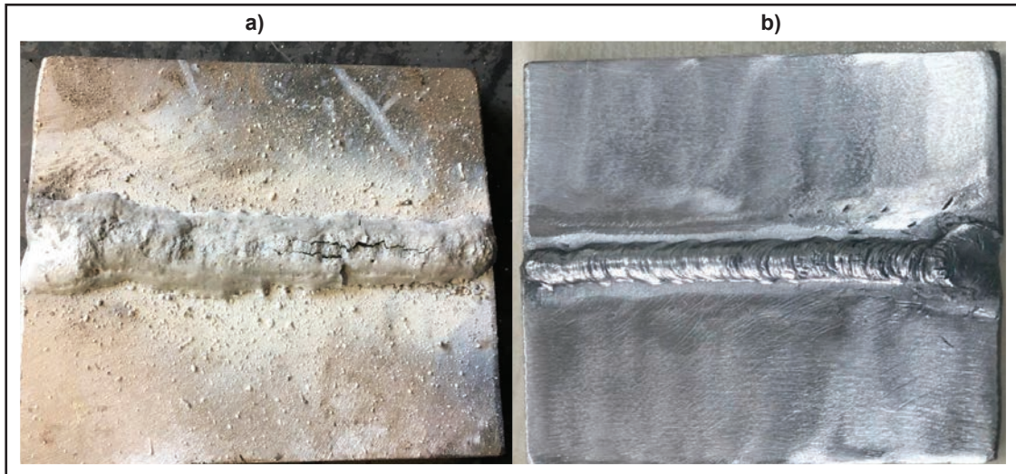
Görsel 7.15: Alüminyum kaynağında dikiş temizliği a) Cürufu temizlenmemiş b) Cürufu temizlenmiş
