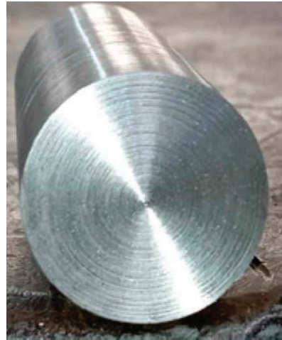
Görsel 2.6: Mil dolgu kaynağın yüzeyinden makine (torna) ile talaş alma
