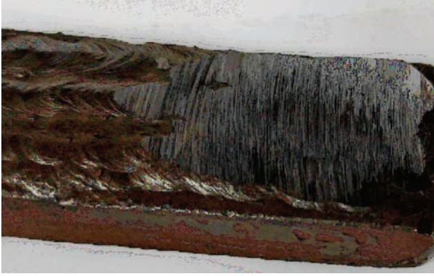
Görsel 2.1: Tek sıralı kaynağın yüzeyinden makine ile talaş alma
