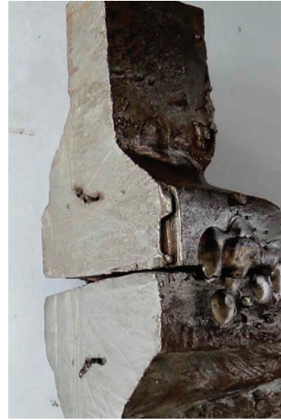
Görsel 1.10: "K" iç köşe kaynak ağzı kesit yüzeyini testere ile kesme
