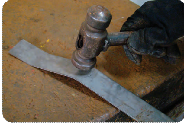
Görsel 4.3: Örs üzerinde sac düzeltme
