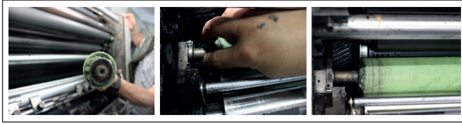
Görsel 2.41: Merdanenin ünitesine takılması
