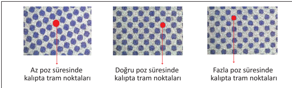
Görsel 1.15: Farklı pozlanmış kalıbın mikroskopik görüntüsü
