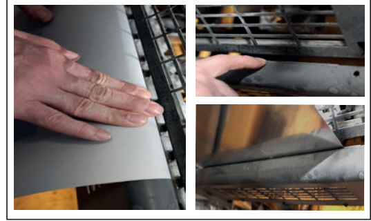
Görsel 5.11: Kalıbın etek tarafından kazana geçirilmesi
