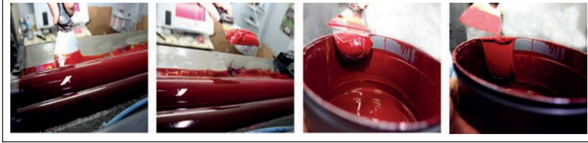
Görsel 4.29: Mürekkebin hazneden alınarak kutusuna aktarılması
