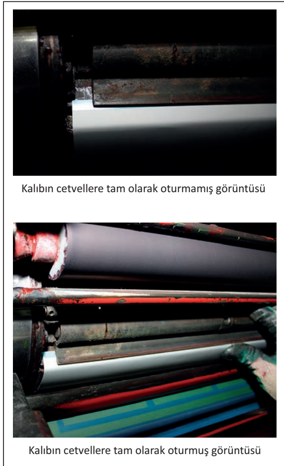
Görsel 5.16: Kalıbın cetvellere oturma ve oturmama şekli
