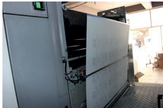
Görsel 4.2: Kalıp kazanına takılacak kalıp
