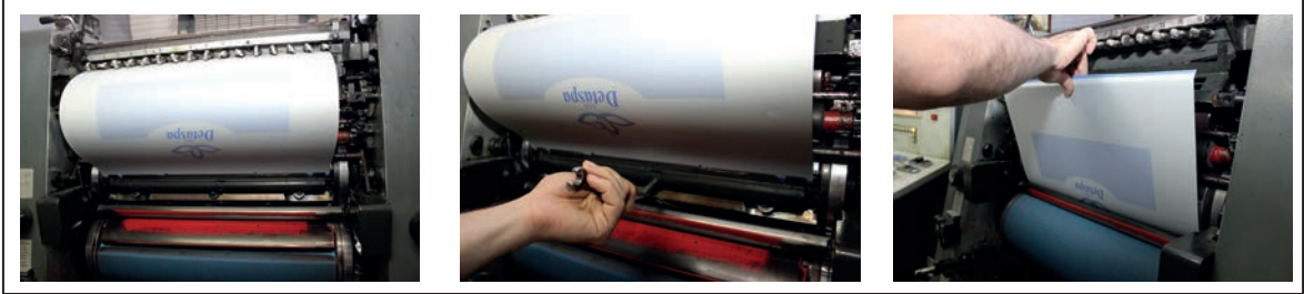
Görsel 5.15: Kalıbın makas tarafından tutturularak kazana sarılması
