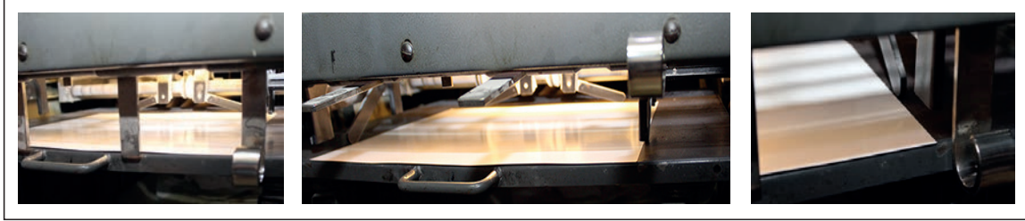
Görsel 6.34: Kâğıdın boyutuna göre sağ ve sol toplayıcıların ayarlanması
