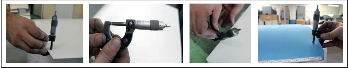
Görsel 6.101: Mikrometre ile kauçuk ve kauçuk altı beslemesinin ölçülmesi
