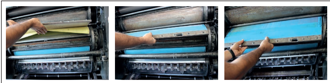
Görsel 5.30: Kauçuğun sökülmesi
