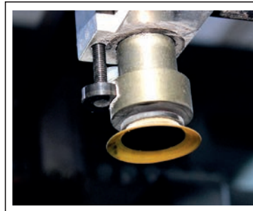
Görsel 3.28: Taşıyıcı vantuzun makinedeki görünümü
