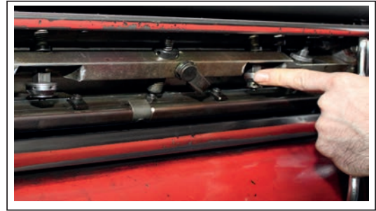
Görsel 5.12: Gergi vidalarının boşluğunun el ile alınması
