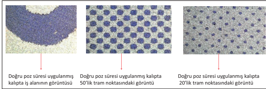
Görsel 1.14: Doğru pozlanmış kalıbın mikroskopik görüntüsü
