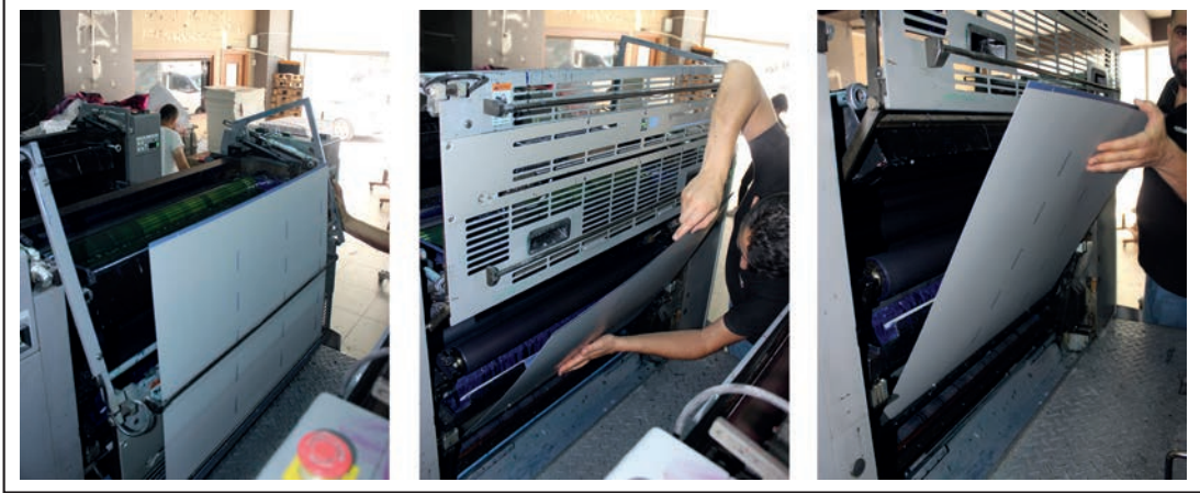
Görsel 4.5: Basılacak kalıpların makineye takılması
