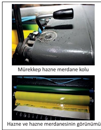
Görsel 2.18 : Hazne merdanesi kolu ve mürekkebin haznedeki görünümü
