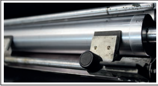
Görsel 2.36: Hazne merdanesi ve üzerinde bulunan sıyrıcı
