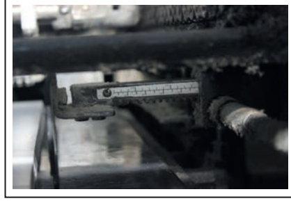
Görsel 3.18: Giriş asansöründe kâğıt ortasını gösteren düzenek
