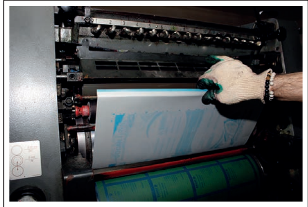
Görsel 5.9: Kalıbın çıkarılması
