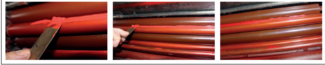
Görsel 6.63: Mürekkep ünitesi ve bu üniteye mürekkep verilmesi
