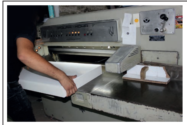
Görsel 4.7: Tabakaların giyotinde kesilmesi
