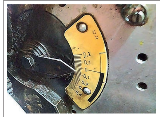
Görsel 5.36: Makine üzerinde forsa ayar kolu
