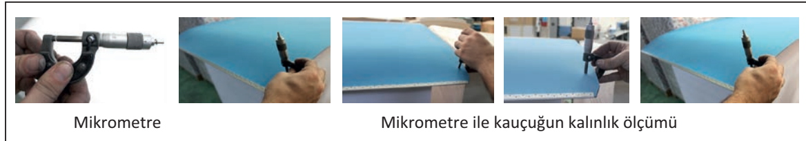
Görsel 5.21: Kauçuğun mikrometre ile ölçülmesi
