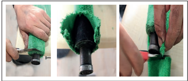
Görsel 2.46: Merdane üzerindeki kılıfın sökülmesi
