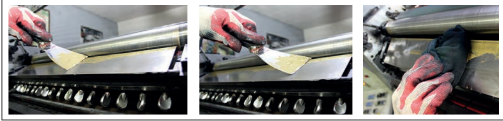
Görsel 6.24: Haznedeki mürekkebin alınması
