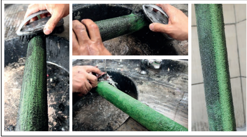
Görsel 2.39: Merdane kılıfının temizlenmesi
