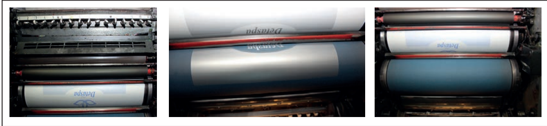
Görsel 6.22: Kalıp ve kauçuktaki mürekkepli görüntü
