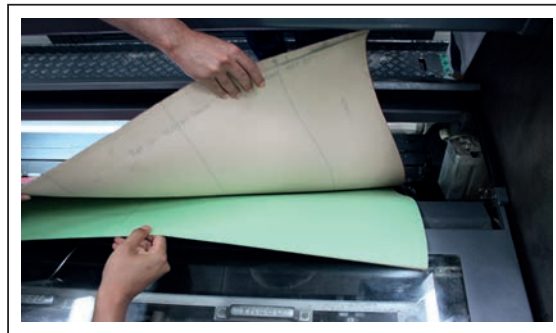
Görsel 5.25: Kauçuk ve kauçuk altı beslemesi
