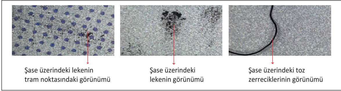
Görsel 1.16: Şase üzerindeki toz ve lekelerin kalıptaki mikroskobik görüntüsü
