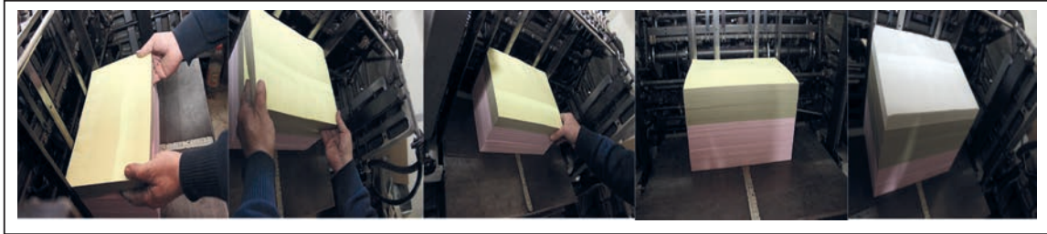
Görsel 3.49: Tablaya altlık yapma ve üzerine kâğıt yerleştirilmesi
