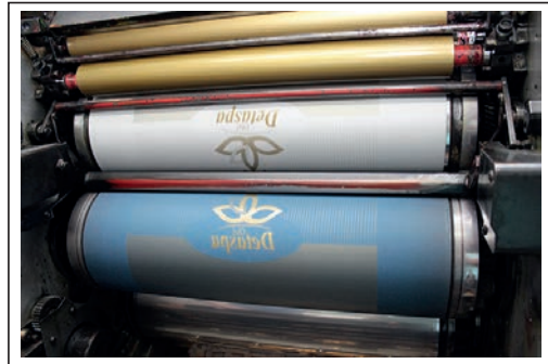
Görsel 6.38: Kalıp ve kauçukta mürekkepli görüntü
