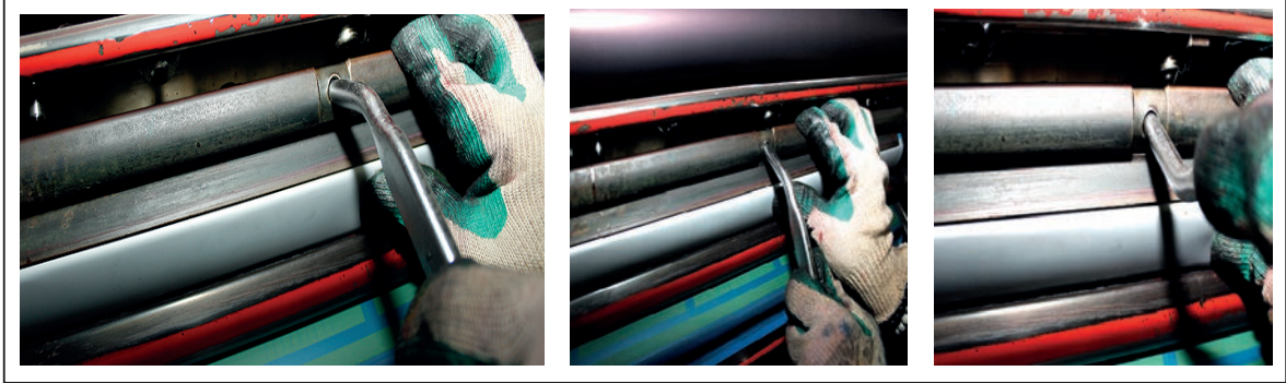
Görsel 5.8: Kalıbın gevşetilmesi
