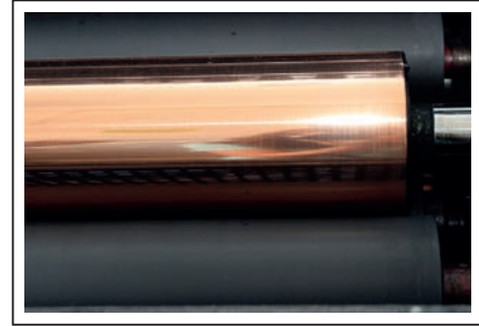
Görsel 2.37: Alkol nemlendirme sistemi merdaneleri
