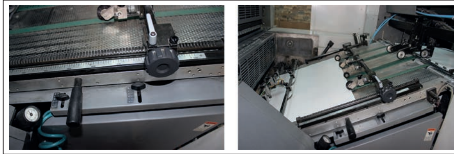
Görsel 4.12: Fırça ve tekerleklerin bulunduğu şeridin kâğıt ebadına göre ayarlanması
