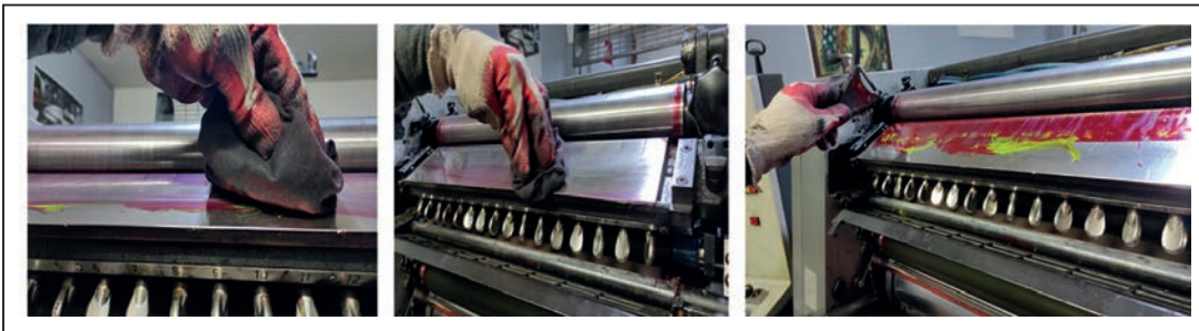
Görsel 4.38: Haznenin temizlenmesi
