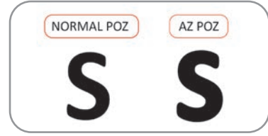
Şekil 2.8: Az poz sonucu şişme oluşması
