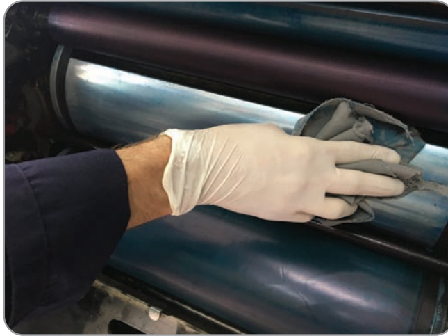
Görsel 5.59: Kalıbın fiksere ile silinmesi
