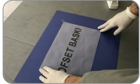
Görsel 2.5: Aydingerin kalıp üzerine yapıştırılması
