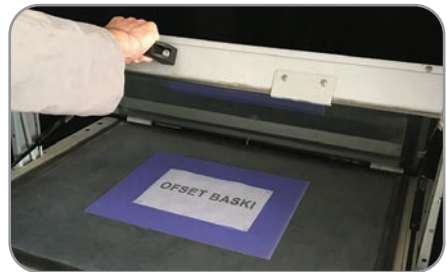
Görsel 2.6: Kalıbın şaseye yerleştirilmesi
