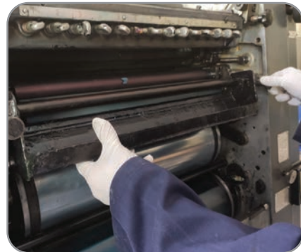
Görsel 5.65: Temizleme raglesinin sökülmesi
