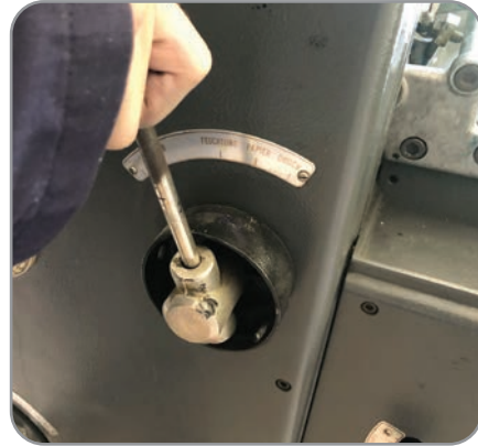
Görsel 6.25: Nemlendirme merdanelerinin kalıba temas ettirilmesi
