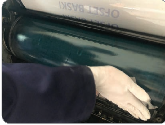
Görsel 5.60: Blanketin temizlenmesi
