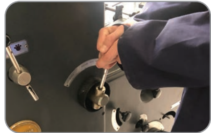
Görsel 5.43: Nemlendirme merdanelerinin kalıba temas ettirilmesi
