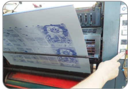
Görsel 3.11: Kalıbın makas yönünden takılması
