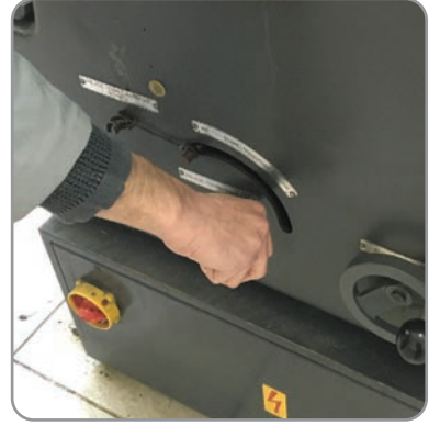
Görsel 4.21: Çıkış asansörü tablasının yükseltilmesi
