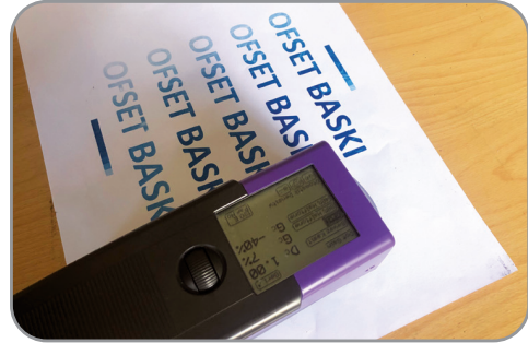
Görsel 6.12: Spektrofotometrenin kalibre edilmesi
