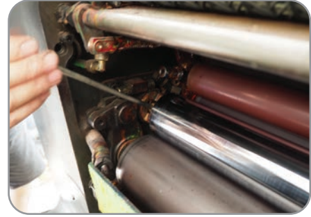
Görsel 3.20: Merdanelerin yuvalarına takılması
