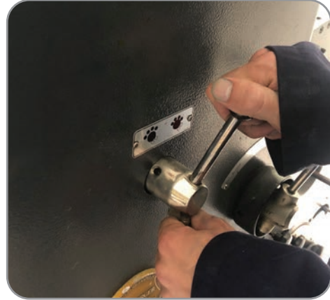
Görsel 6.6: Mürekkep merdanelerinin kalıba temas ettirilmesi
