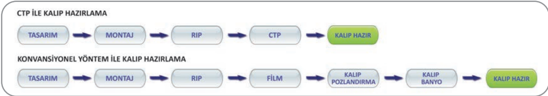
Şema 2.1: Konvansiyonel Yöntem ve CTP İle Kalıp Hazırlama
