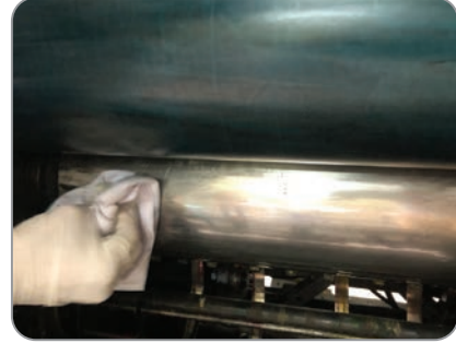
Görsel 5.61: Baskı kazanının temizlenmesi
