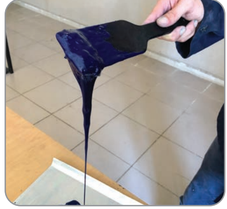
Görsel 6.20: Mürekkebin viskozitesinin ayarlanması
