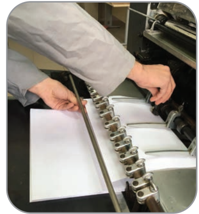
Görsel 4.28: Kâğıdın tabla ile kontak arasına yerleştirilmesi
