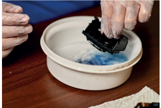
Görsel 2.40: Daldırma yöntemiyle kafa temizliği
