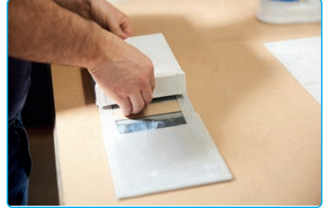
Görsel 3.27: İç blokla sert kapağın birleştirilmesi
