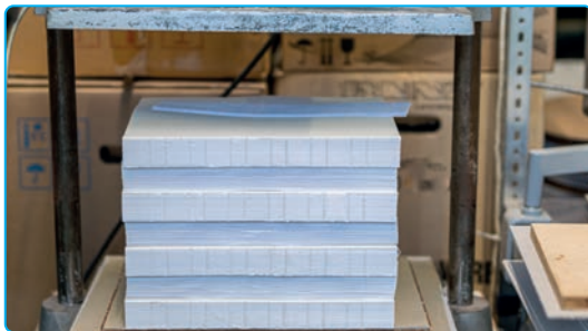
Görsel 2.5: Sırtı tutkallanan iç blokların prese konulması
