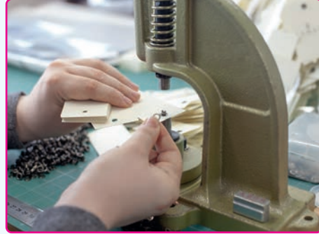
Görsel 3.61: Pulun yerleştirilmesi
