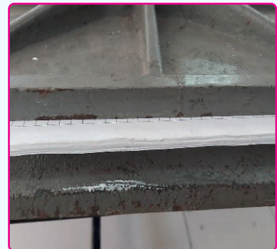
Görsel 6.26: Tutkallanan kâğıt bloğunun preste bekletilmesi
