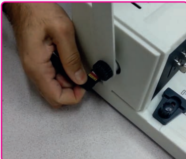
Görsel 6.10: Deliklerin sırta olan uzaklığının ayarlanması
