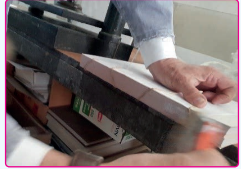
Görsel 1.57: Sicim geçirilmiş kâğıt bloğunun tutkallanması
