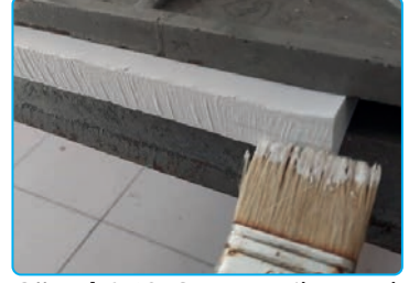
Görsel 6.19: Sırt çentik açarak tutkal sürme
