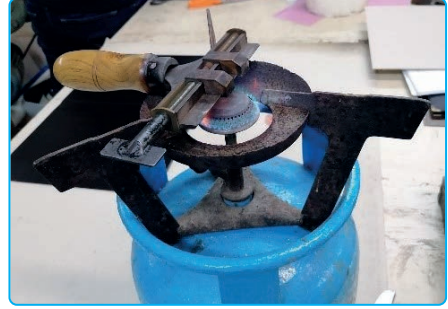
Görsel 4.8: Kumpasın ısıtılması
