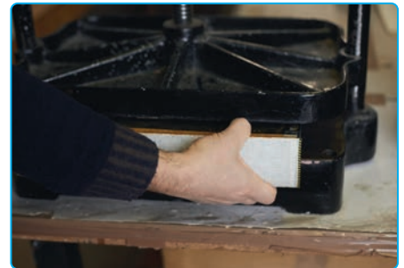
Görsel 2.25: Sırtına tela yapıştırılmış bir iç blok
