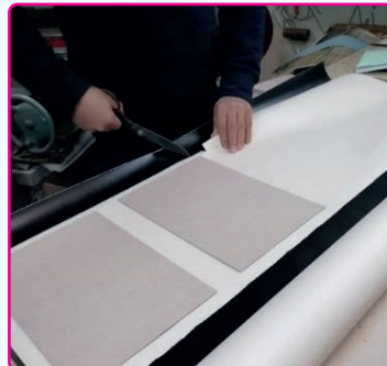
Görsel 3.30: Kaplama malzemesinin kesilmesi
