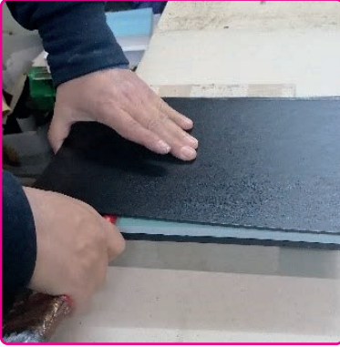
Görsel 3.52: Kapağın iç blok üzerine yapıştırılması
