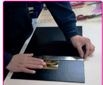
Görsel 4.16: Yaldızın kapak üzerine yerleştirilmesi
