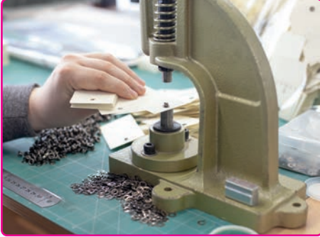
Görsel 3.60: Malzemenin kuşgözünün üzerine yerleştirilmesi
