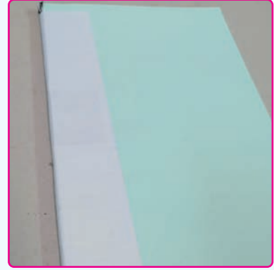
Görsel 2.31: Sırt kâğıdı, şirazesi ve kurdelesini yapıştırılmış iç blok
