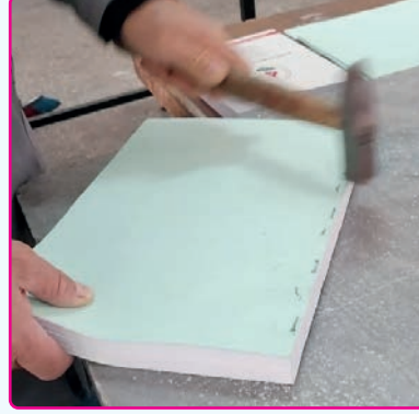
Görsel 1.69: Tellerin çekiçle düzeltilmesi
