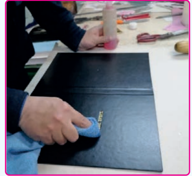
Görsel 4.19: Badem yağı ile temizlenmesi
