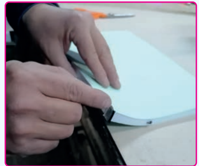
Görsel 2.28: Şirazenin yapıştırılması
