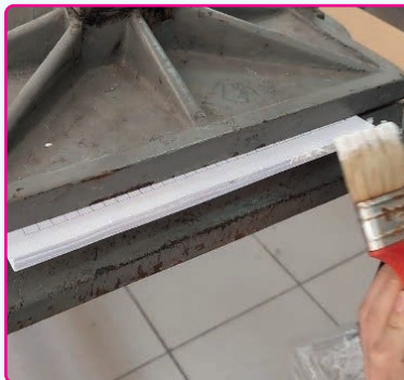
Görsel 6.25: Kâğıt bloğunun preste tutkalanması
