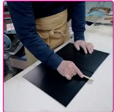
Görsel 3.36: ıstaka ile düzeltme
