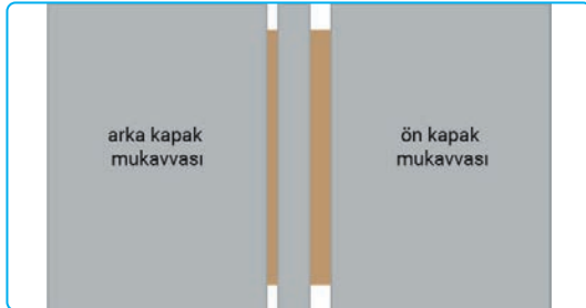
Görsel 3.17: Muhat aralıklarının eşit bırakılmaması
