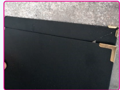
Görsel 4.44: Köşebent takılmış kapak
