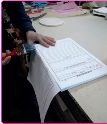
Görsel 2.14: İlk ve son sayfaların sırtta yakın kısmının tutkallanması
