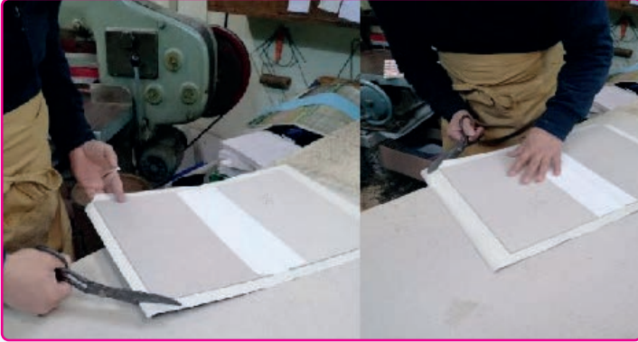
Görsel 3.32: Kaplama malzemesinin köşelerinin kesilmesi
