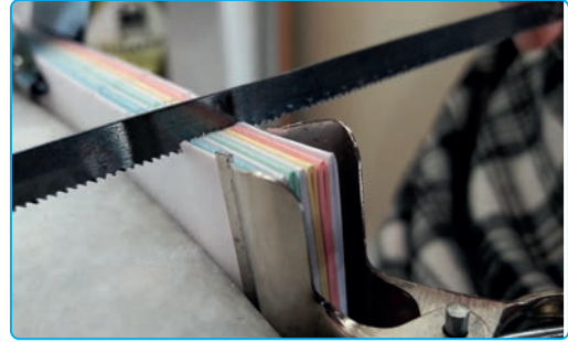
Görsel 1.17: Formalara testere ile çentik açılması
