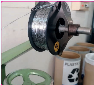
Görsel 1.66: Makineye zımba telinin takılması
