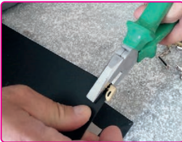
Görsel 4.42: Köşebenti pense ile sıkıştırma
