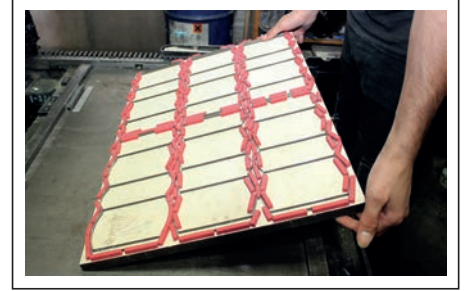
Görsel 2.26: Kalıbın kalıp şasesine yerleştirilmesi
