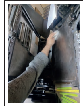
Görsel 3.49: Kalıp kazanının silinmesi
