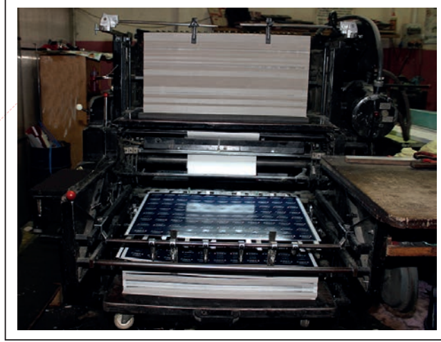
Görsel 1.7: Kazanlı tipo baskı makinesi
