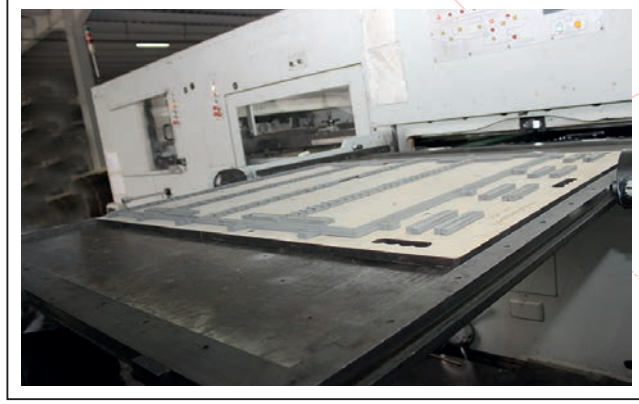
Görsel 1.52: Kalıp takılı hızlı çoklu kesim makinesi
