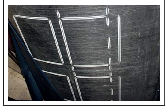
Görsel 2.54: Baskı kazanı üzerinde karşı kalıp
