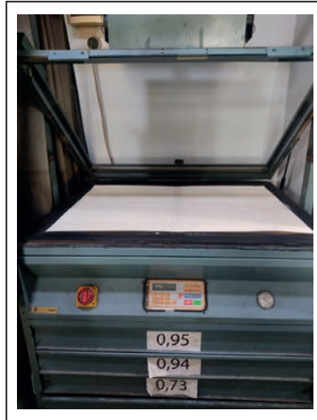
Görsel 3.8: Kalıp pozlandırma makinesi
