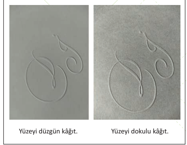
Görsel 3.45: Yüzeyi düzgün ve dokulu kâğıtlarda gofre baskı
