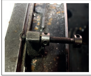
Görsel 2.25: Kalıbı gevşeten mekanizma ve kalıbın gevşetilmesi
