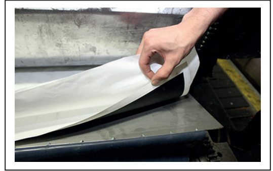
Görsel 2.36: Kazanlı tipo baskı makinesinde besleme kâğıdı
