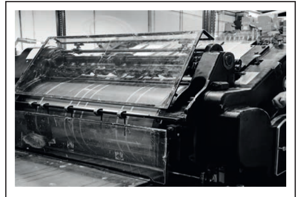
Görsel 3.4: Silindir kazanlı tipo baskı makinesi
