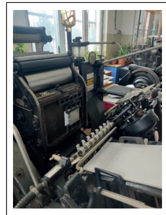
Görsel 3.66: Kâğıtların pozaya yerleştirilmesi
