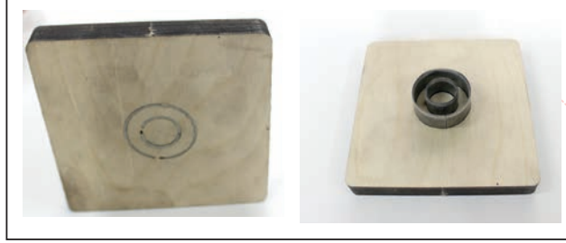
Görsel 1.53: Metal kesim kalıbı ve çember
