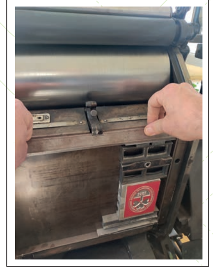
Görsel 3.64: Kalıbın kontrol edilmesi
