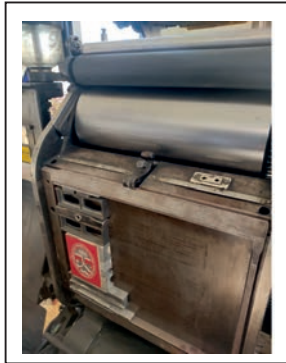
Görsel 3.63: Kalıbın kalıp kazanına takılması
