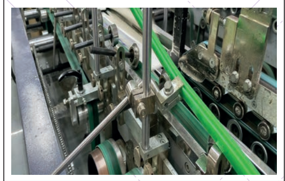
Görsel 4.38: Ön katlama ünitesi poliamid rehber ayarı
