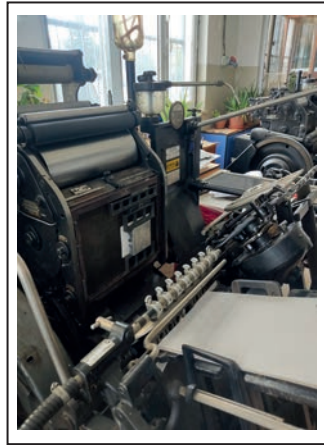
Görsel 3.82: Kâğıtların giriş asansörüne yerleştirilmesi
