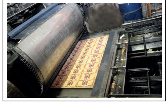
Görsel 2.29: Kalıbın kalıp kazanına takılması
