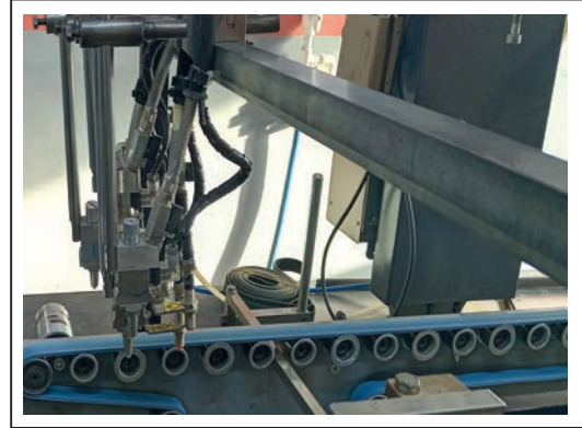
Görsel 4.14: Püskürtme sistemli tutkal sürme aparatı
