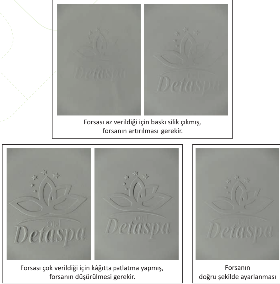
Görsel 3.87: Prova baskıya göre forsa ayarının yapılması
