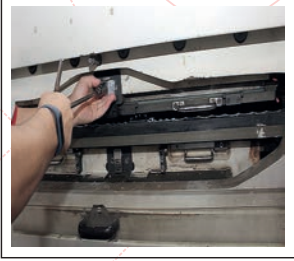
Görsel 1.57: Makinede kalıp şasesinin açılması
