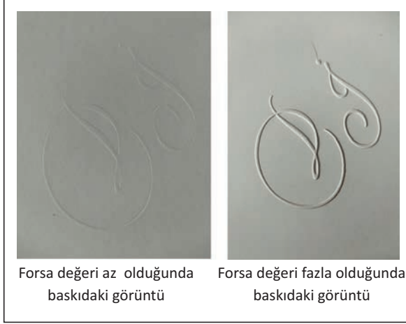
Görsel 3.44: Forsa değerinin az veya fazla verilmesi durumunda gofre baskı
