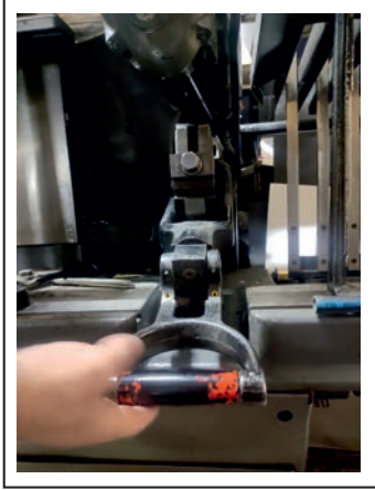
Görsel 3.50: Forsa kolunun çekilmesi Görsel 3.51: Erkek klişenin kalıp kazanına yapışması
