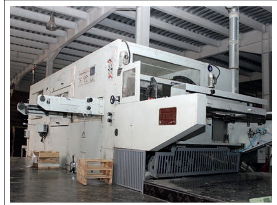
Görsel 1.8: Kesme, ayıklama ve ayırma işlemi yapan makine
