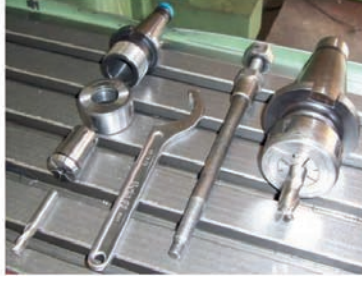
Görsel 5.20 Parmak freze çakısının pense takılması
