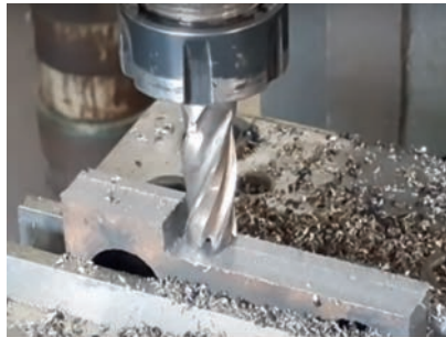
Görsel 5.25: Düzlem yüzey frezeleme
