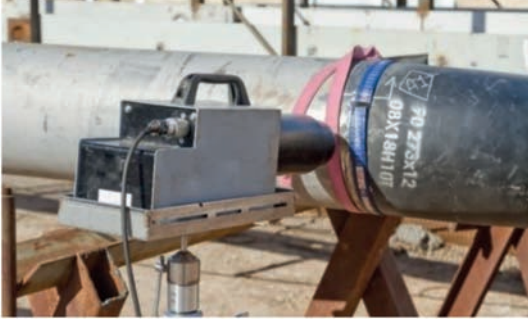
Görsel 2.9: Işın yöntemi (radyografik) testi
