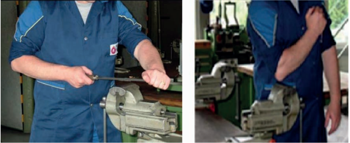
Görsel 1.38: Mengenede çalışma pozisyonu ve mengine yüksekliğinin ayarlanması
