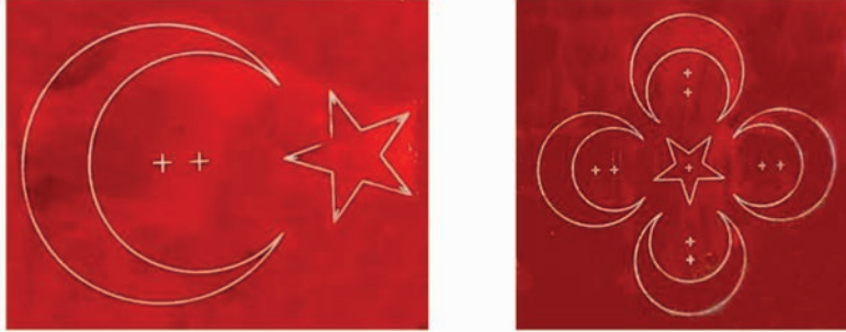
Görsel 1.65: Lazer markalama yapılmış iş parçası örnekleri
