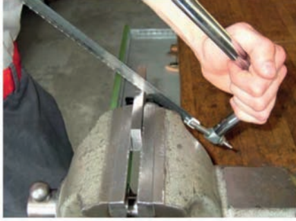
c. Testerenin hatalı olarak dik tutulması
