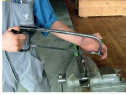
b. Testerenin eğik ağızlatılması
