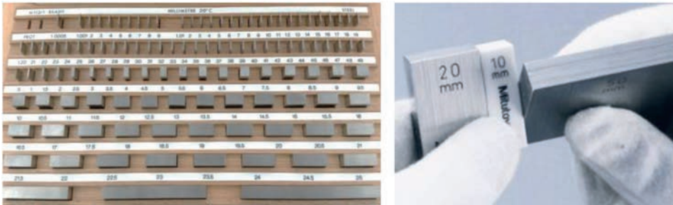
Görsel 1.28: Johnson masterı takımı ve masterların sökülmesi
