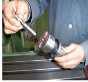
Görsel 5.20 Parmak freze çakısının pense takılması
