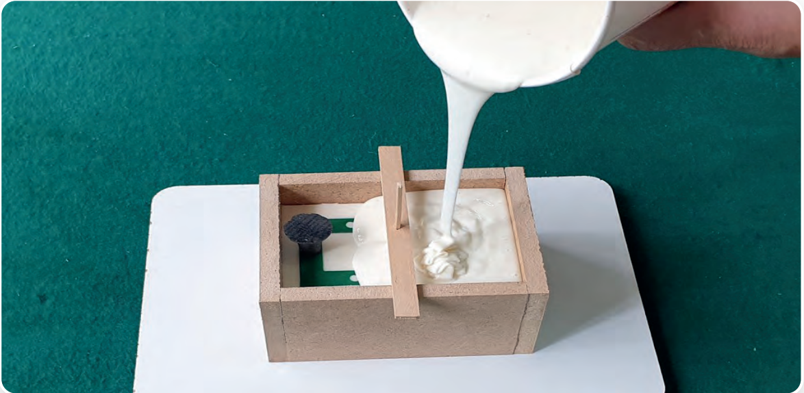
Görsel 2.26: Silikonun model üzerine dökülmesi
