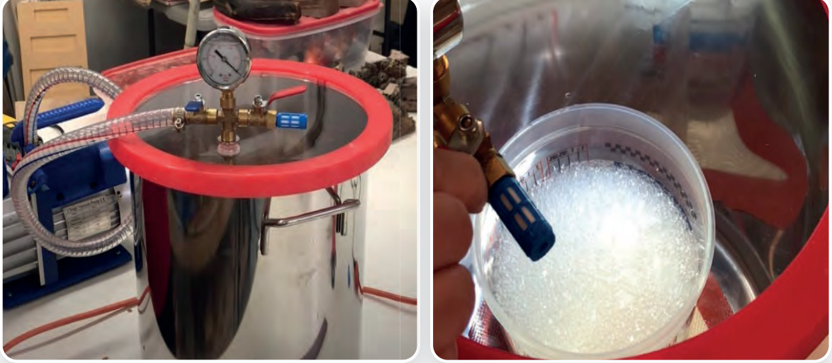
Görsel 2.25: İçerisindeki kabarcıklardan kurtulmak için silikonun desikatöre yerleştirilmesi
