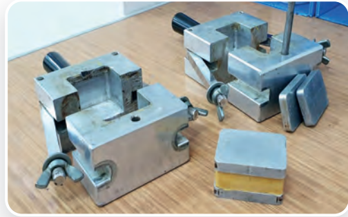
Görsel 2.3: Pişirme kalıpları
