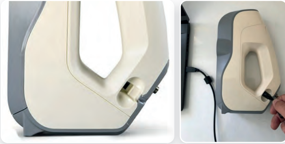
Görsel 1.20: Veri kablolarının bağlanması
