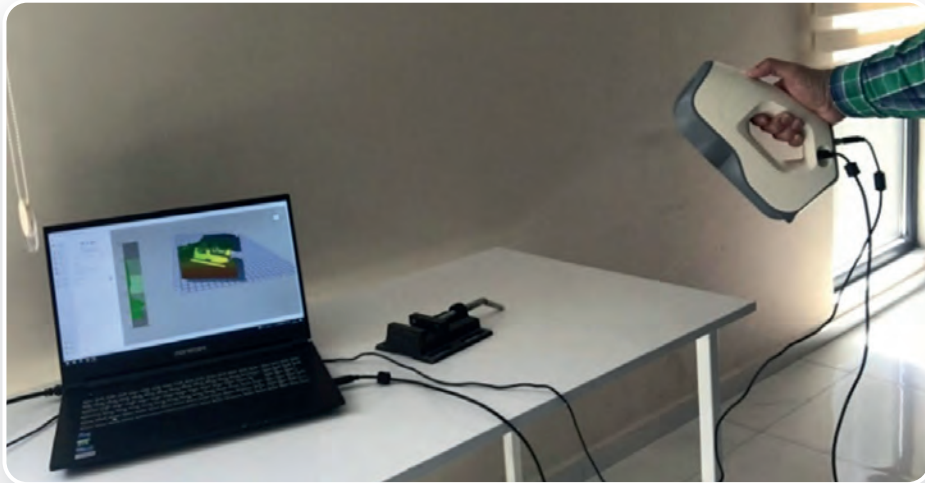
Görsel 1.35: Cihazın parça yüzeyini görecek şekilde hareket ettirilmesi
