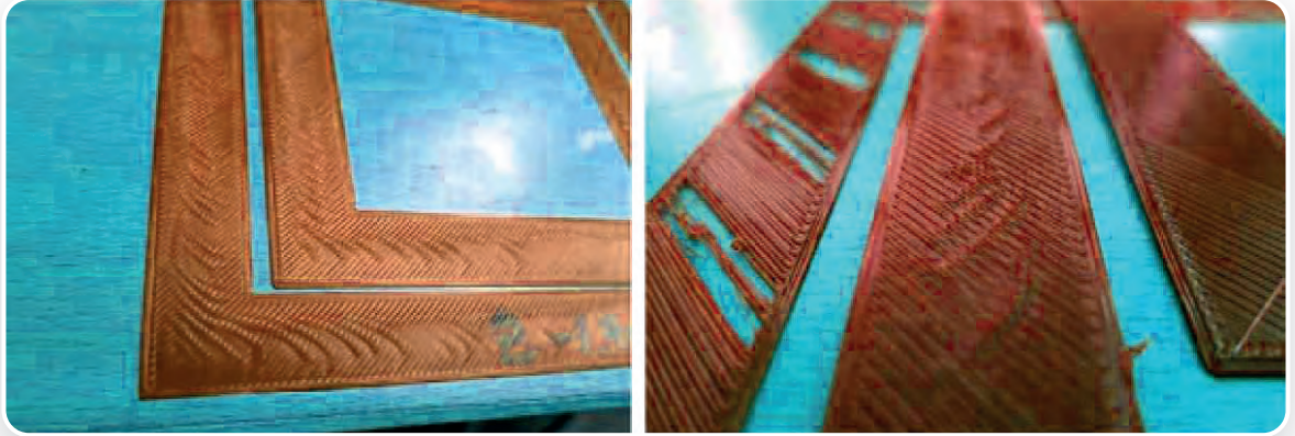
Görsel 4.23: Filament akış hatası
