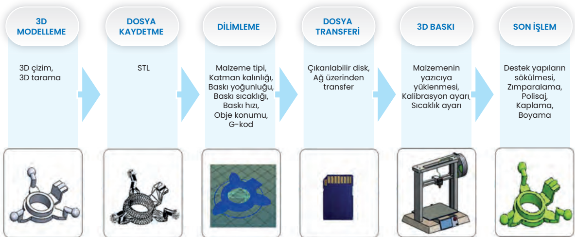
Görsel 4.1: Katmanlı imalat adımları
