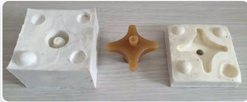
Görsel 3.6: Silikon malzemeden yapılmış mum model kalıbı
