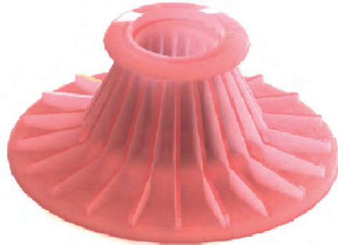
Görsel 3.4: 3D yazıcıda üretilmiş mum modelleme
