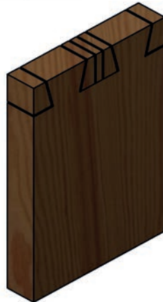
Görsel 1.13: 2 numaralı parçanın marka çizgisine göre kesilmesi
