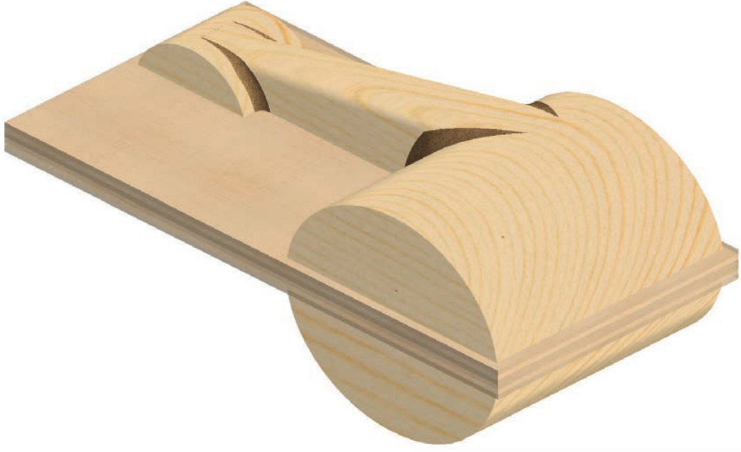
Görsel 5.12: A, B ve C parçalarının kontrplak üzerindeki yerlerine yerleştirilmesi ve kavilerin oluşturulması
