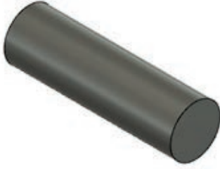
Ø12 mm x 40 mm silindirik malzeme (Ç1040)
