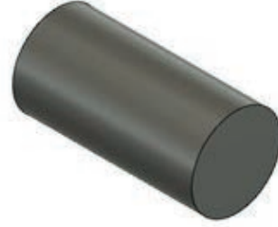
Ø20 mm x 40 mm silindirik malzeme (Ç1040)
