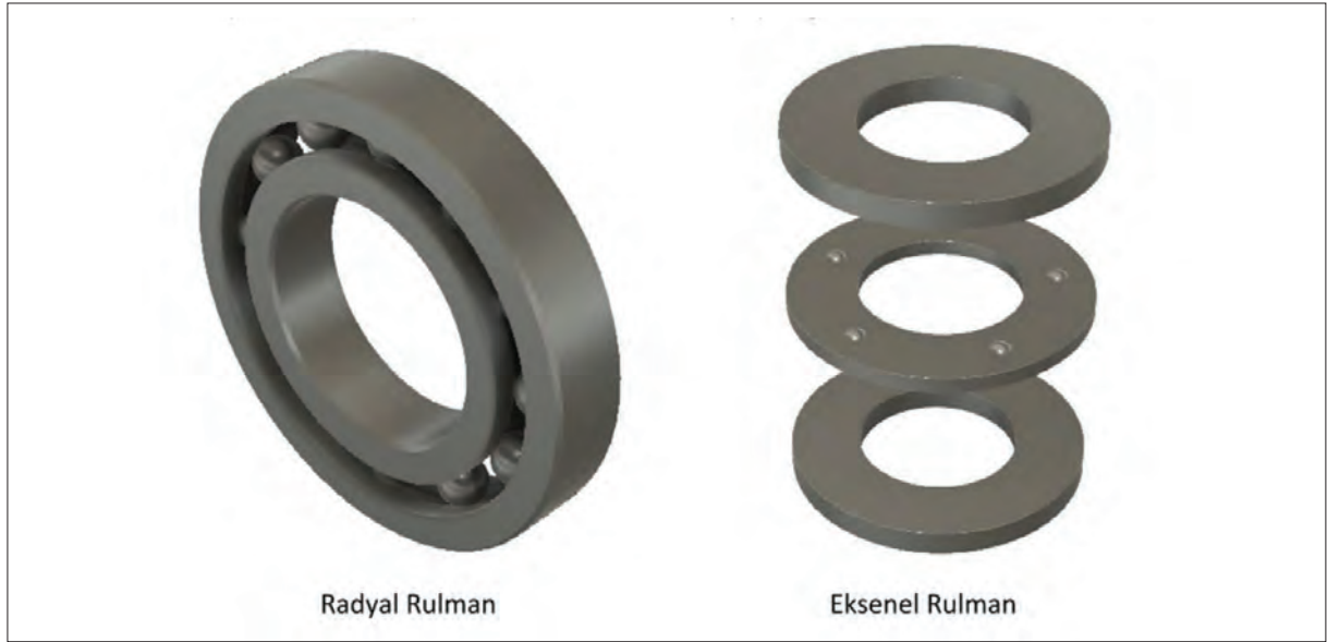
Görsel 4.9: Radyal ve aksel rulmanların yapısı
