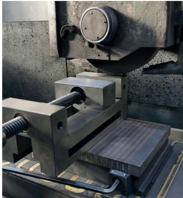
Görsel 7.3: Mengene ile iş parçasının bağlanması
