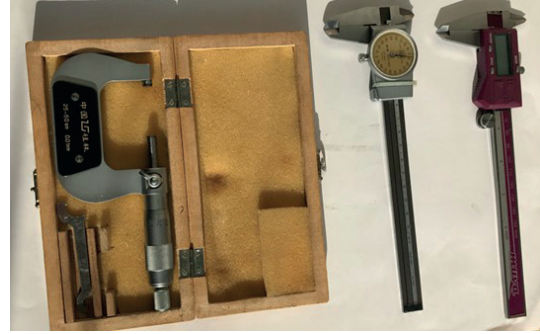
Görsel 1.23: Mikrometre, saatli kumpas ve dijital kumpas
