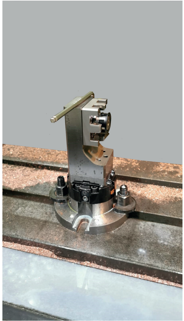
Görsel 7.5: Tablaya bağlama kalıplarıyla iş parçasının bağlanması
