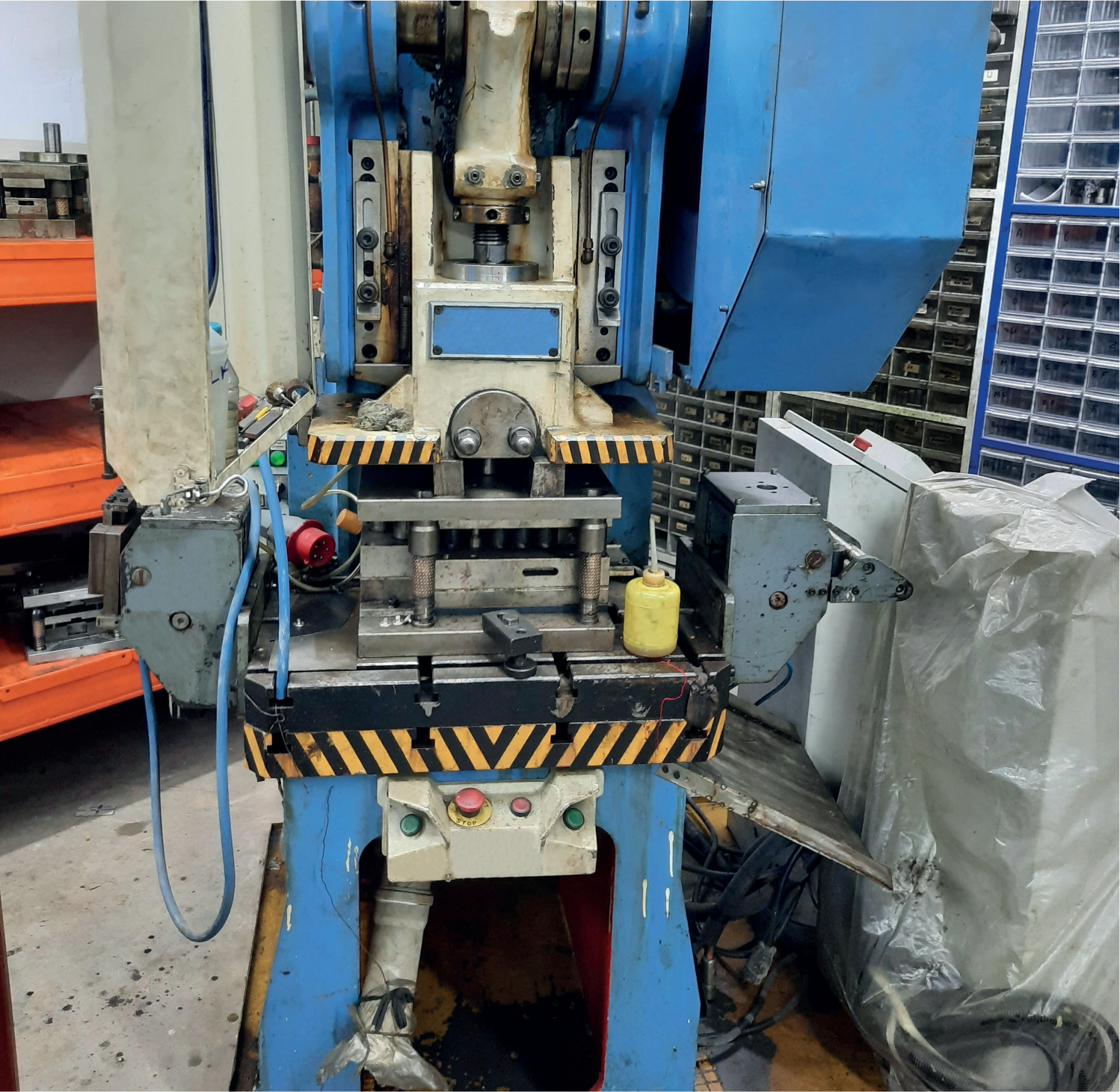
Görsel 8.54: Bükme kalıbının pres tezgâhına bağlanması
