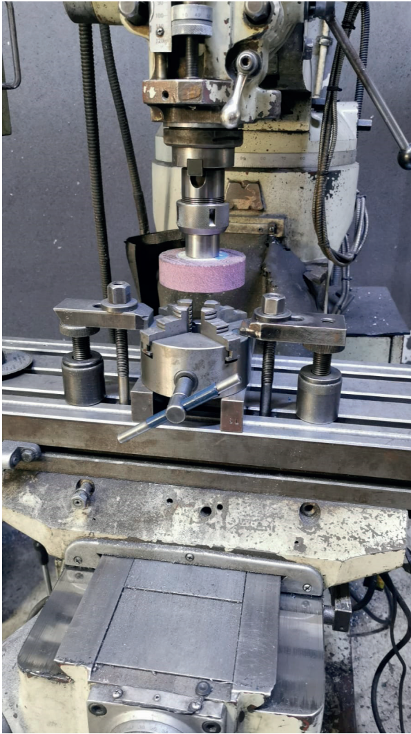
Görsel 7.4: Bağlama pabuçlarıyla işin tablaya bağlanması
