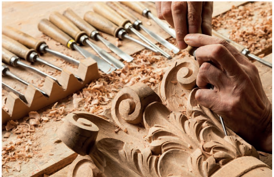
Görsel 2.5 Oyma yöntemi ile ahşap model hazırlanması
