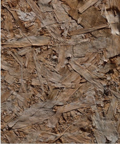
Görsel 5.4: Geri dönüştürülmüş ahşaplardan preslenerek elde edilmiş levha
