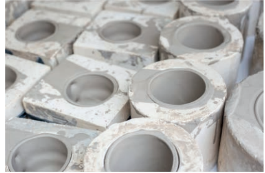
Görsel 2.11: Alçı kalıplara dökülmüş seramik parçalar
