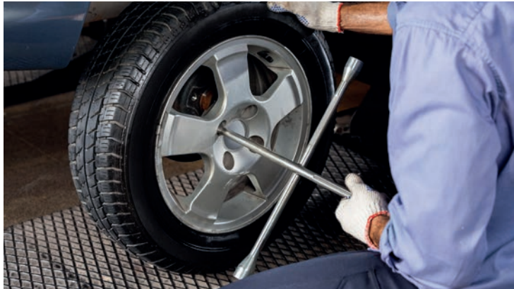
Görsel 3.17: Bijon anahtarı ile lastik değiştirme işlemi
