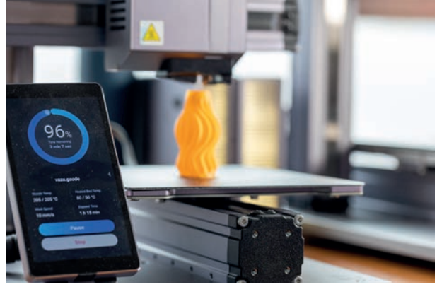
Görsel 9.3: Üç boyutlu yazıcı kalibrasyonu
