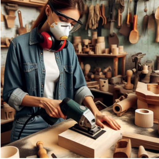
Görsel 5.20: Zımparalama işlemi ile şekillendirme
