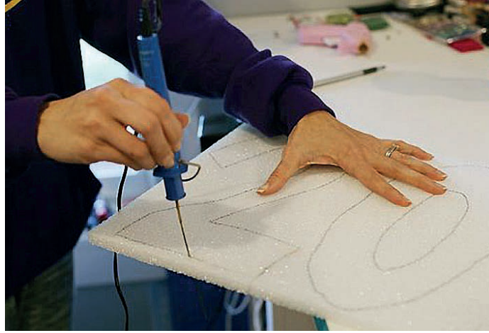
Görsel 7.13: Strafor üzerine ısı kalemi ile modelleme yapılması
