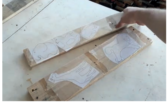
Görsel 5.14: Modelin ahşap üzerine aktarılması
