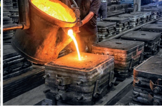
Görsel 2.10 : Kum kalıba metal döküm işlemi
