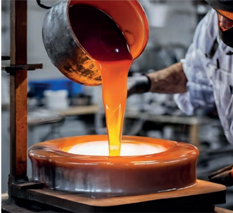
Görsel 1.19: Erimiş camın kalıba dökülmesi
