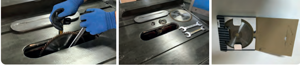
Görsel 2.28: Daire testere makine bıçaklarının sökülmesi
