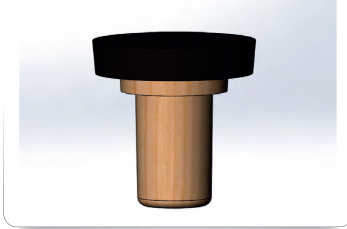
Görsel 5.37: Asma maça başı ilave edilmiş modelleme
