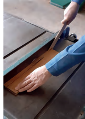
Görsel 2.29: İtme çubuğu ile kesim
