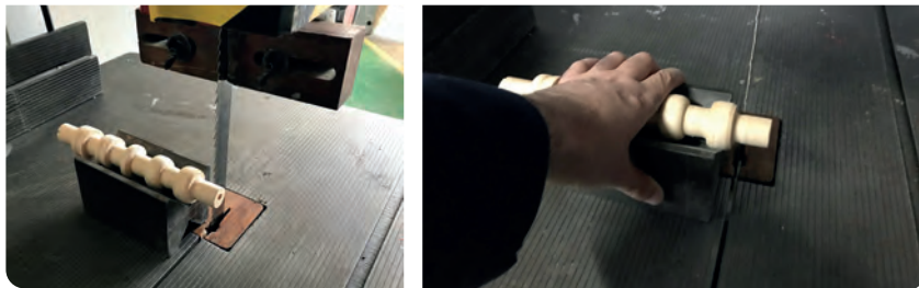
Görsel 2.9: V yatağı içinde kesim
