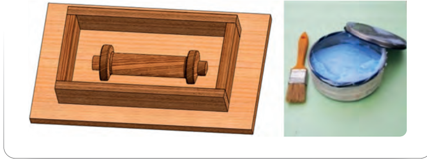
Görsel 3.36: Ana modellemeye ayırıcı sürülmesi
