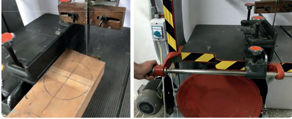
Görsel 2.4: Şerit testere siper kullanımı
