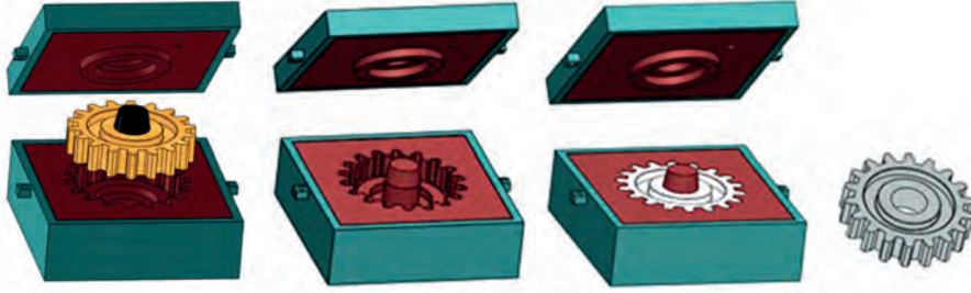
Görsel 1.2: Modellemenin kalıplanması
