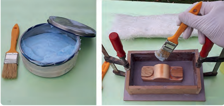
Görsel 3.21: Modellemeye ayırıcı sürülmesi
