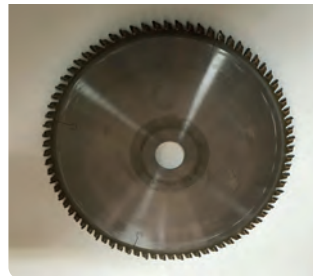
Görsel 2.25.b) Suni ahşap ürün kesim daire testeresi
