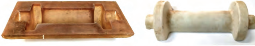
Görsel 3.46: Kompozit kalıp ve kompozit çalışma modellemesi
