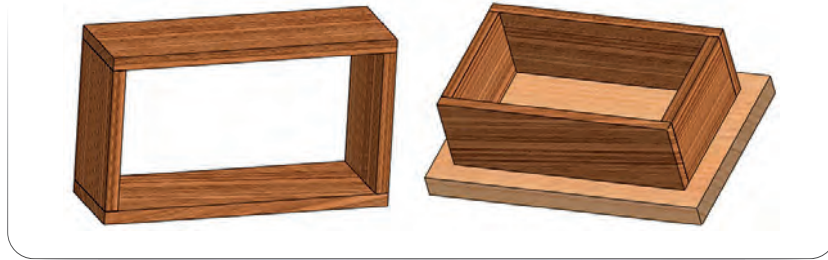
Görsel 3.16: Alt plaka ve kalıp çerçevesi
