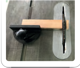
Görsel 2.23.a) Sürgülü gönye ile düz kesim
