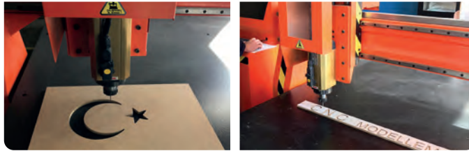
Görsel 2.58.b) 3 eksen CNC Router makinesinde çalışma örnekleri
