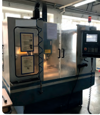
Görsel 2.52: 3 eksen CNC freze kısımları
