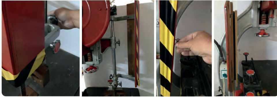
Görsel 2.5: Yan koruyucu kapakların açılması
