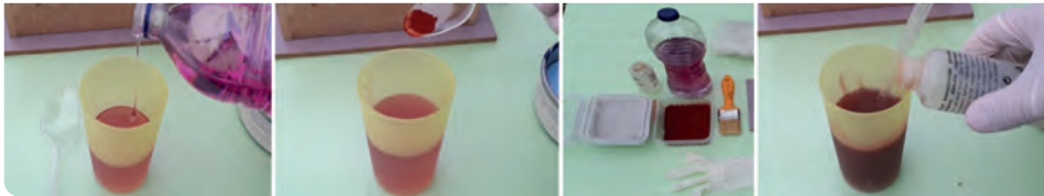
Görsel 3.37: Kompozit karışımın hazırlanması
