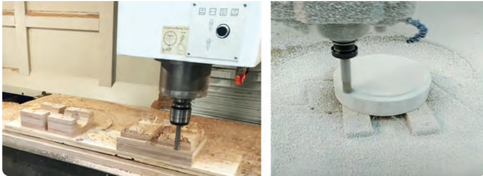
Görsel 1.4: CNC makineleri ile modelleme üretimi
