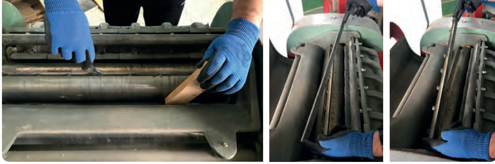
Görsel 2.19: Kalınlık makinesi bıçak sökme işlemi
