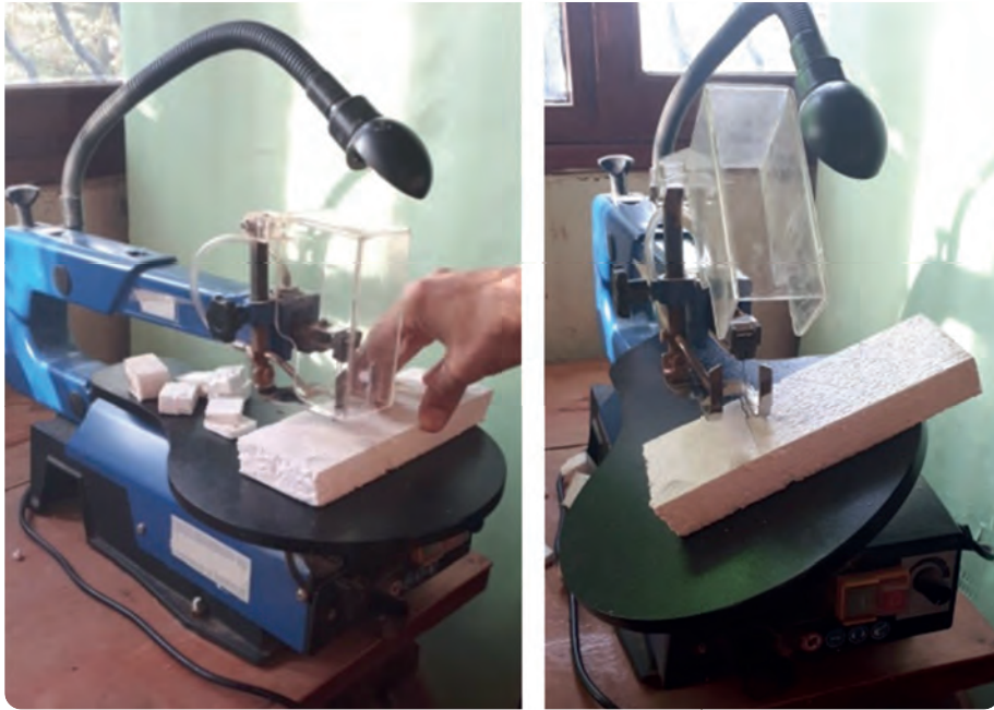
Görsel 3.48: Dekupaj makinesi ile düz ve açılı kesme
