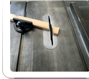
Görsel 2.23.b) Sürgülü gönye ile açılı kesim
