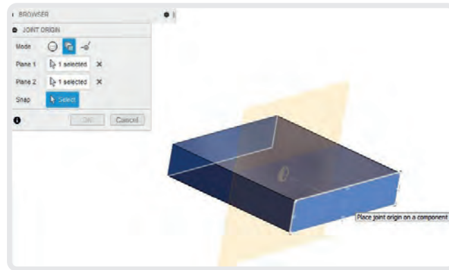
Görsel 3.10: Between two faces seçimi ile Joint Origin oluşturma işlemi
