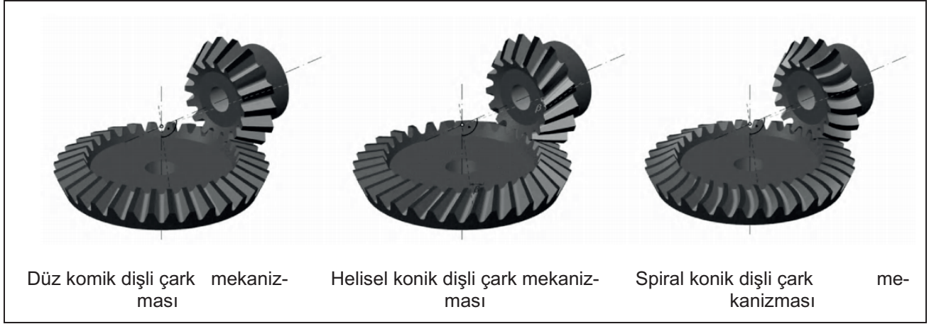
Görsel 3.25: Diş profiline göre konik dişliler
