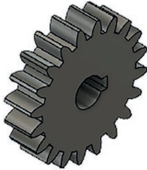
Modül: 2 Diş Sayısı: 20 Diş Genişliği: 10 mm Mil Çapı: 10 mm
