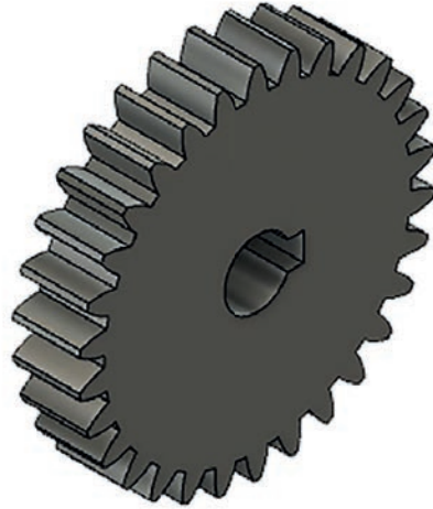
Modül: 2 Diş Sayısı: 30 Diş Genişliği: 12 mm Mil Çapı: 12 mm
