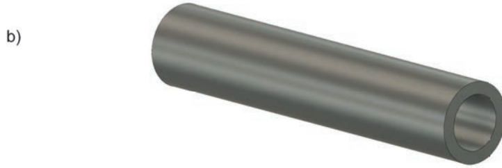
Çap 40 mm Delik çapı: 25 mm Uzunluk 200 mm
