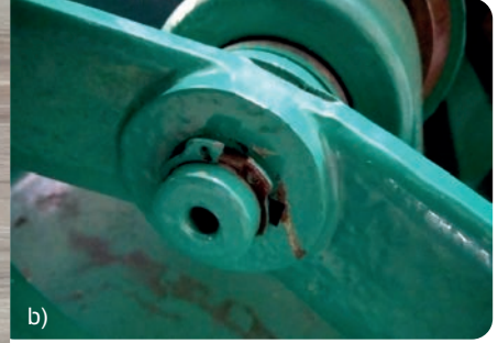
Görsel 1.111 Freze tezgâhi çevirme kolu ve bağlantısı
