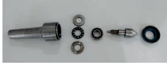
Görsel 2.128: Döner punta ve elemanları
