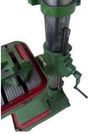
Görsel 2.1: Matkap tezgâhı hareket aktarma mekanizması
