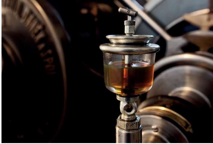
Görsel 2.113: Kapalı sistemde rulmanların yağlanması
