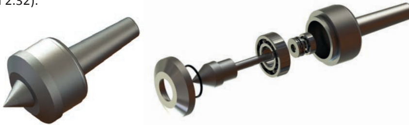
Görsel 2.32: Döner punta aparatında rulmanların kullanılması
