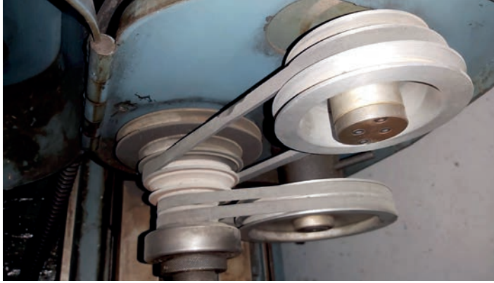
Görsel 2.60 Kasnağın mekanizmada kullanımı
