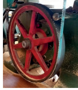
Görsel 2.63 Düz kasnağın mekanizmada kullanımı
