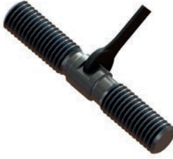
Görsel 1.35: Saplamanın anahtarla sökülüp takılması
