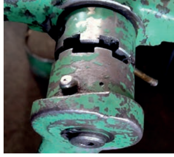
Görsel 1.75 Konik pimin mekanizmada kullanımı
