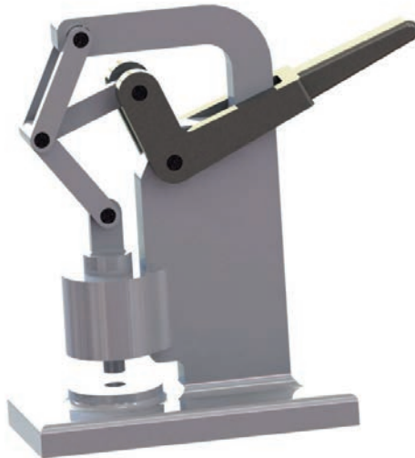
Görsel 1.71: Pimlerin mekanizmada kullanımı
