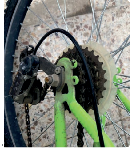
Görsel 2.91: Zincir dişlinin mekanizmada kullanımı
