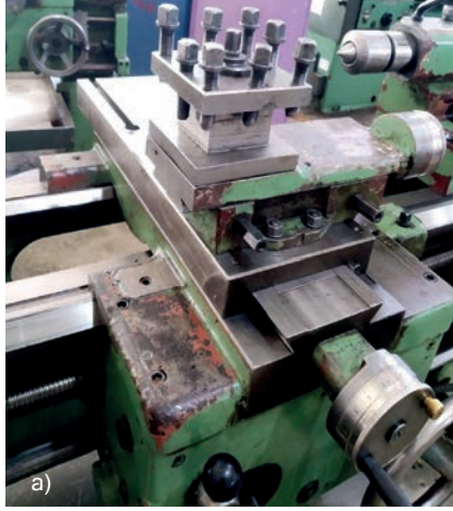
Görsel 1.67: Torna tezgâhı kalemlik mekanizması
