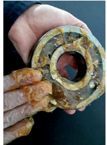
Görsel 2.114: Rulmanların elle yağlanması
