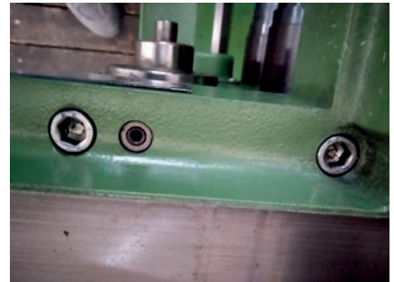
Görsel 1.21: Silindirik başlı civata bağlantısı
