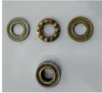
Görsel 2.129: Rulmanlı yatakların gresle yağlanması
