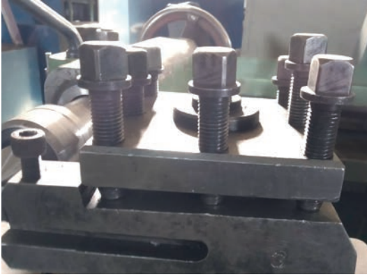
Görsel 1.8: Bağlama vidasının mekanizmada kullanımı
