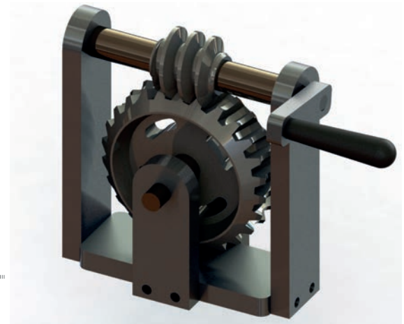
Görsel 2.89: Sonsuz vida ve karşılık dişlisi mekanizması
