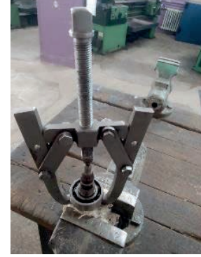
Görsel 2.47: Çektirme kullanarak rulman sökümü
