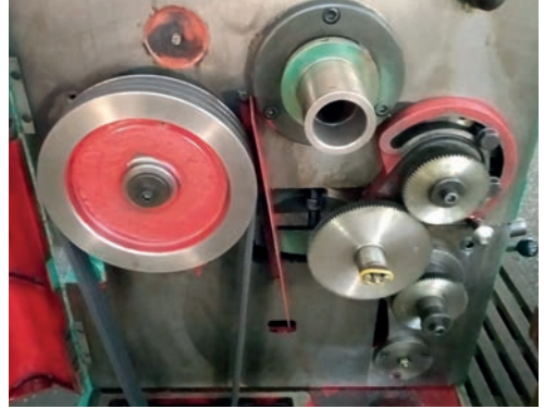
Görsel 2.2 Torna tezgâhı hareket aktarma mekanizması
