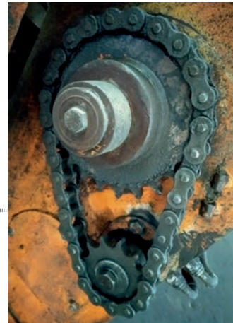
Görsel 2.93: Yük zincirinin mekanizmada kullanımı
