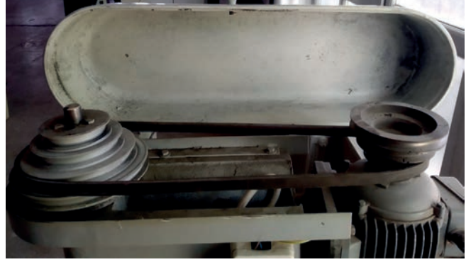
Görsel 2.80: Matkap tezgâhında kayış kasnak sistemi
