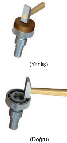
Görsel 2.48: Rulmanların takılması
