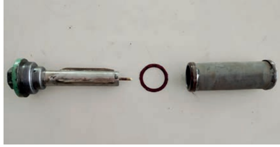
Görsel 2.127: Temizlenmiş yağ süzgeci
