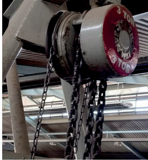
Görsel 2.93: Yük zincirinin mekanizmada kullanımı
