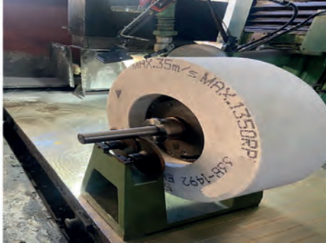
Görsel 3.12: Dengeleme aparatı ve dengeleme işleminin yapılışı
