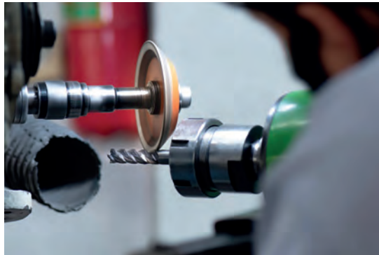
Görsel 3.32: İş parçasının penslere bağlanarak taşlanması
