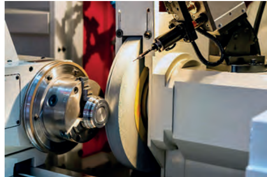
Görsel 3.31: İş parçasının aynaya bağlanarak taşlanması
