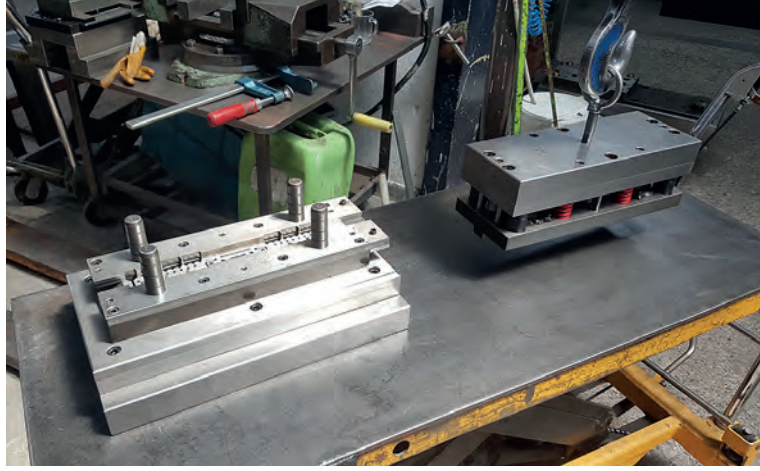
Görsel 1.16: Ağır iş parçalarının yüklenmesi
