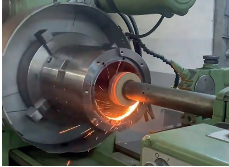
Görsel 3.38: Silindirik iç yüzey taşlama işlemi
