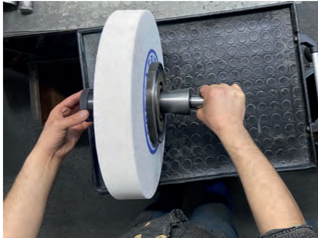
Görsel 3.15: Montajın tamamlanması
