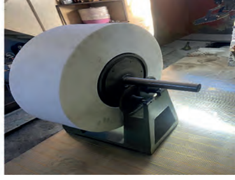
Görsel 3.12: Dengeleme aparatı ve dengeleme işleminin yapılışı
