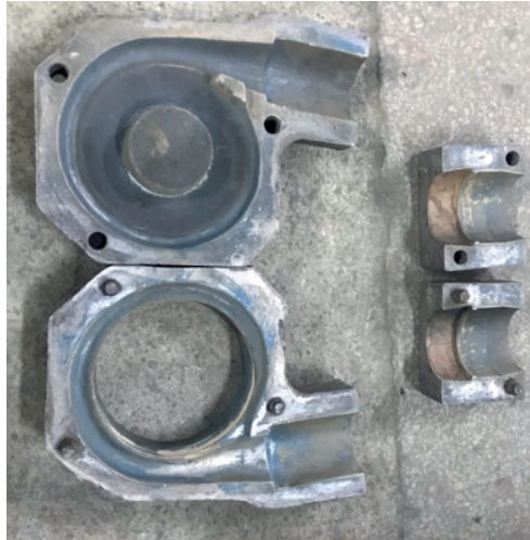
Görsel 1.8: Maçaları oluşturan alüminyum kalıp
