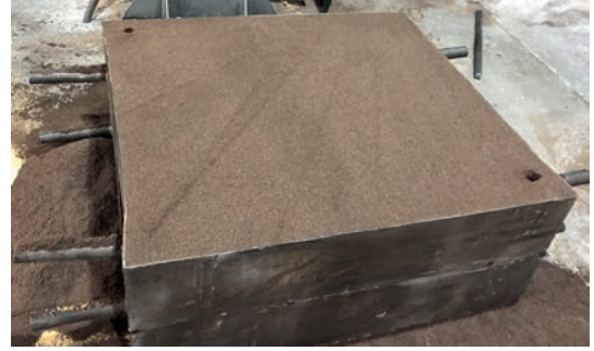
Görsel 1.6: Model yerleştirilmiş kum kalıp
