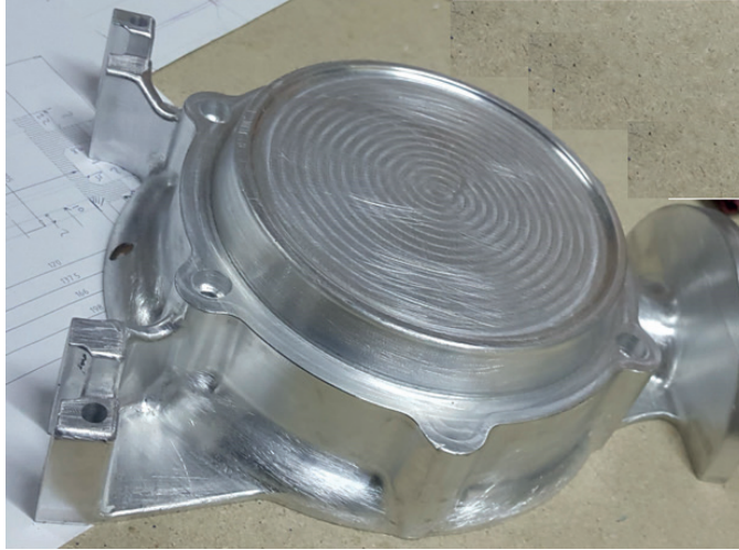
Görsel 1.4: Alüminyumdan oluşturulan model
