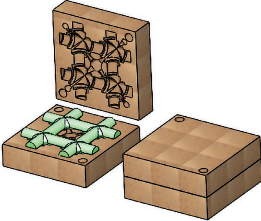
Görsel 1.49: Açık ve kapalı kum kalıbı
