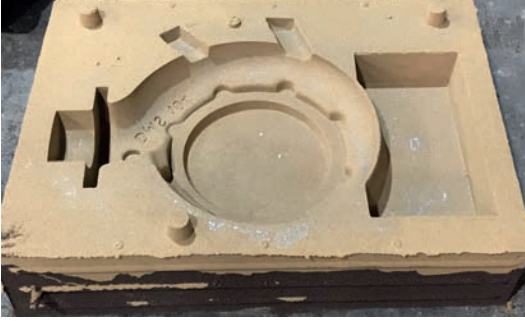
Görsel 1.5: Döküm boşlukları oluşturulan kum kalıp
