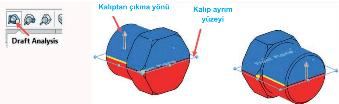
Görsel 1.11: Kalıptan çıkma açısı verilmemiş.
