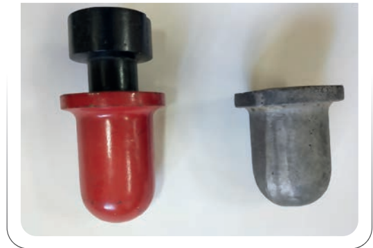
Görsel 1.44: Selülozik boya uygulanmış modelleme ve üretim parçası
