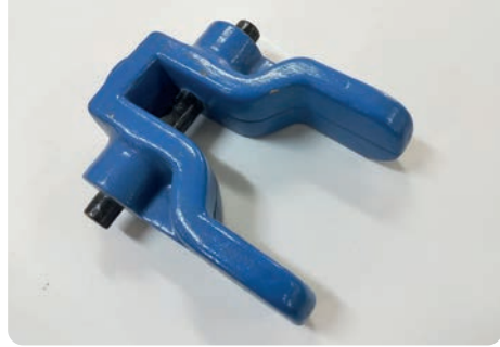
Görsel 1.45: Sentetik boya uygulanmış modelleme
