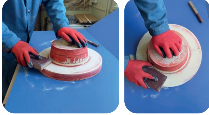
Görsel 1.37: Üst yüzeyleri zımparalama
