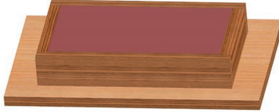
Görsel 2.17: Kompozit karışımın doldurulması
