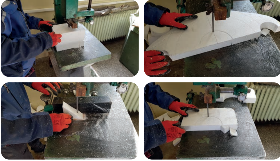
Görsel 4.27: Markalanan parçaların şerit testere makinesinde kesimi
