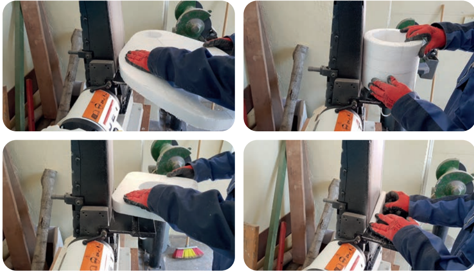
Görsel 4.28: Zımpara makinesinde çalışma
