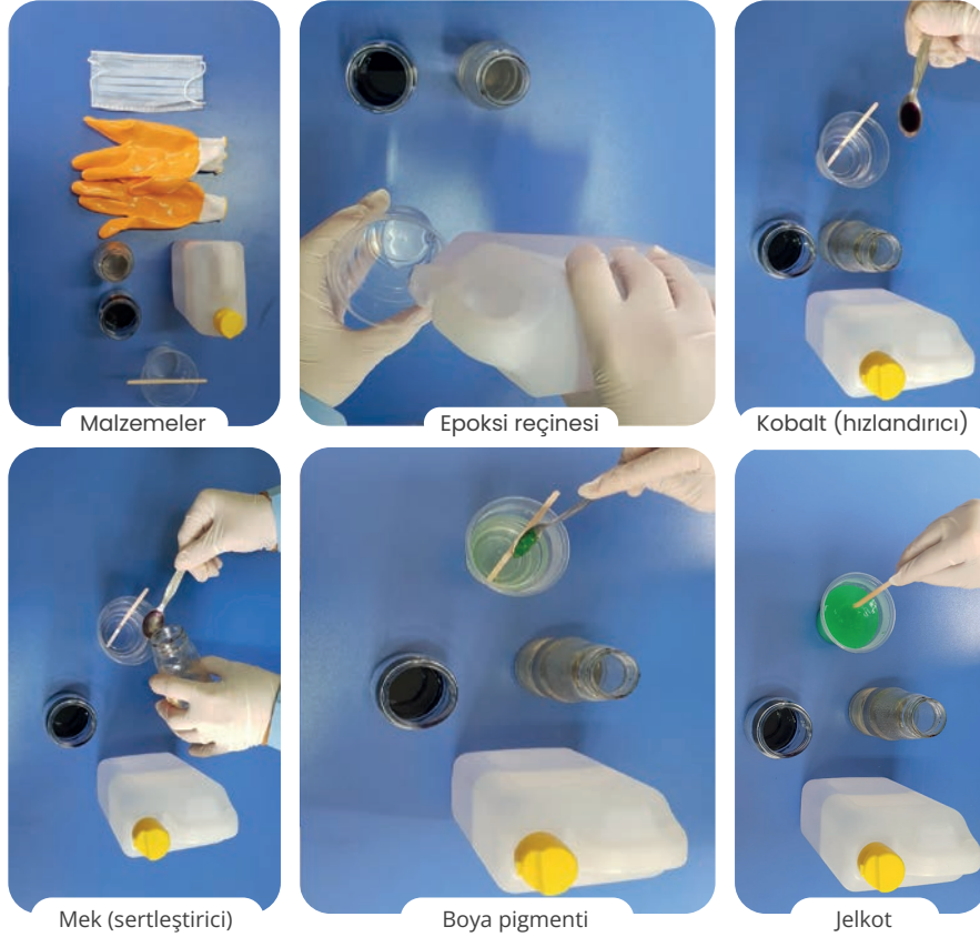
Görsel 3.16: Epoksi karışımının hazırlanması
