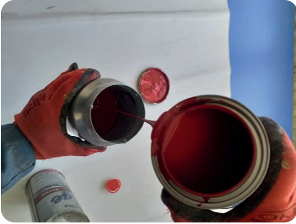
Görsel 1.61: Boya tabancasının hazırlanması
