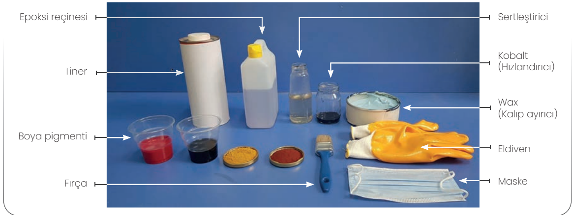
Görsel 3.3: Epoksi karışımda kullanılan malzemeler
