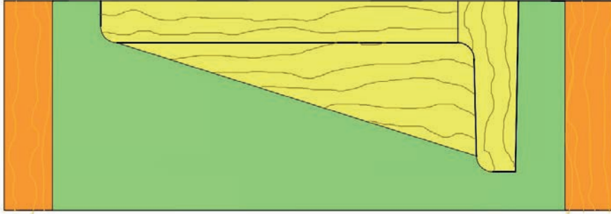
Görsel 3.19: Plakanın çıkartılması ve kesit görünümü
