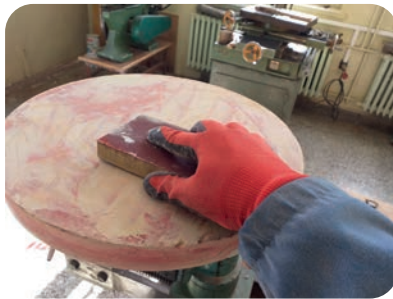
Görsel 1.39: Ahşap el takozu ile zımparalama
