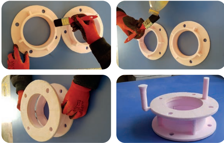
Görsel 4.59 : Model parçalarının birleştirilmesi
