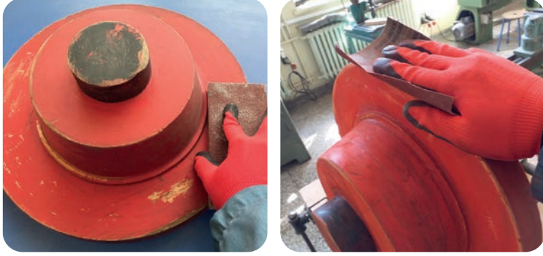
Görsel 1.15: Modellemeyi zımparalama
