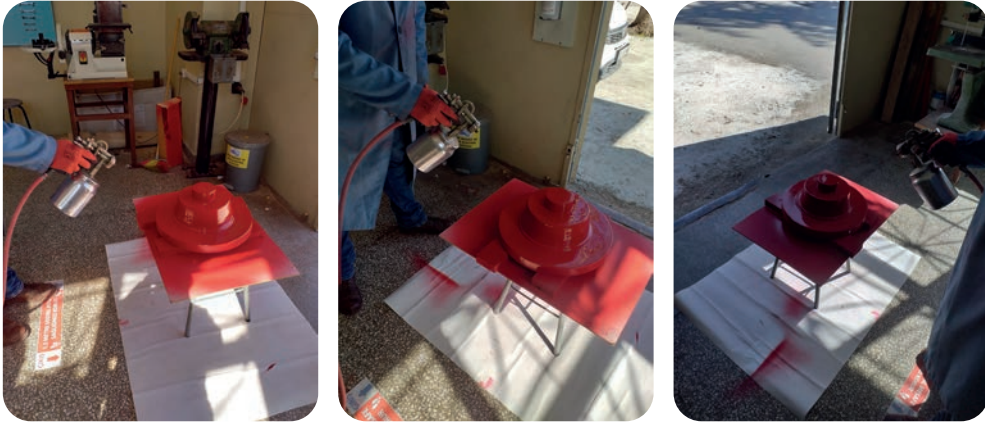
Görsel 1.64: Modellemeye ikinci kat boya uygulaması
