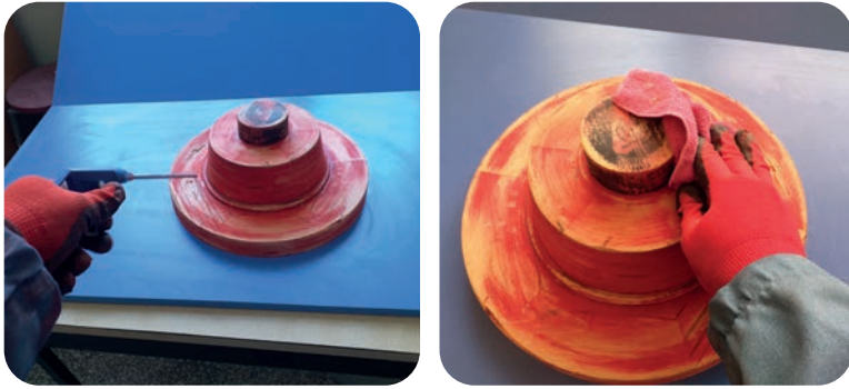
Görsel 1.16: Modellemeyi temizleme
