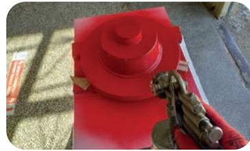
Görsel 1.62: Modellemeye birinci kat boya uygulaması
