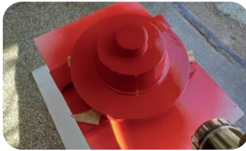
Görsel 1.62: Modellemeye birinci kat boya uygulaması
