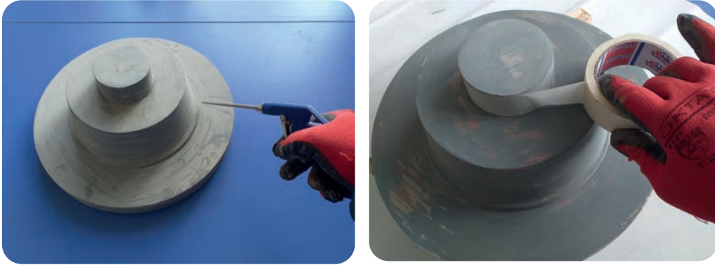
Görsel 1.58: Modelleme temizliđi ve maça başının bantlanması
