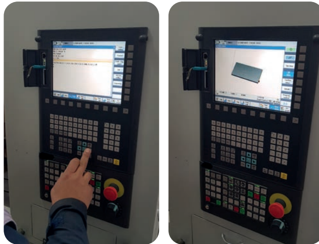
Görsel 4.53 : Tezgâh paneline programın aktarılması.
