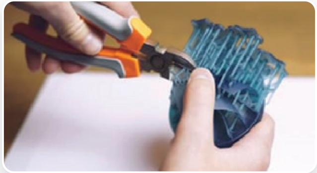
Görsel 1.35: Destek yapısının kargaburun ile temizlenmesi
