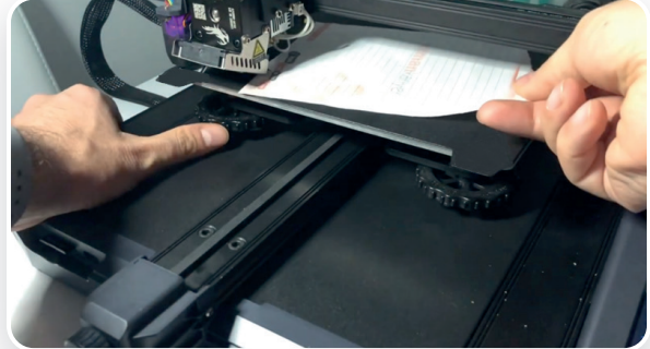
Görsel 1.26: Baskı kafası ile tabla arasına kâğıt yerleştirilmesi
