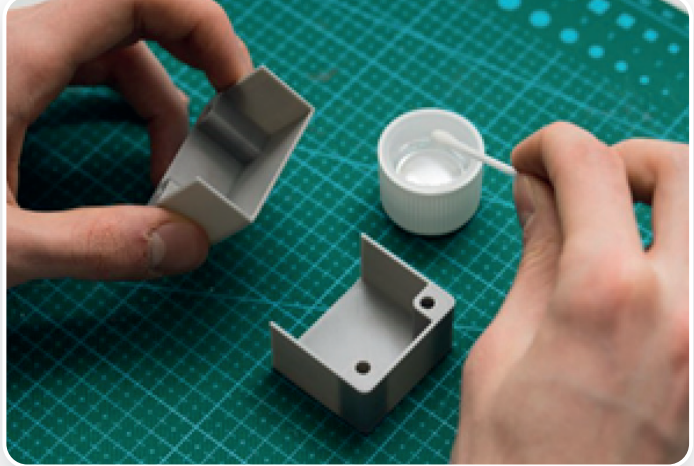
Görsel 1.37: Aseton ile soğuk kaynak
