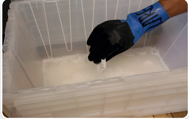
Görsel 1.34: Çözünür destek malzemesi temizleme banyosu
