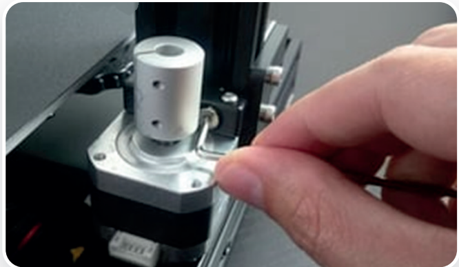
Görsel 1.24: 3B Yazıcının vidalarını sıkma
