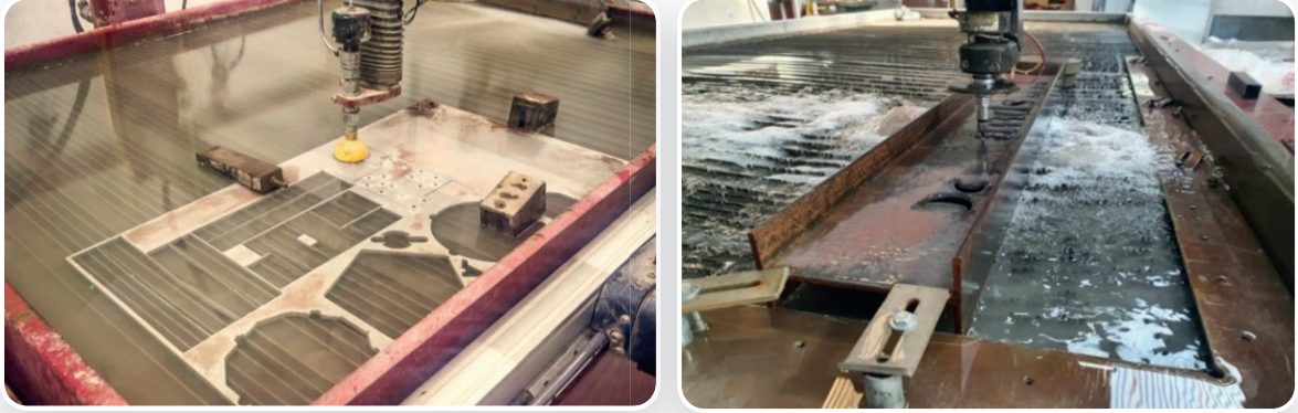
Görsel 4.9: İş parçasının tablaya bağlanması
