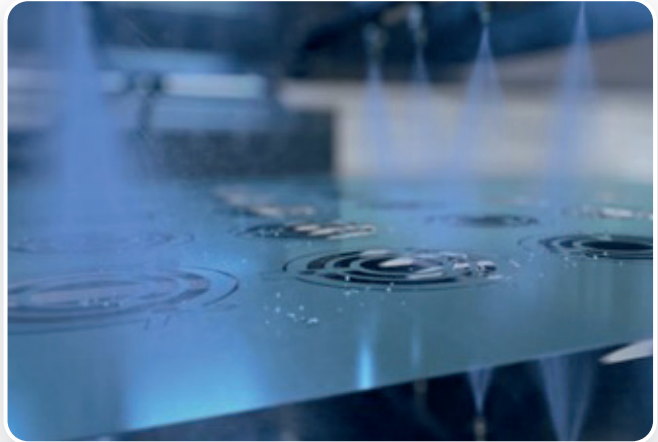
Görsel 4.23: Maskenin püskürtme yöntemi ile kaplanması
