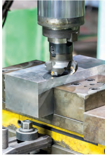
Görsel 1.60: Tabla üzerinde mengene ve ayna bağlanması
