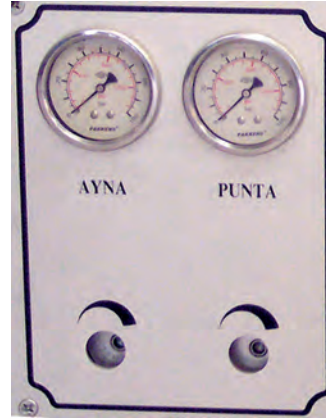
Görsel 1.20: Ayna ve punta basınç ayar valfi
