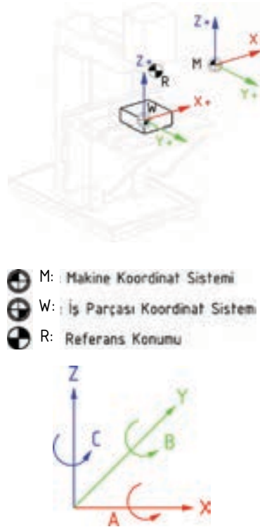
Şekil 7.1: Dik CNC freze tezgâhında referans noktaları ve eksenler
