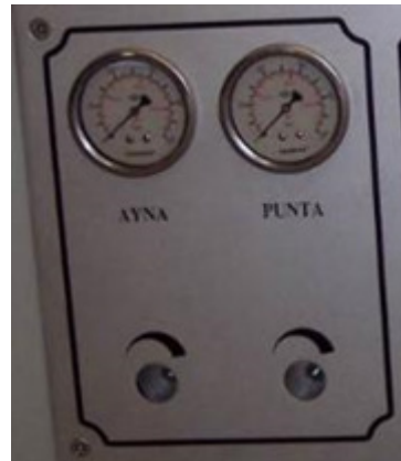
Görsel 1.19: Ayna ve punta basınç ayar valfi
