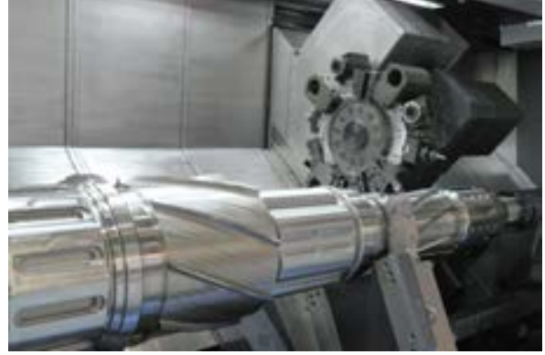
Görsel 1.8: Ağır iş parçalarının gezer yataklar ile desteklenmesi
