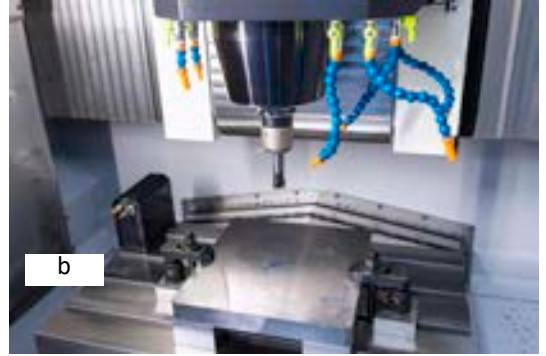
Görsel 6.24: Bağlama pabuçları yardımı ile tablaya iş parçasının bağlanması
