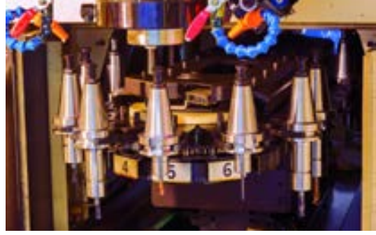
Görsel 6.3: CNC freze tezgâhı magazini
