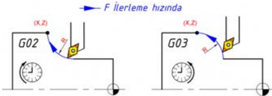
Şekil 2.9: G02 ve G03 komutunun 1. kullanım şekli
