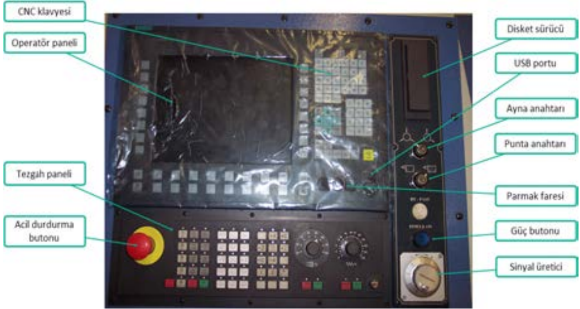
Görsel 1.15: CNC kontrol paneli üzerinde bulunan kısımlar
