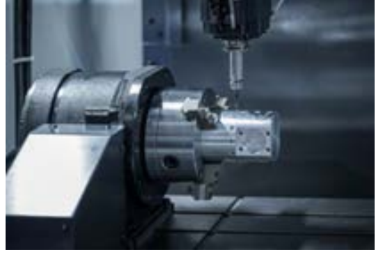
Görsel 6.27: Elektronik divizörler ile iş parçasının işlenmesi
