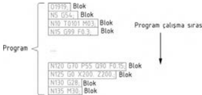
Şekil 2.4: CNC program yapısı
