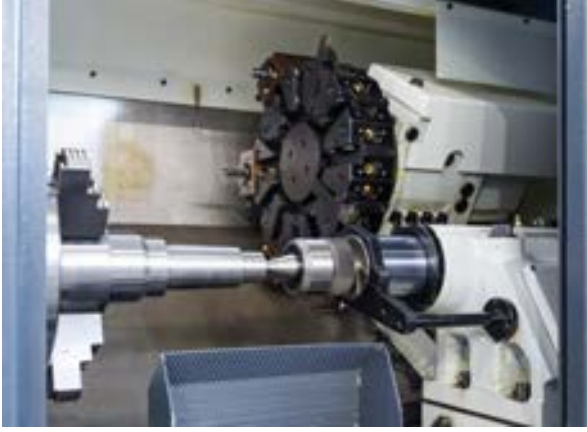
Görsel 1.5: Gezer punta ile iş parçalarının desteklenmesi
