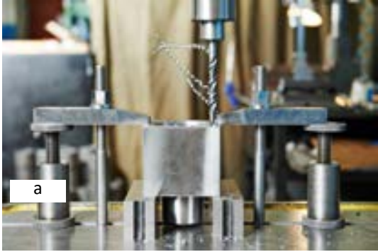
Görsel 6.24: Bağlama pabuçları yardımı ile tablaya iş parçasının bağlanması
