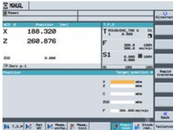
Görsel 1.29: “Position” ile takım referans noktasının kontrolü
