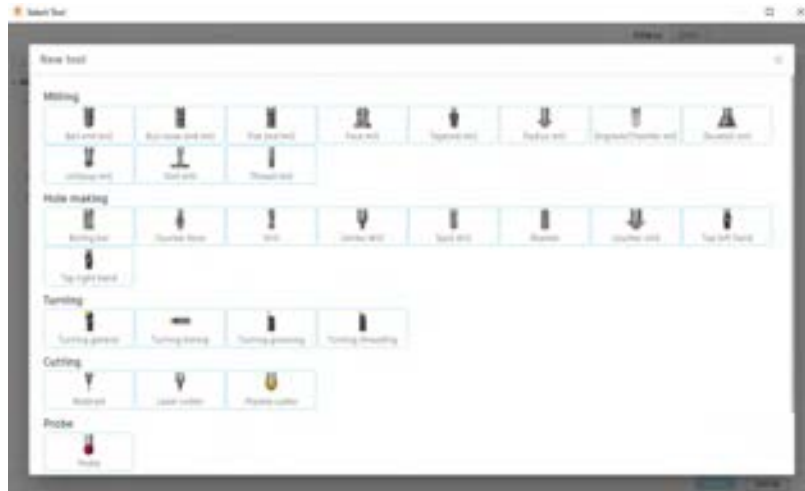
Görsel 13.6: CAM freze kesici takım tipini belirleme
