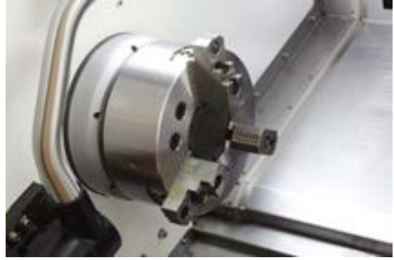
Görsel 1.3: İş mili üzerine bağlanmış CNC torna aynası
