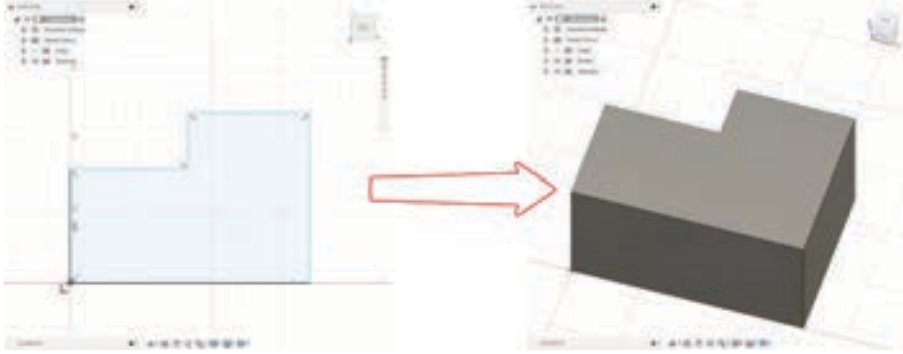
Görsel 11.6: İki boyutlu çizimden üç boyutlu model oluşturma
