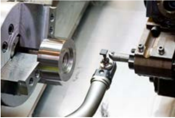
Görsel 1.6: CNC torna tezgâhında takım sıfırlama probu
