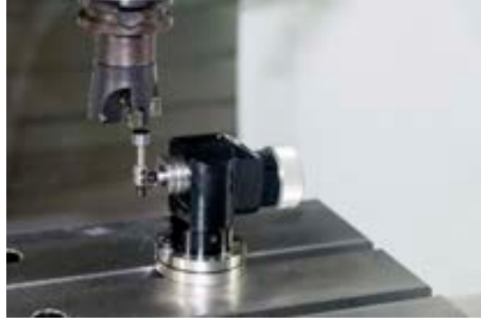
Görsel 6.6: CNC freze tezgâhında takım sıfırlama probu
