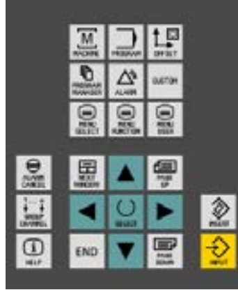
Görsel 1.16: CNC klavyesi üzerinde bulunan kontrol butonları
