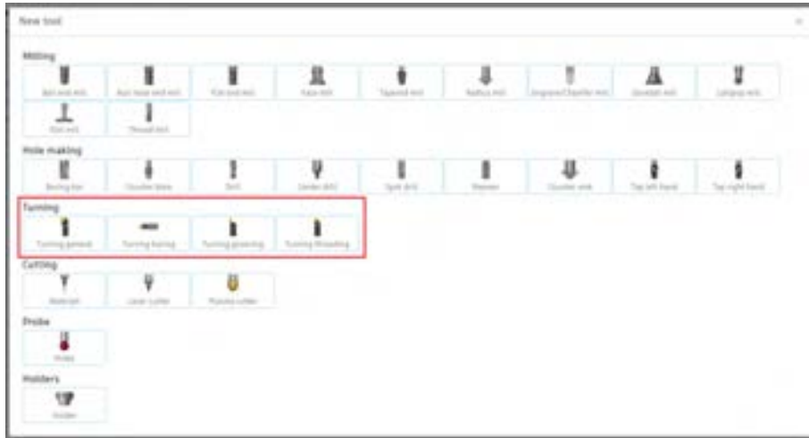
Görsel 12.6: CAM torna kesici takım tipini belirleme
