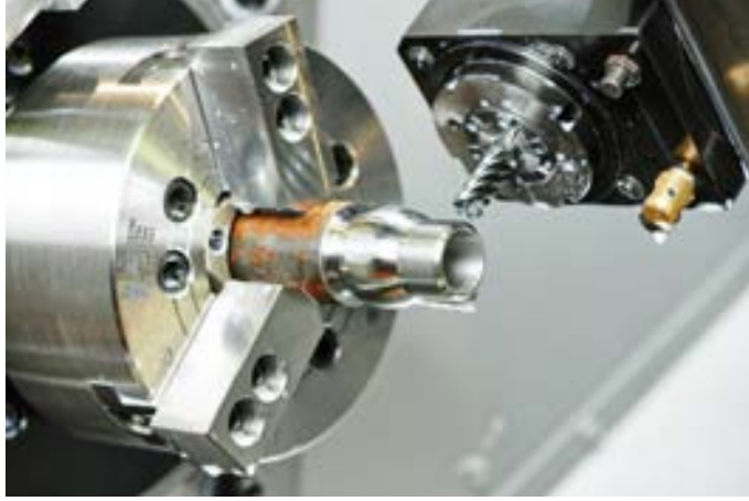
Görsel 12.22: C eksen CAM torna uygulaması
