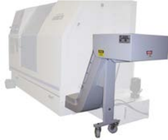
Görsel 1.12: CNC torna tezgâhı talaş konveyörü
