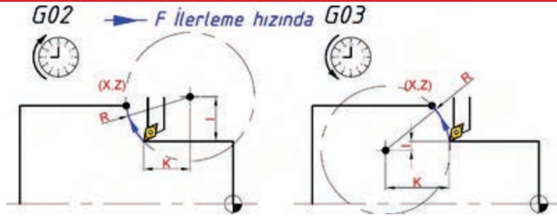
Şekil 2.10: G02 ve G03 komutunun 2. kullanım şekli
