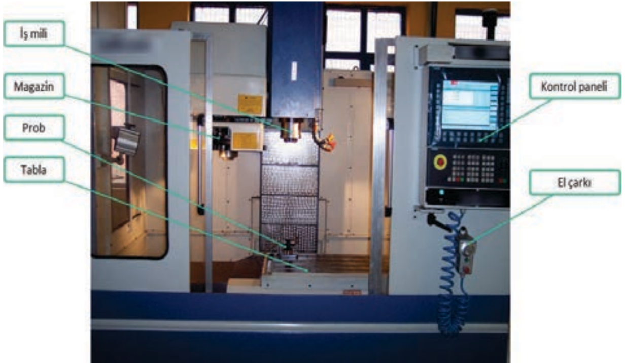
Görsel 6.1: CNC freze tezgâhının kısımları
