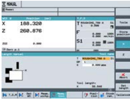
Görsel 1.27 : “Meas. Tool” ile Z ekseninde referans noktasının belirlenmesi
