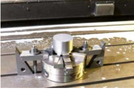
Görsel 6.26: Silindirik iş parçalarının CNC frezede ayna ile bağlanması
