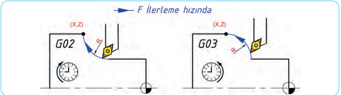
Şekil 2.21: G02 ve G03 komutunun 1. kullanım şekli
