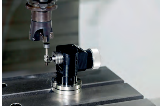
Görsel 5.6: CNC freze tezgâhında takım sıfırlama probu
