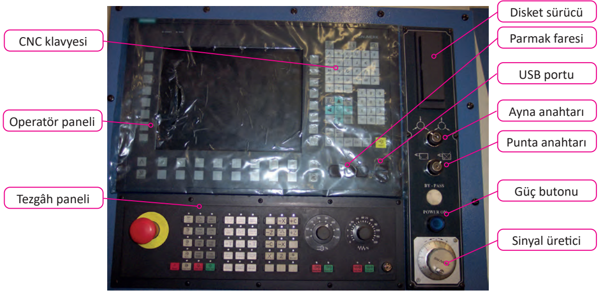
Görsel 1.15: CNC kontrol paneli üzerinde bulunan kısımlar
