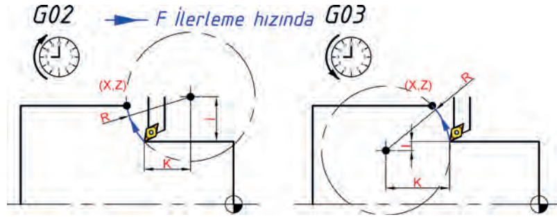
Şekil 2.24: G02 ve G03 komutunun 2. kullanım şekli
