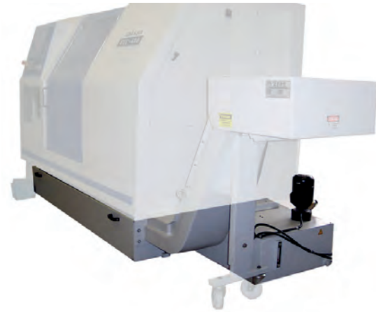
Görsel 1.13: CNC torna tezgâhı soğutma sistemi
