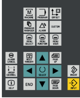
Görsel 1.16: CNC klavyesi üzerinde bulunan kontrol butonları
