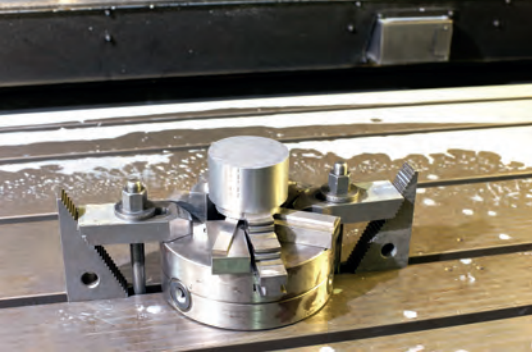
Görsel 5.27: Silindirik iş parçalarının CNC frezede ayna ile bağlanması
