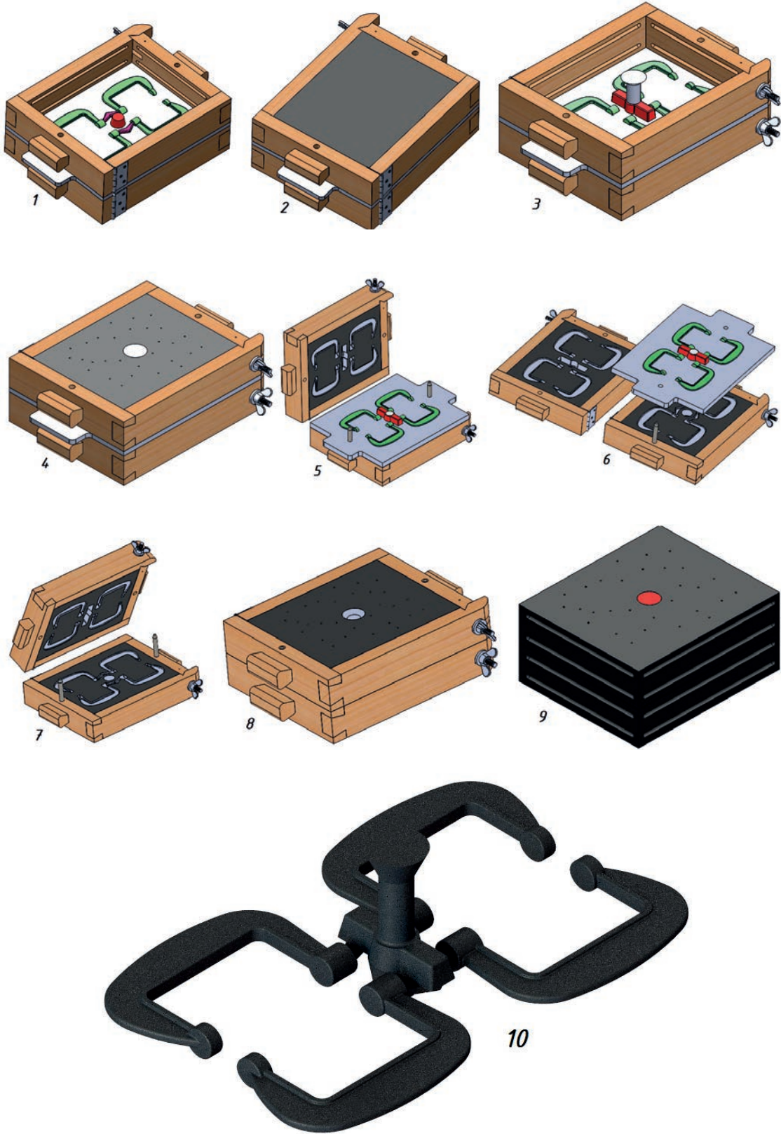
Görsel 4.17: Plak modeli kumda kalıplama işlem basamakları
