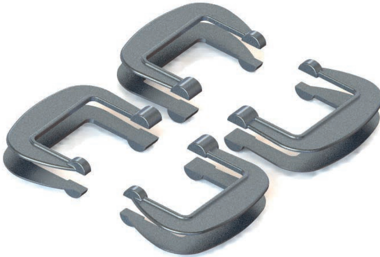
Görsel 9.10: Ana modellemeden yararlanılarak döküm sonrası plak modele bağlanacak çalışma modelleri (iş modelleri).
