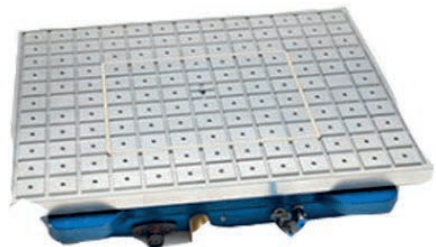
Görsel 1.46: Vakum tablası ile bağlama
