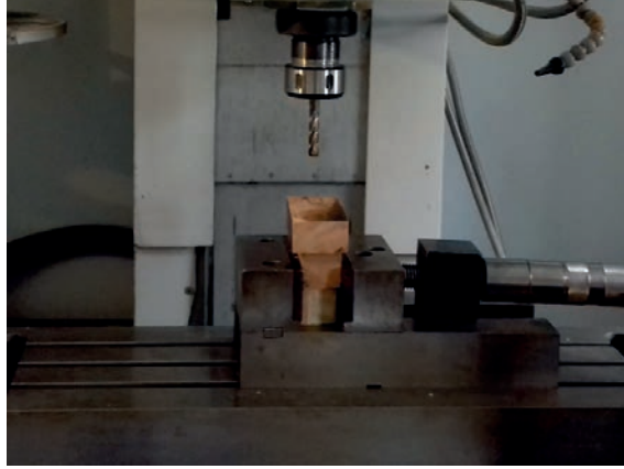
Görsel 1.57: İş parçasını tezgâha bağlama
