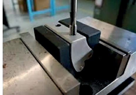
Görsel 1.45: Özel bağlama kalıpları ile bağlama
