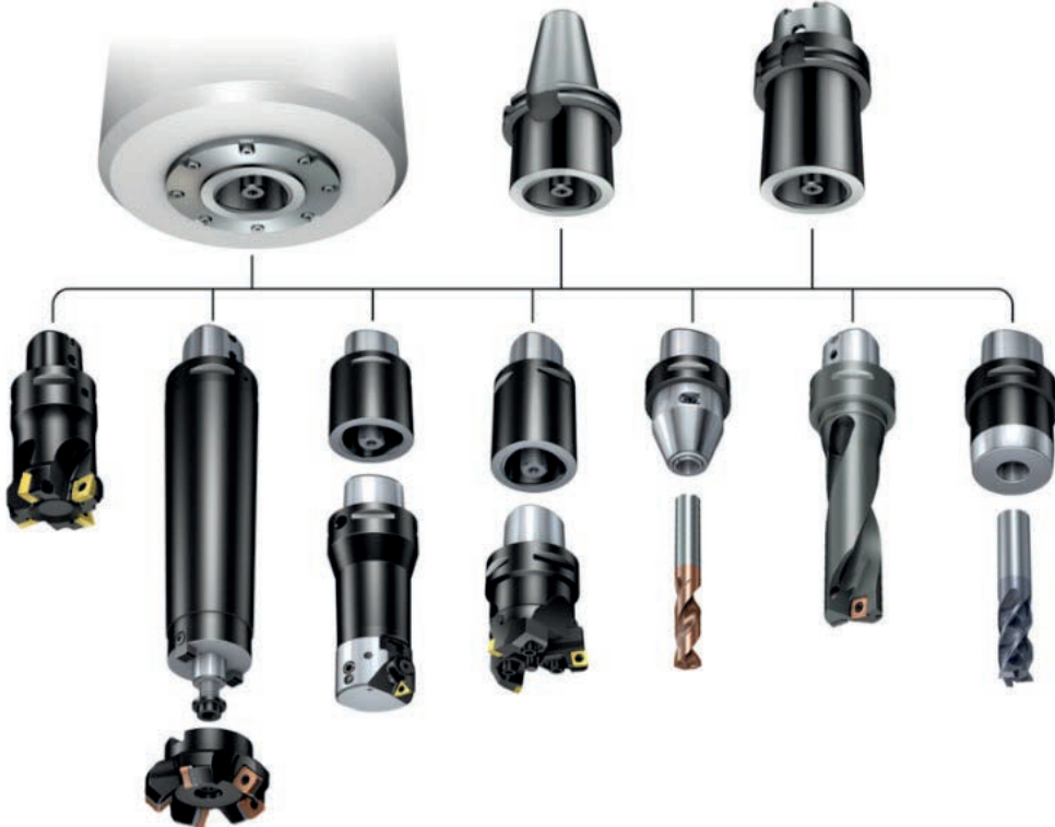
Görsel 1.50: Kesici takımların bağlanması
