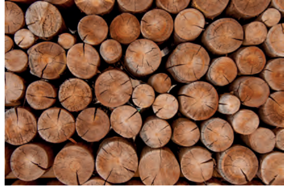
Görsel 7.3: Dış çatlak olan ağaç
