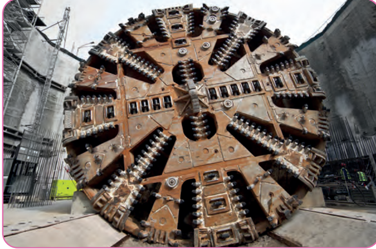
Görsel 3.15: Tünelleri açma makinesinin önden görünüşü
